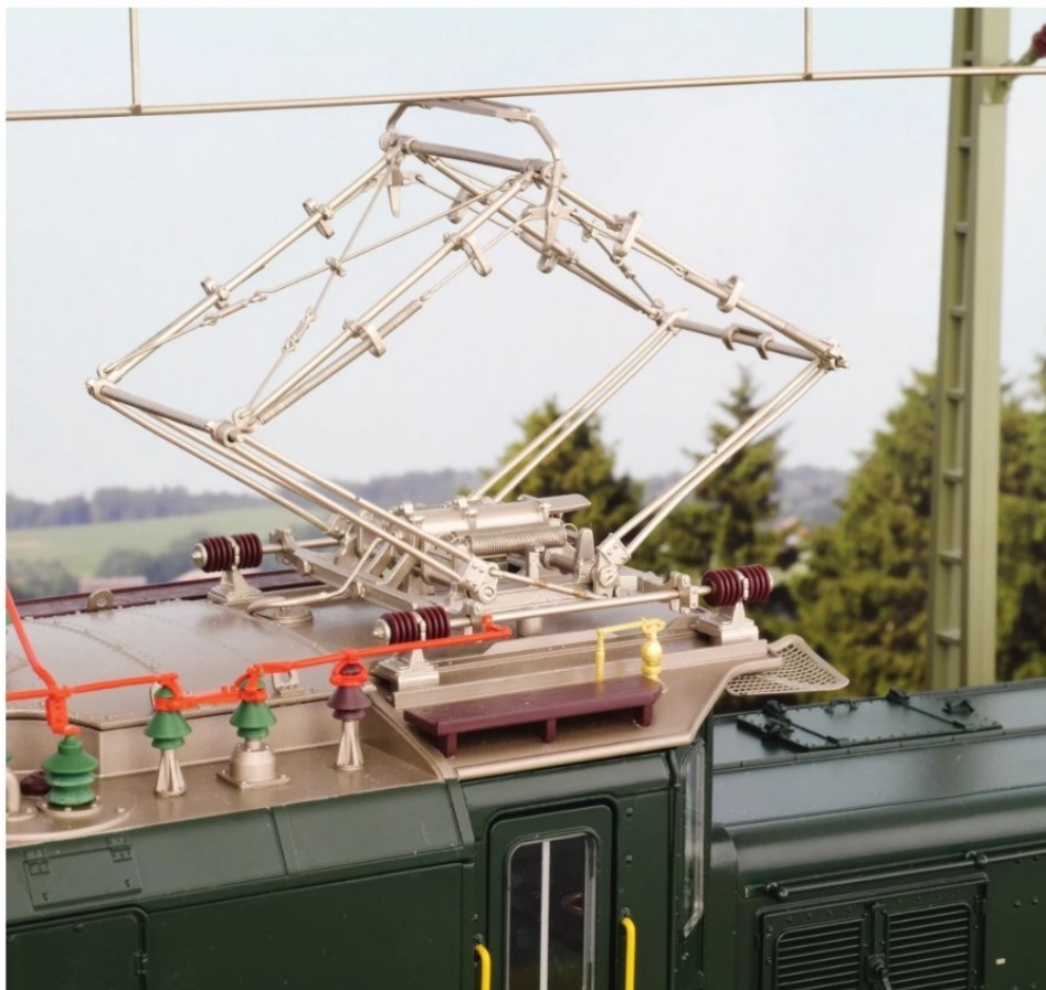
Die beiden aufwendig filigran konstruierten Pantographen lassen sich mithilfe von Servomotoren und Linearantrieb elektrisch heben und absenken.
