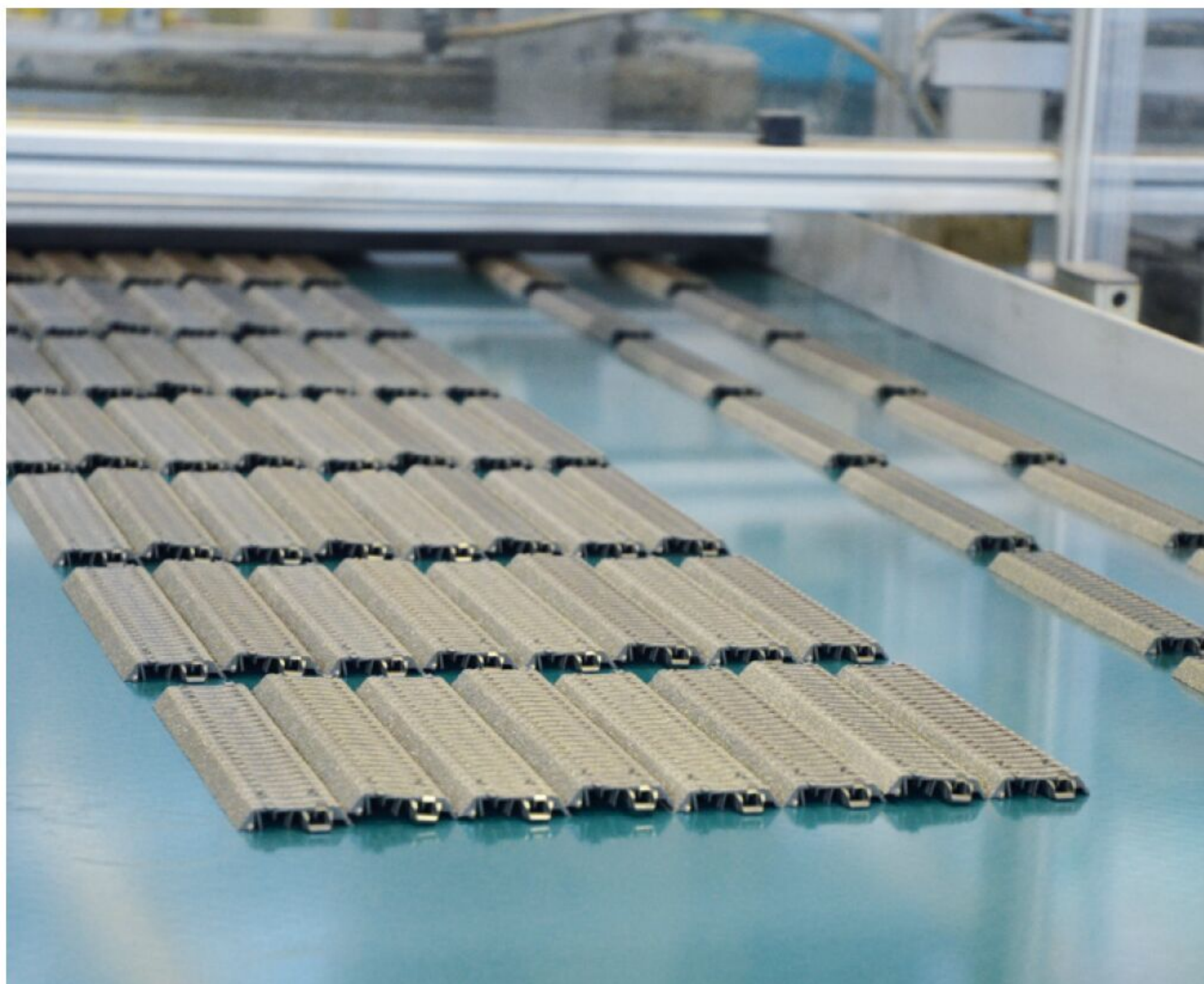
C-Gleis vom Band: Zunächst wird ASA-Kunststoffgranulat erhitzt und in einer Gussform zur Gleisbettung gepresst.
