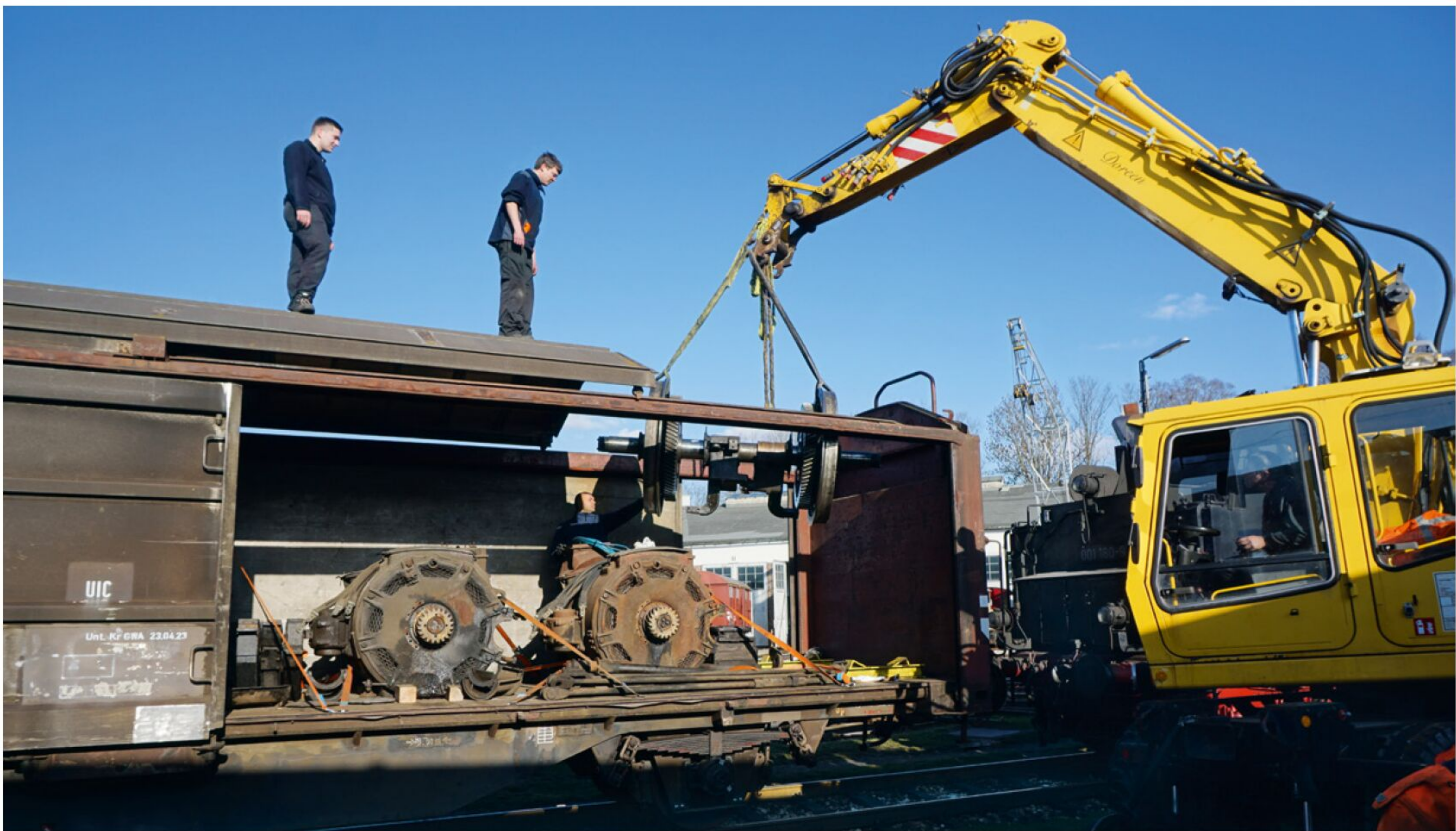
Alltagsarbeit im Nördlinger Bw: Für eine der E 94er des BEM wird aus dem Schiebedach/Schiebewand-Wagen eine überarbeitete Treibachse entladen. Die beiden Fahrmotoren sind als nächstes dran.
