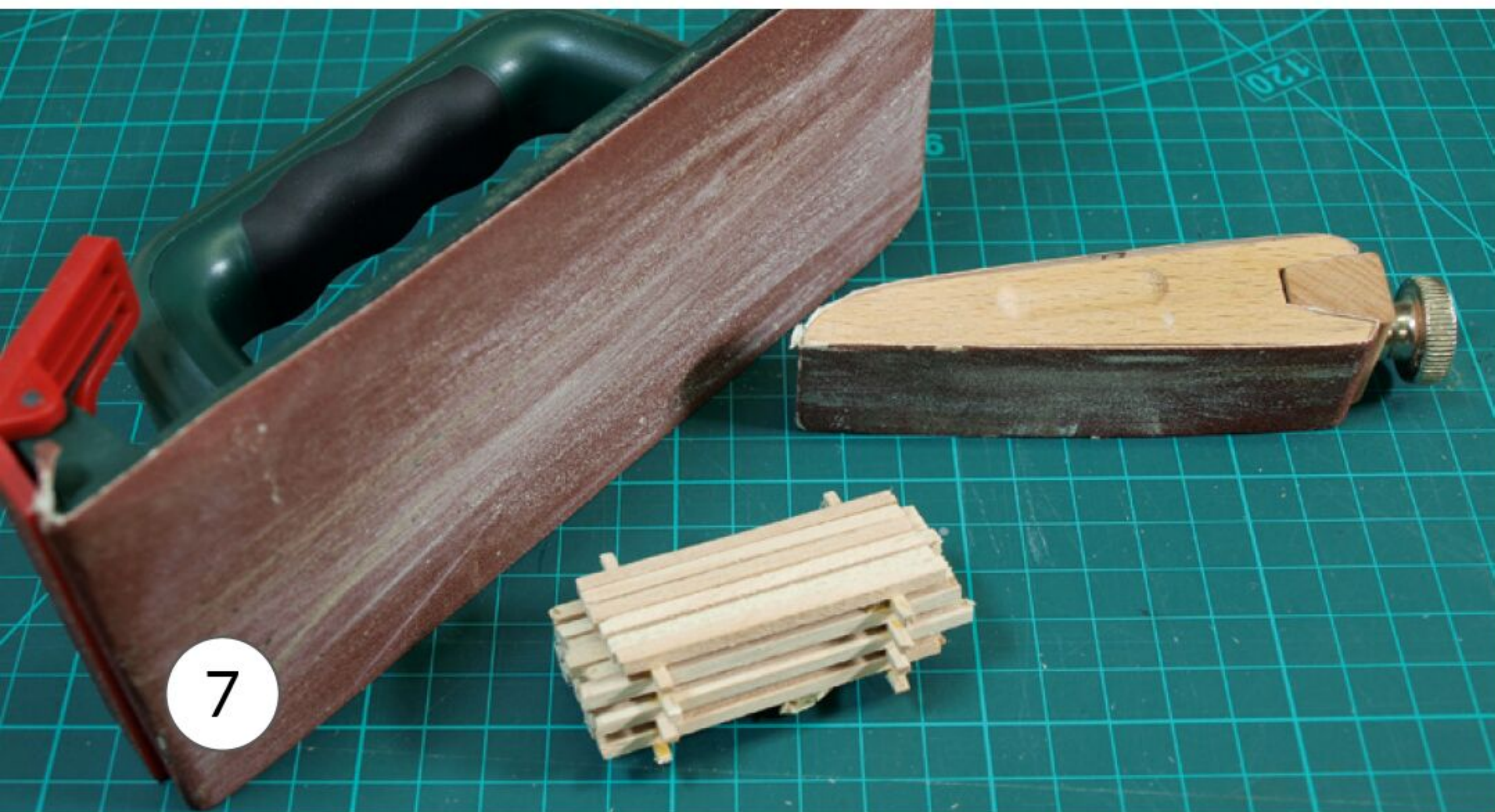
Nun nehmen wir mit einem Schleifblock überstehende Holzsplitter ab und bringen die Ränder in Form.
