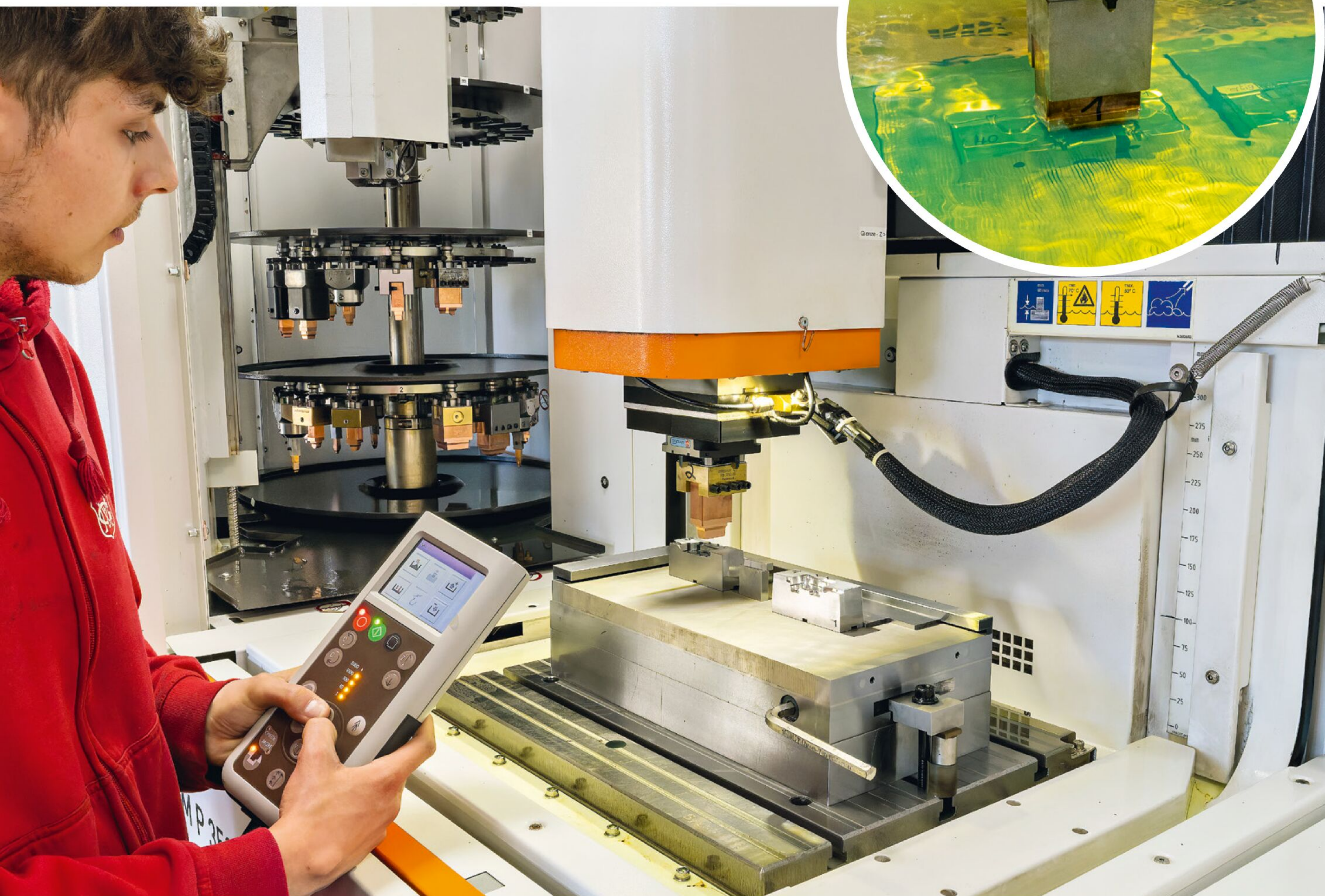
Senkerodiermaschine: Bediener Arjan Rukiqi bereitet die Funkenerosion vor. Die formgebende Kupferelektrode und der Stahl sind unterschiedlich gepolt – die Elektrode senkt sich mit bis zu 10.000 Grad Celsius heißen Funken in das Werkstück (oben) und trägt Material mit höchster Präzision ab.
