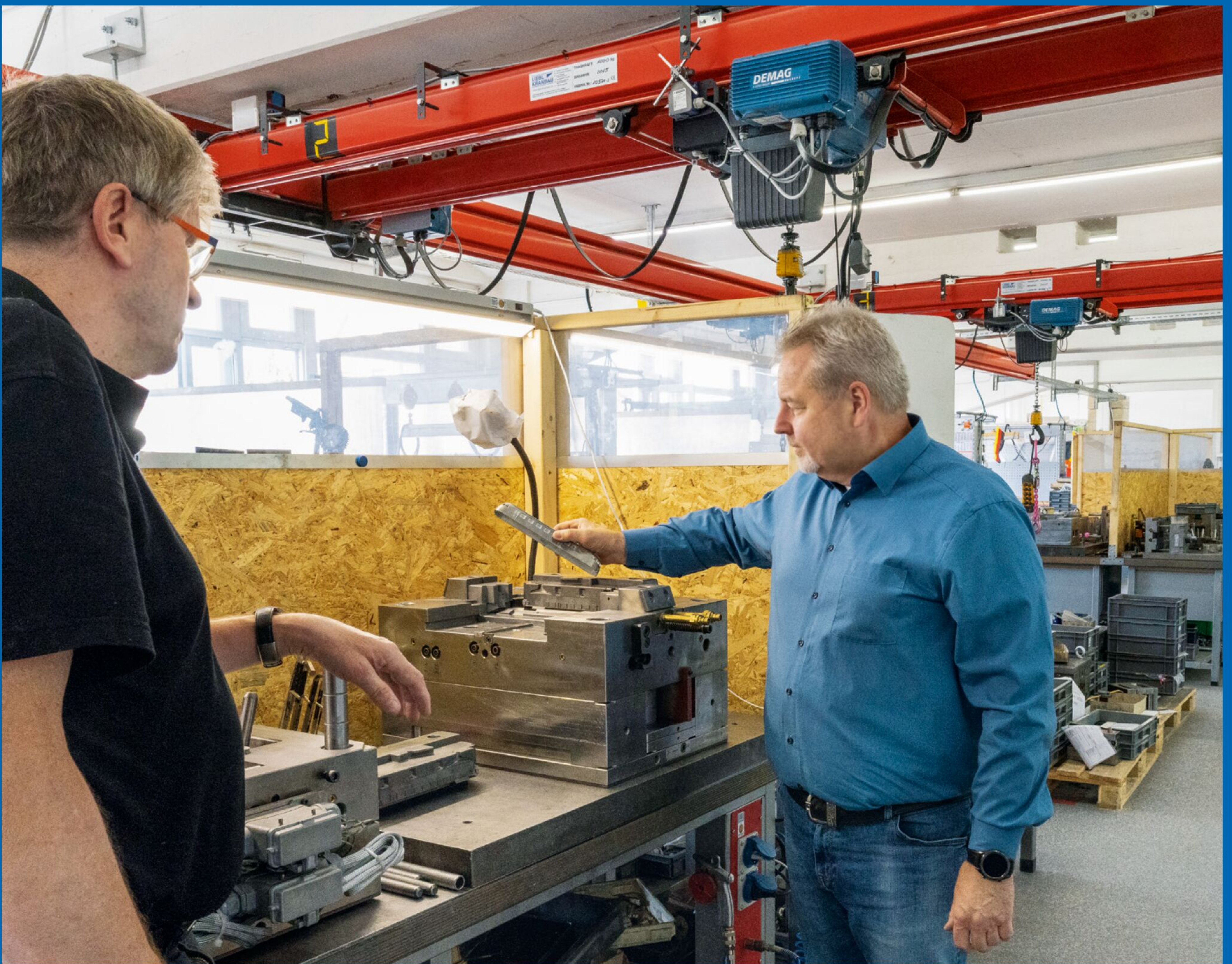
Fertige Zinkdruckguss-Form: Werkzeugbau-Abteilungsleiter Roland Kerner (rechts) nimmt den Gießling von der sogenannten Auswerferseite – Roland Haberbosch, Meister Werkzeugbau bei Märklin, stützt sich auf die Führungssäulen der Düsenseite.
