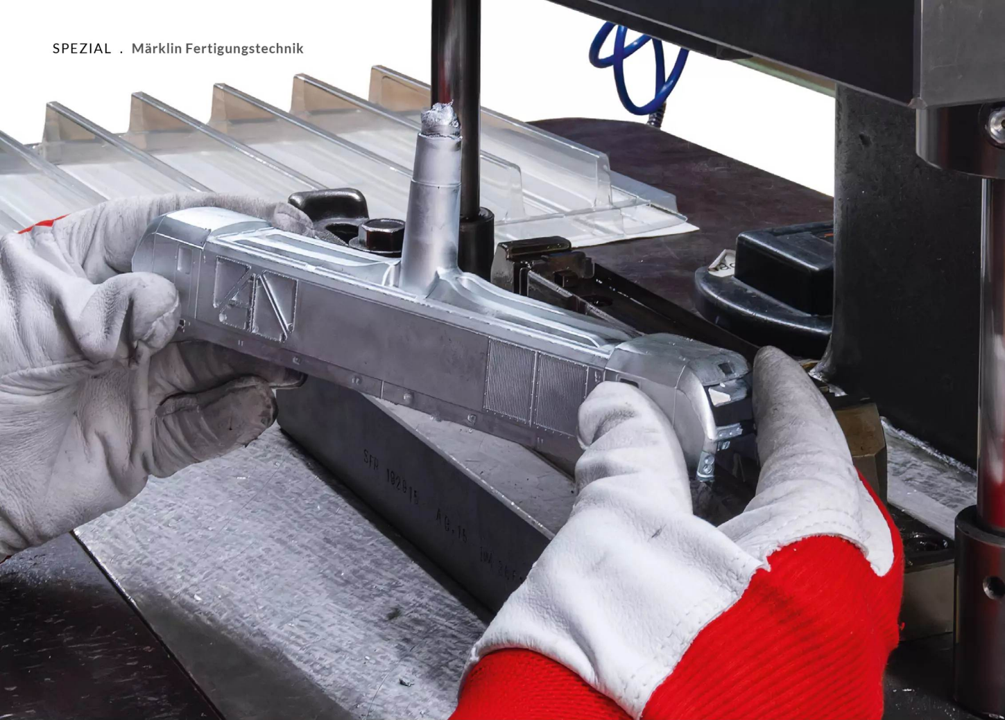
Das Zinkdruckguss-Gehäuse des Dual-Mode-Vectrons (Art. 39291, Trix Art. 25291): Es zeigt glatte Oberflächen sowie feine Details wie Lüftungsgitter und Schrauben. Nun entfernt der Gießer den Anguss mit den vier Gießkanälen.
