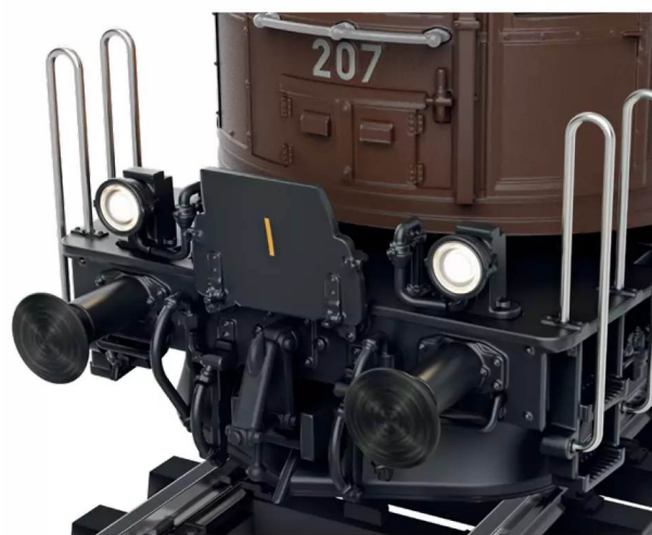
... der Vorbau mit Lampen, Läufen und Leitungen.
