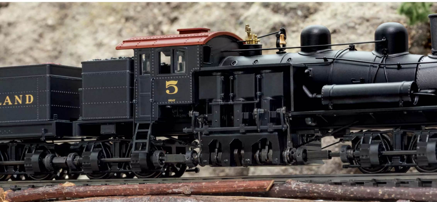
Weitere Besonderheit der Bauart Shay: Die Zylinder stehen senkrecht – im Modell wurde die weitverbreitete Drei-Zylinder-Version umgesetzt.
