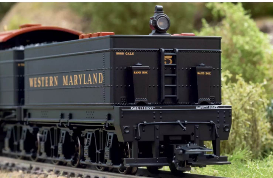
v Zwei Treibdrehgestelle tragen den Tender. Der verteilte Antrieb bringt eine große Zugkraft.
