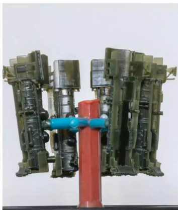
Die feindetaillierten 038er-Kunststoffaufbauten aus dem 3D-Drucker werden von Hand zu einem Baum gebündelt. Die Gusspezialisten haben in der Entwicklung das geeignete Material für den Druck erarbeitet.
