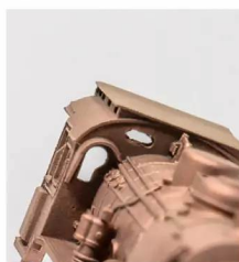
Im Feinguss lassen sich offene Frontfenster mit Druckstauschute fertigen.
