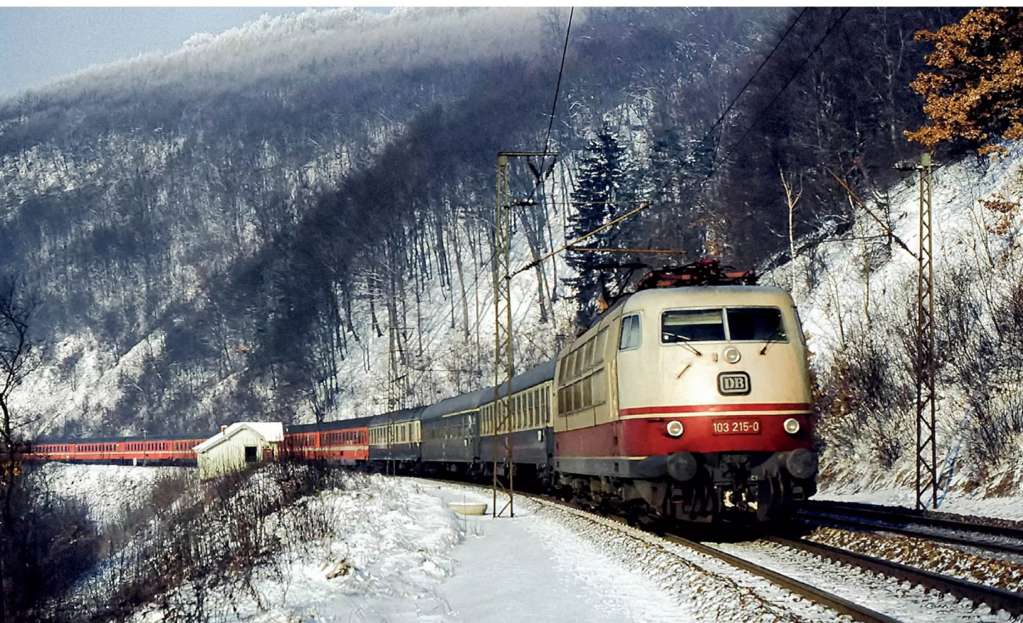
Nachschieben nicht nötig: Die sechssachsige 103 215-0 gehörte mit einer Dauerleistung von 7.440 kW zur stärksten Schnellzuglok-Baureihe der DB. Hier zieht die Kultlok Anfang 1979 den D 311 „Wörtersee“ von Dortmund nach Klagenfurt. Doch es gilt eine Anhängergrenzlast.
