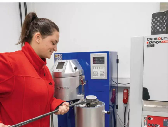
Im Temperaturofen (rechts) wird die Küvette „gebacken“ – der Kunststoff entweicht. In der Gussmaschine wird der Hohlraum mit Bronze ausgegossen. Märklin Mitarbeiterin Michelle Richter entnimmt der Gussmaschine die Küvette mit dem Bronze-Gussbaum.
