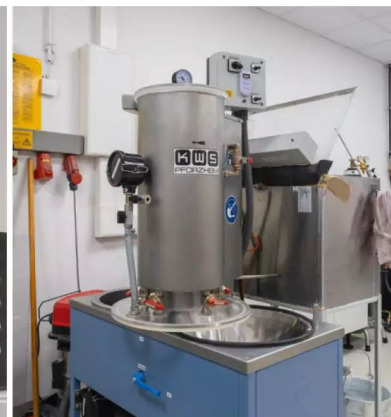
Im Einbettmischer wird eine definierte Einbettungsmasse erzeugt. Die Küvette mit dem Baum wird eingestellt und mit dem Gips gefüllt. Nun ist der Baum umgossen.
