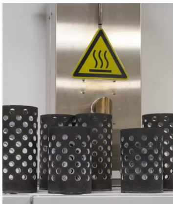
Der Baum mit den 3D-gedruckten 038er-Aufbauten wird in einen Gussformbehälter eingesetzt. Die sogenannten Küvetten mit Löchern bestehen aus Edelstahl, der im Produktionsprozess schwarz anläuft.
