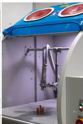
Die Oberflächen der Bronze-038er – hier ist der Gussbaum eingestellt – werden in der Strahlmaschine mit Edelmetallstrahl geglättet. Danach folgt die Nachbearbeitung.
