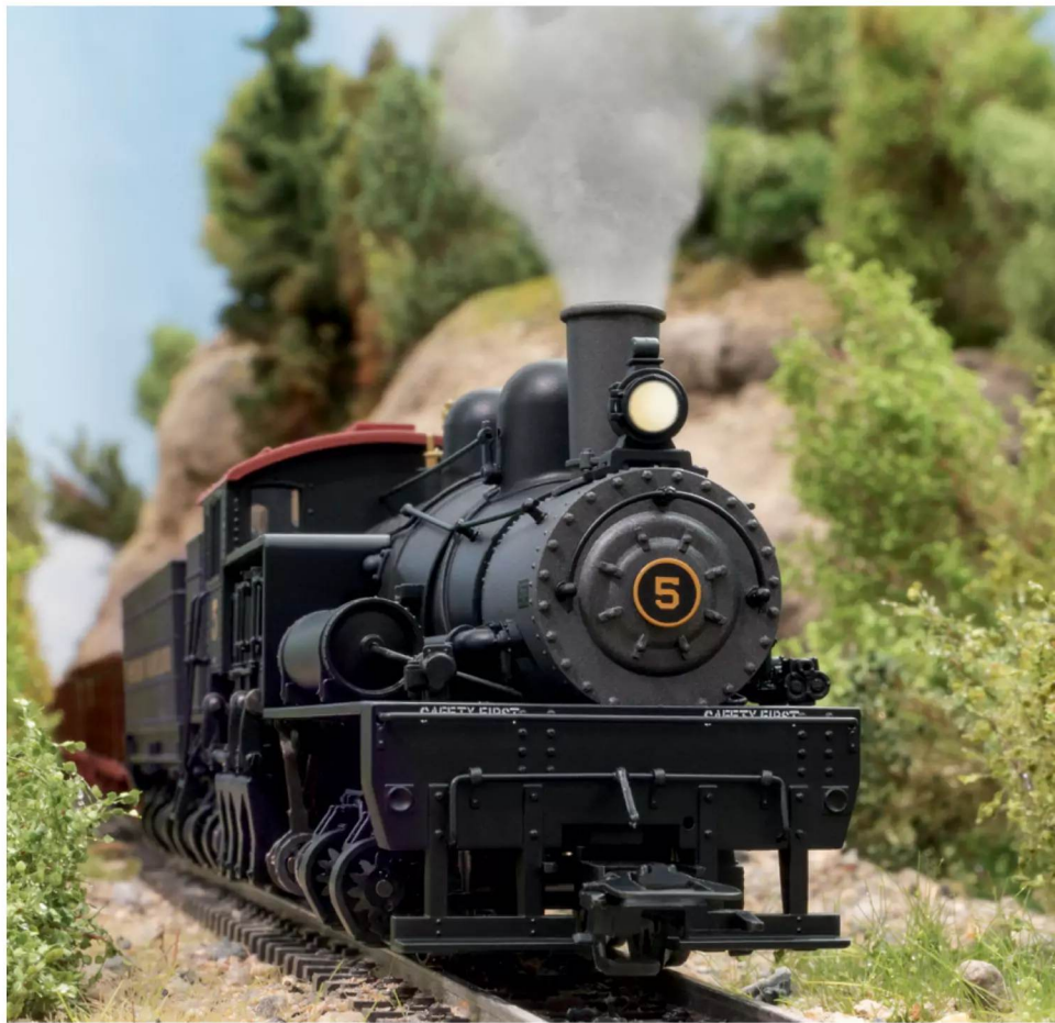
Um das Gewicht der – vom Lokführer aus gesehen – rechten Seite mit der schweren Dampfmaschine, den Kardanwellen und dem Getriebe auszugleichen, wurde der Kessel bei der Shay nach links versetzt.
