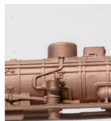
Im Bronze Feinguss werden übliche Ansteckteile wie die Luftpumpe gleich mitgegossen.
