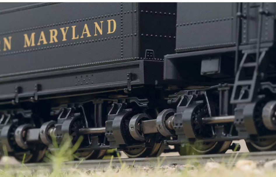
^ Kurbelwellen, Gelenkwellen, Kegelzahnäder: Der Antrieb der Shay ist von außen zugänglich.
