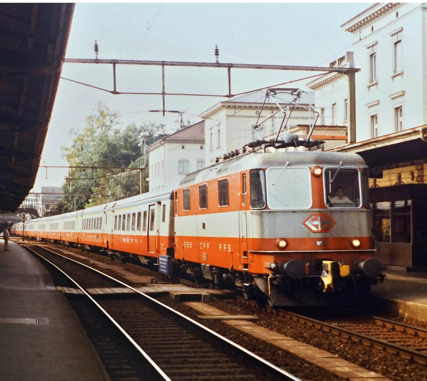
Der „Swiss Express“ im September 1984 auf dem Weg nach St. Gallen bei der Durchfahrt in Aarau. Vorn gut zu sehen die automatische Kupplung.
