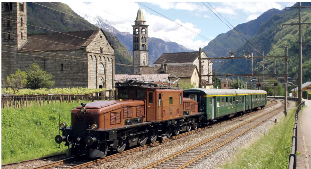
Mythos Krokodil: Das prämierte Foto der Ce 6/8 II 14253 im Tessin von Achim Büttner entstand auf der Clubreise 2019 anlässlich des Jubiläums „100 Jahre Krokodil“. Für vier Generationen verkörpert der legendäre E-Lok-Typ mit langen Vorbauten und Stangenantrieb den Reiz der Modellbahn. Bei Märklin bekleidet das Krokodil den Rang des inoffiziellen Wappentiers.
