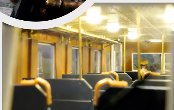
Der gut detaillierte Innenraum des Modells wird über acht LEDs im Deckenbereich in angenehmes Licht getaucht.
