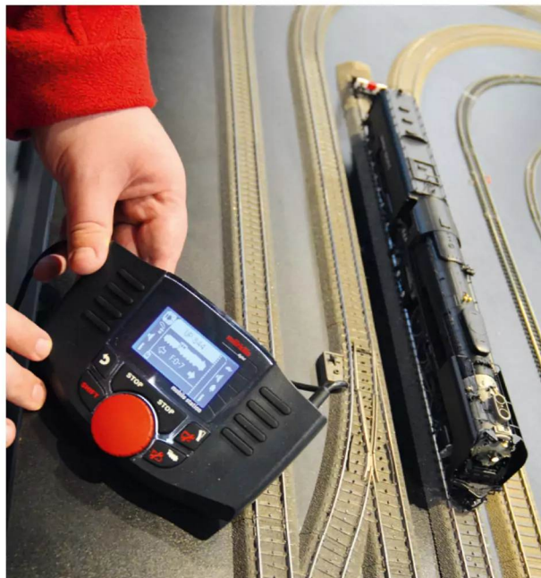
Automatische Anmeldung: Mit dem mfx-Protokoll meldet sich die Lok beim Steuergerät an und kann sofort bedient werden.
