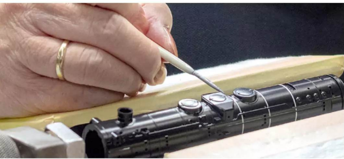
Handmalerei: Nicht zu automatisieren ist die Farbgebung der Kesselringe – sie erfolgt nach der Grundfarbgebung und bevor an den Kessel die Leitungen und Regler angesteckt werden.
