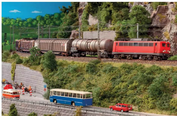
Eine 140er zieht ihre Frachten über die Anlage. Da ein Kesselwagen an der Spitze läuft, ist der vordere Pantograph gehoben.
