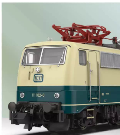
Front mit Einfachlampen: Mit der Fahrtrichtung wechseln auch das Dreileicht-Spitzensignal und die roten Schlusslichter.
