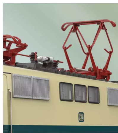
Kühlung: Durch die Lüftungsgitter Bauart Klatte wird beim Vorbild Kühlluft für die Fahrmotorlüfter angesaugt.
