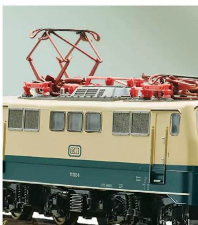
Dachaufbau: Die Dachleitung vom Stromabnehmer zum Hauptschalter wird von Isolatoren gestützt.
