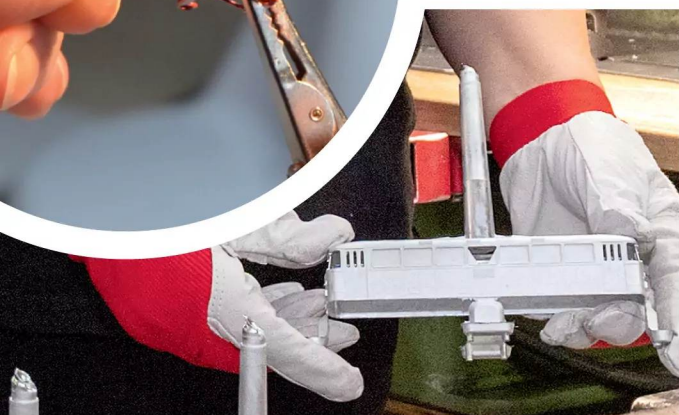
Mensch und Maschine: Typisch in der Fertigung sind die Handgriffe der Maschinenbediener, die mit Qualitätskontrolle einhergehen. Gleich wird vom Gehäuse noch der Anguss entfernt.
