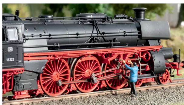
Angetrieben wird das Modell von einem Hochleistungsmotor, der seine Kraft auf alle drei Kuppelradsätze überträgt.
