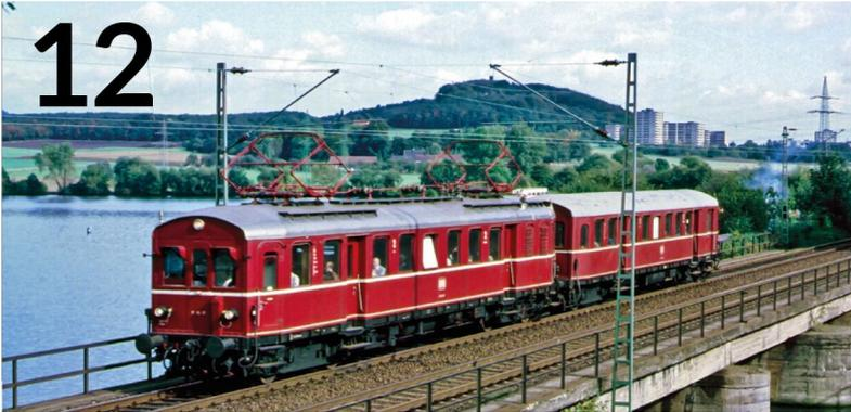
**Elektrifizierung und Wendezugbetrieb: Die Triebwagen der Bauart ET 85 nahmen in den 1920er-Jahren die Zukunft des Vorortverkehrs vorweg.**
