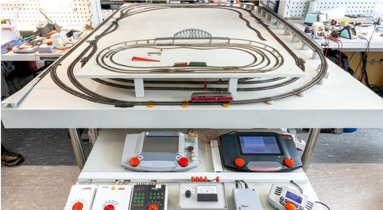
Der Prüfstand in der Reparaturabteilung. Hier werden alle eingesandten Modelle auf Herz und Nieren geprüft. Erst was auf allen Gleisrädern, Weichen und Steigungen einwandfrei funktioniert, wird dem Kunden zurückgeschickt.
