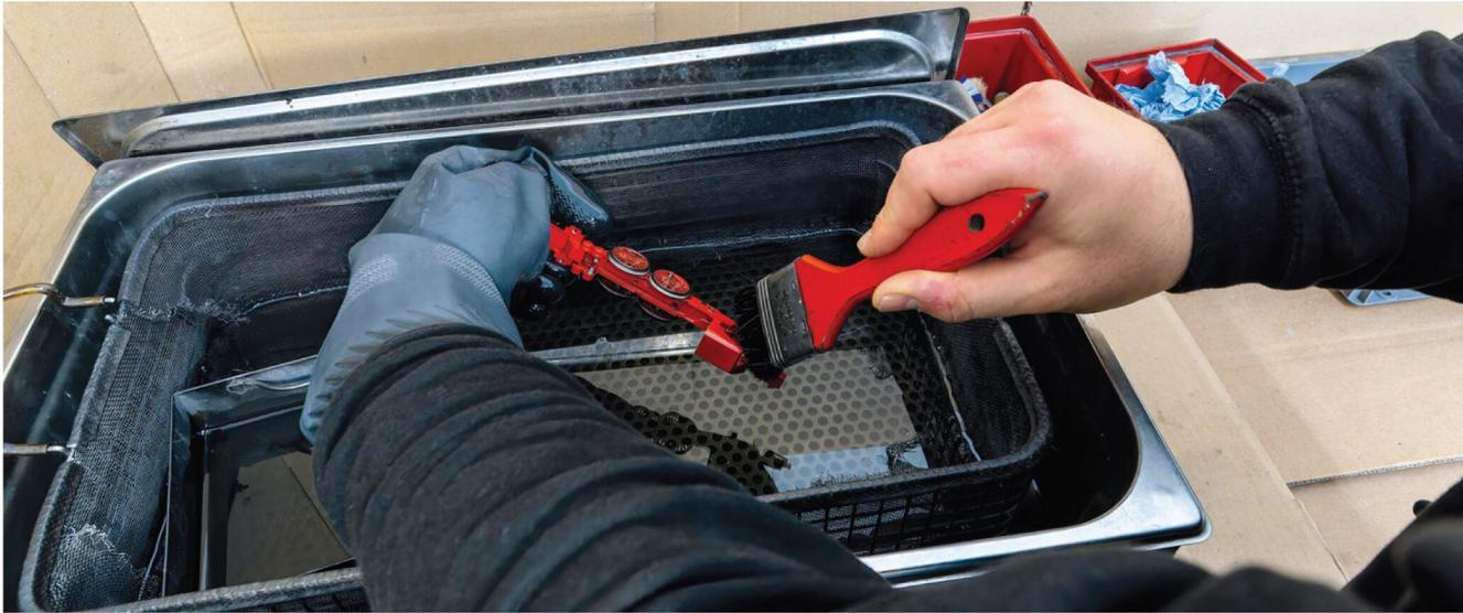
Eine verharzte Lok wird zunächst komplett zerlegt. Dann werden die betroffenen Teile in einem Ultraschallbad gereinigt. Wellen und Lager bekommen anschließend wieder neue Schmierstoffe und das Modell wird wieder zusammengebaut.
