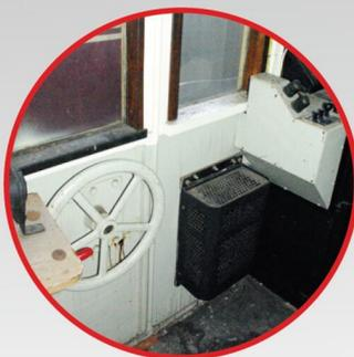
Märklin Dokumentar Bernhard Hümmelchen hat das Bedienrad der Handbremse des ET 95 07 im Führerstand fotografiert (links). Über ein Umlenkgetriebe wird damit die Handbremsspindel bedient. Rechts: Spindelabdeckung und Zeiss-Scheinwerfer.
