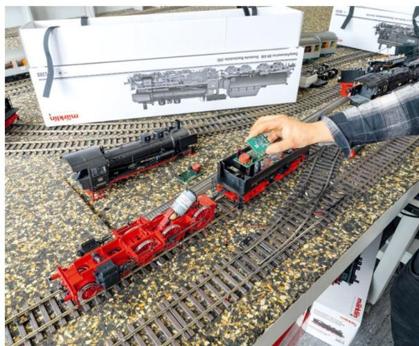
Ein seltener Fall: Bei einer Spur-1-Lok wird der Decoder getauscht. Im Anschluss werden alle Funktionen geprüft.
