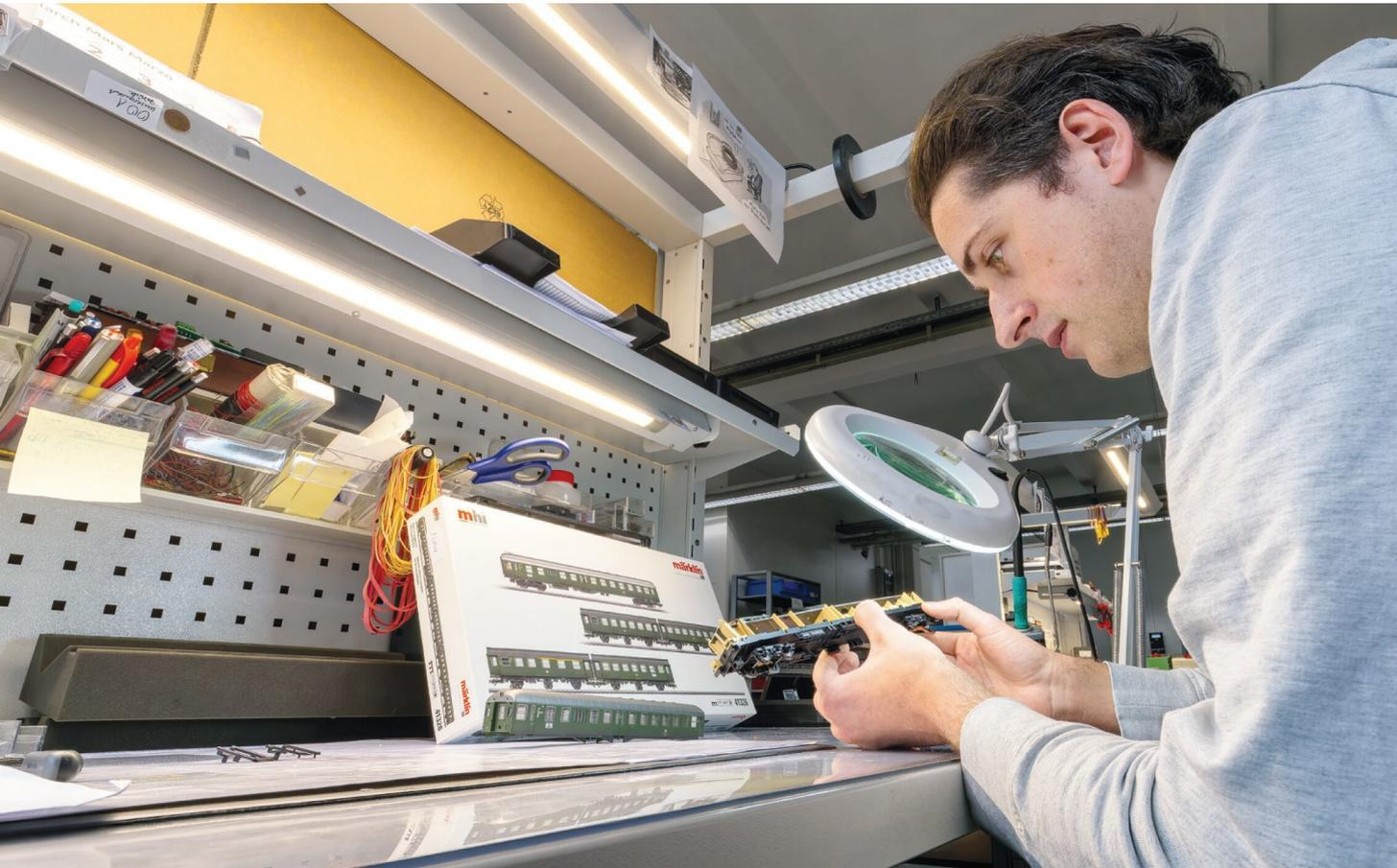
Ein Reparaturauftrag beginnt mit einer genauen Prüfung der eingesendeten Ware. Zunächst wird festgestellt, welches Modell und welche (möglicherweise abgebrochenen) Teile der Kunde genau eingeschickt hat. Dann geht es an die Fehlersuche.
