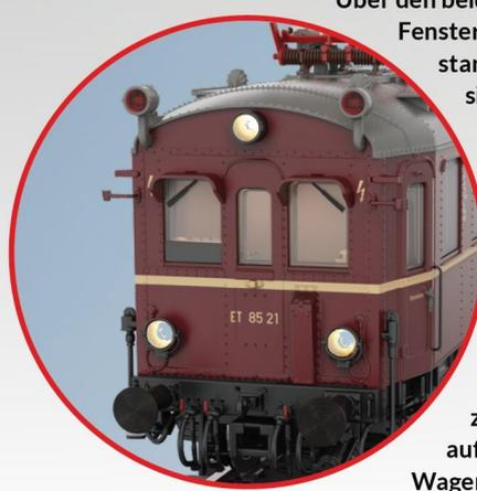
Über den beiden äußeren Fenstern des Führerstands des ET 85 21 sind Fensterschirme angebracht. Beim kleinen mittleren Fenster zeichnet sich noch die ehemalige Stirnwandtür ab, die das Bahnpersonal zum Übergang auf andere Wagen benutzte.
