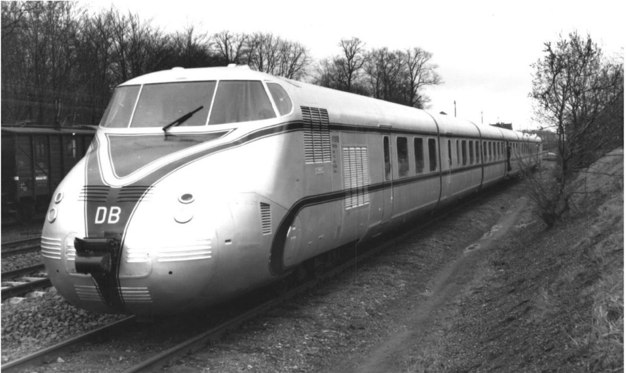
Die beiden VT 10.5-Züge wurden konsequent in Leichtbauweise hergestellt. Die Wagenkästen wurden in geschweißter Schalenbauweise aus Aluminiumlegierungen erstellt. Pro Sitzplatz ergab sich dadurch ein niedriges Gewicht von 920 Kilogramm.
