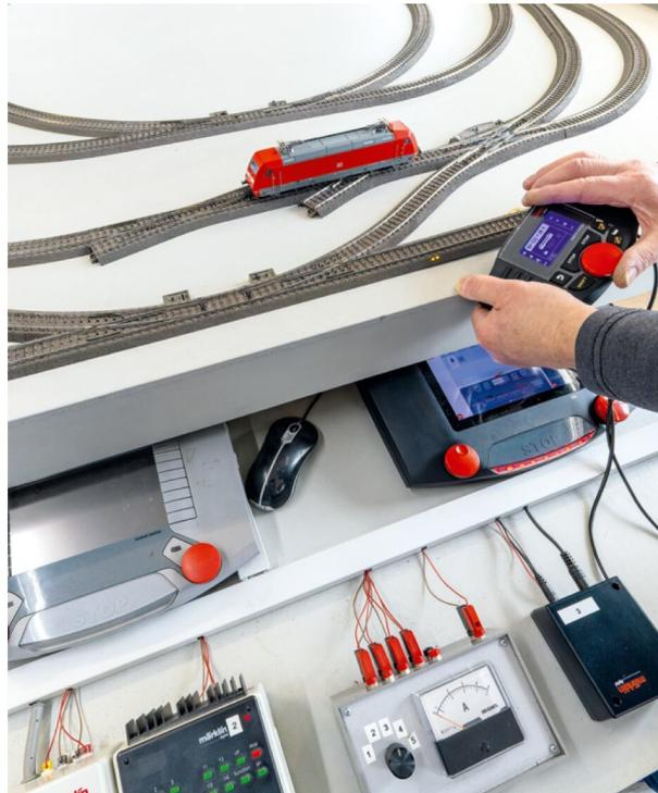
Für den abschließenden Funktionstest stehen alle möglichen Fahrregler zur Verfügung, vom analogen Trafo bis zur CS3.
