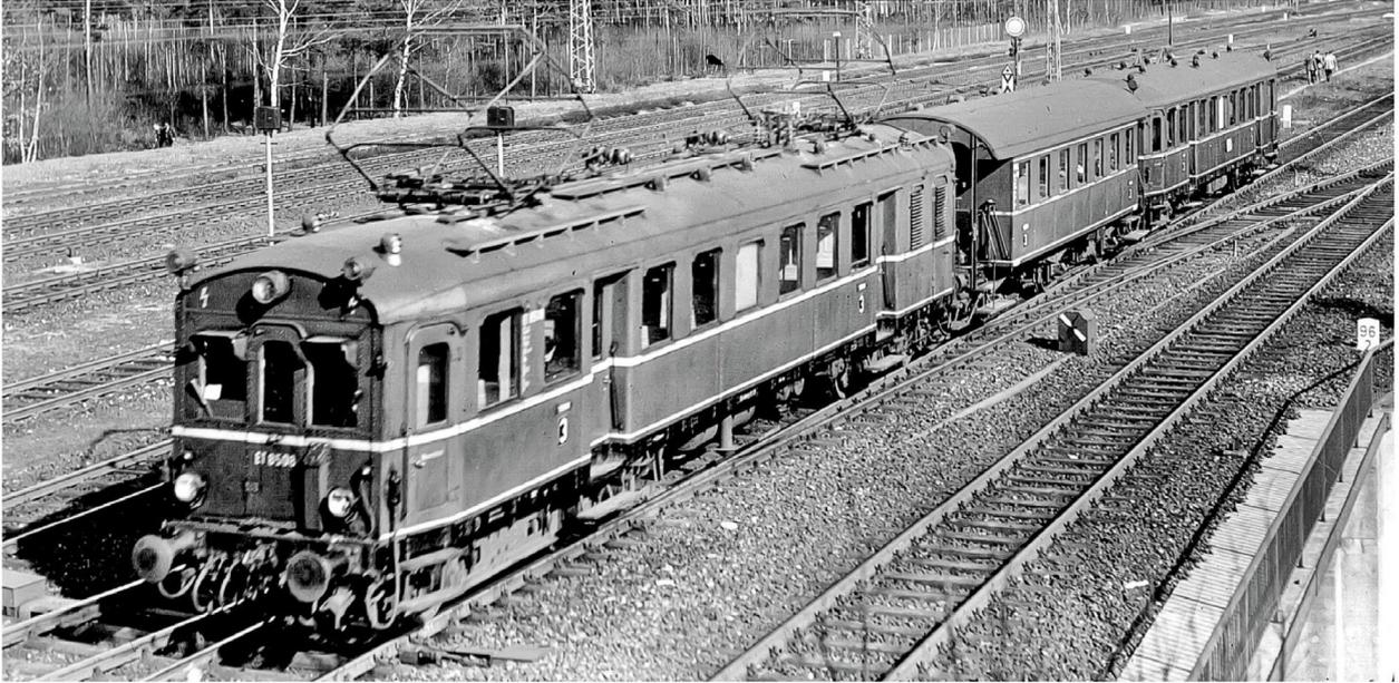
Der ET 8508 fährt am 22. April 1955 in Nürnberg-Dutzendeich ein. Der bekannte Eisenbahnfotograf Carl Bellingrodt hat die drei Fahrzeuge im Zustand vor der Klassenreform – durchgängig Wagen der 3. Klasse – aufgenommen. Auf den Wechselstrom-Triebwagen folgen ein Beiwagen der bayerischen Bauart C3i und ein Steuerwagen ES 85.
