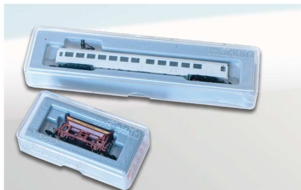
Die Ergebnisse des Tests (bei dem oberen Wagenmuster eine gesprungene Ecke rechts vorn) sind auch wertvolle Informationen für die Märklin Qualitätssicherung.
