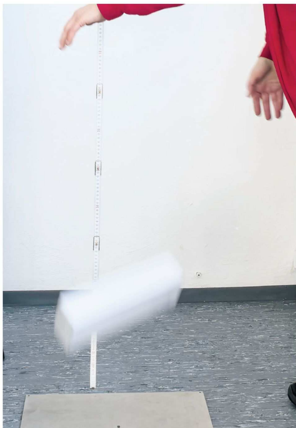
Harte Bandagen: Beim Falltest wird eine neue Verpackung aus 80 Zentimetern Höhe auf eine Stahlplatte fallen gelassen.
