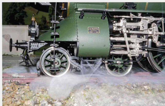
Unter den Zylindern tritt der Dampf bei Fahrt in Abhängigkeit von der Gestängeposition abwechselnd vorn oder hinten aus.
