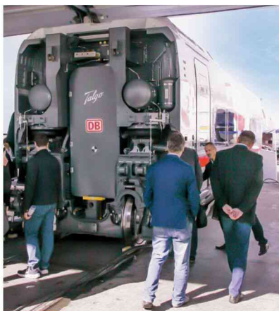
Beim Einzelwagen des ICE L gut zu sehen: die geringe Höhe des Wagenbodens.
