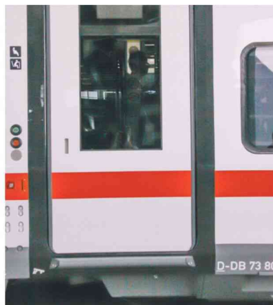
Durch den tiefen Boden können Reisende praktisch stufenfrei ein- und aussteigen.
