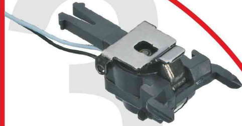
Die Telex-Kupplung (Art. E117993) besitzt einen elektromagnetischen Schalter, der sich digital steuern lässt, und passt in die Norm-Kupplungsaufnahme (NEM 362).
