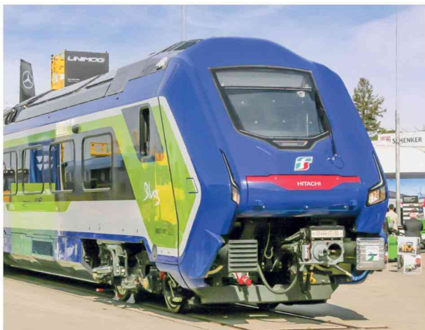
Mit dem Blues kombiniert Hitachi den Betrieb mit Fahrleitung, Akkumulator und Brennstoffzelle (Version für italienische Staatsbahnen).
