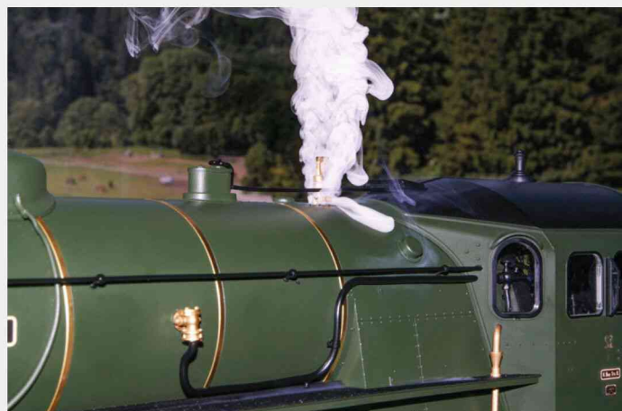
Direkt an der Pfeife gibt es bei Betätigung der Funktionstasten für den Pfiff synchron dazu einen kräftigen Dampfausstoß.
