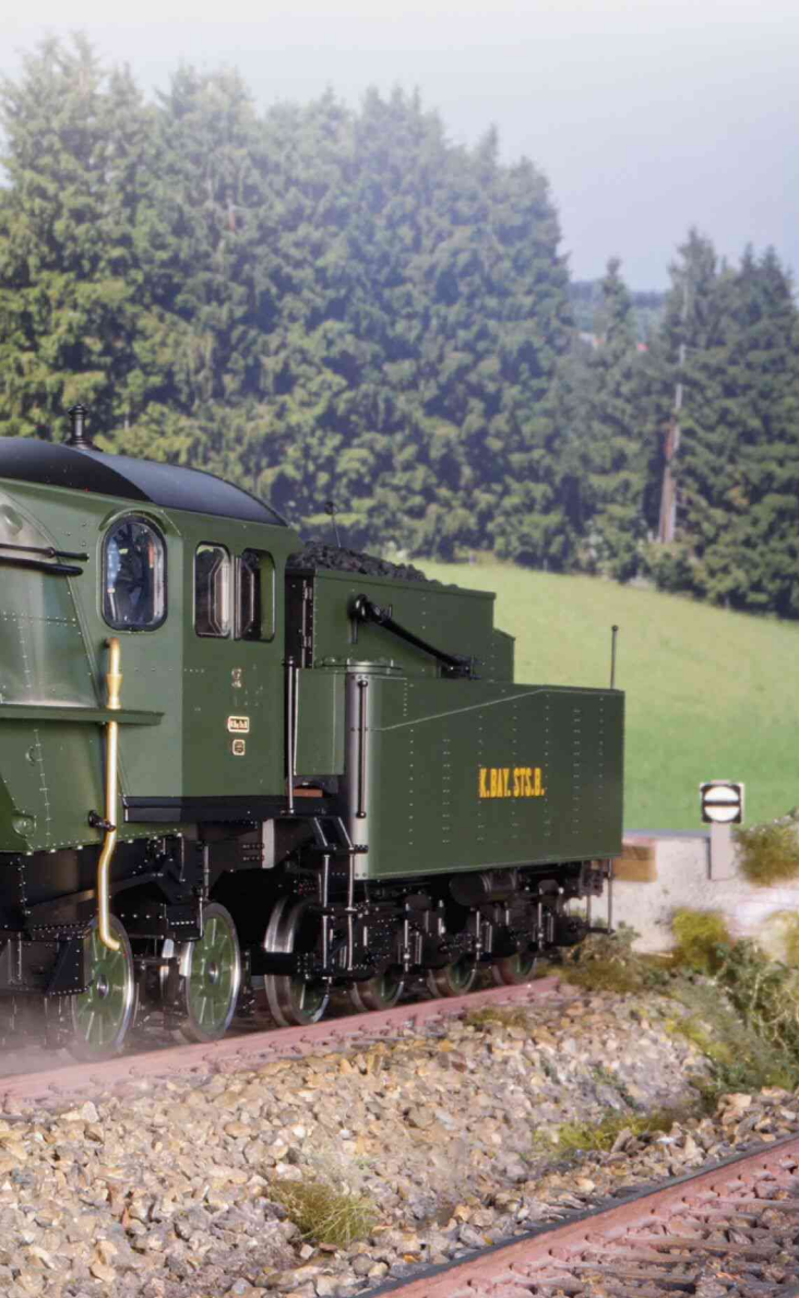
... Am Schornstein tritt der Dampf im Stand im Bläsermodus nur sanft aus. Bei Fahrt qualmt es dann synchron zur Radstellung.
