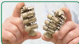
Gussbäume: Das von ME initiierte Feingussverfahren fußt auf dem 3D-Druck und bereichert den Märklin Fertigungsbaubaukasten.
