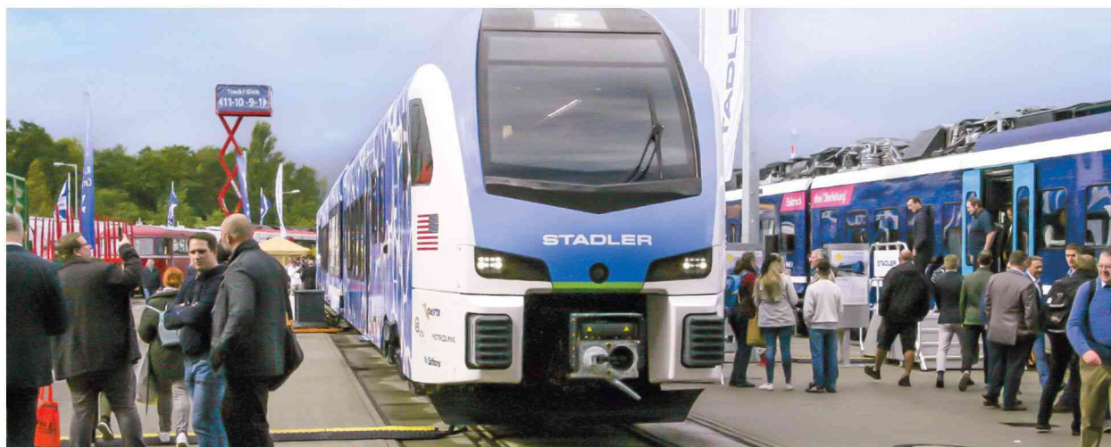
Sauberer in Sachen Umwelt geht es kaum: Stadlers Triebzüge können auch mit Brennstoffzelle betrieben werden. Für den Verkehrsbetrieb in San Bernardino, Kalifornien, entwickelte Stadler den Zug FLIRT H2, bei dem Wasserstoff als Energie dient.
