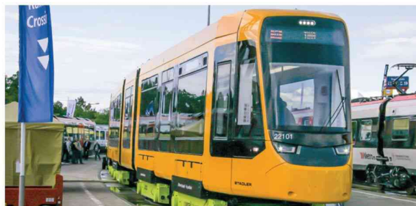
Darfs eine Straßenbahn sein? Stadlers TINA wartet mit einem „total integrierten Niederflur-Antrieb“ auf (Einsatzort Darmstadt).
