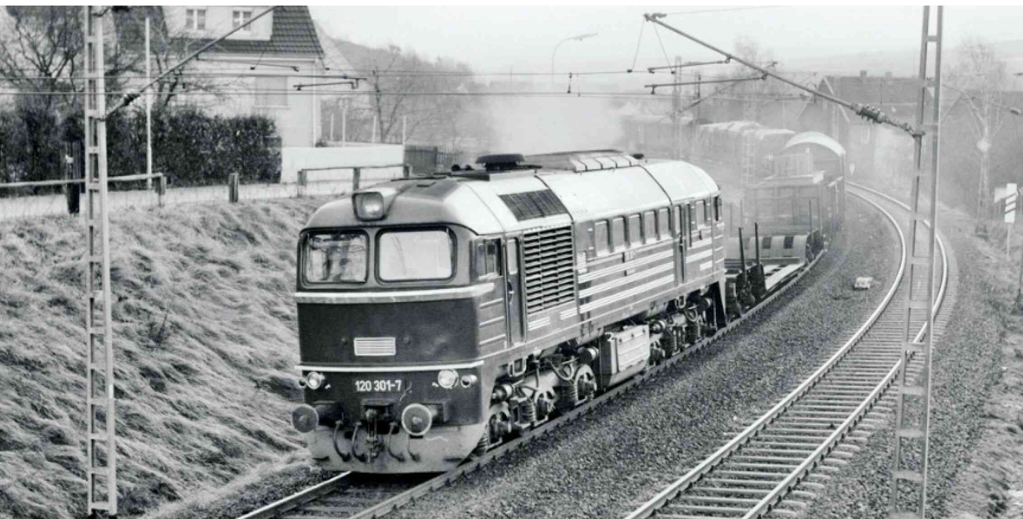
Unentbehrlich im Güterzugdienst der Deutschen Reichsbahn (DR): die Baureihe 120. Insgesamt 378 dieser dieselelektrischen Lokomotiven stellte die DR in den Jahren 1966 bis 1975 in den Dienst, um den sogenannten „Verdieselungs-Beschluss“ umzusetzen.
