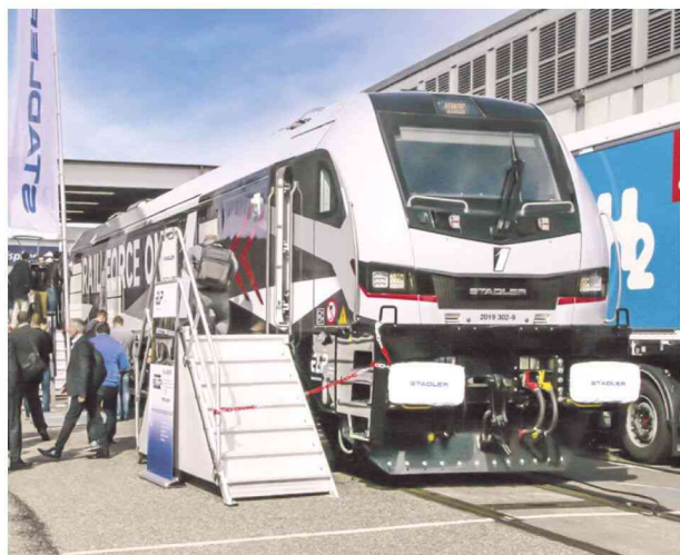
Die Euro 9000 von Stadler: Neben der klassischen Schraubenkupplung ist der Einbau einer Scharfenberg-Kupplung möglich.
