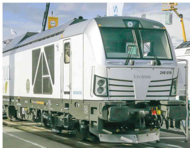
... Strom aus der Fahrleitung als auch vom Dieselmotor erzeugt verträgt. Den Stromabnehmer trägt sie nur auf dem Führerstand 1.
