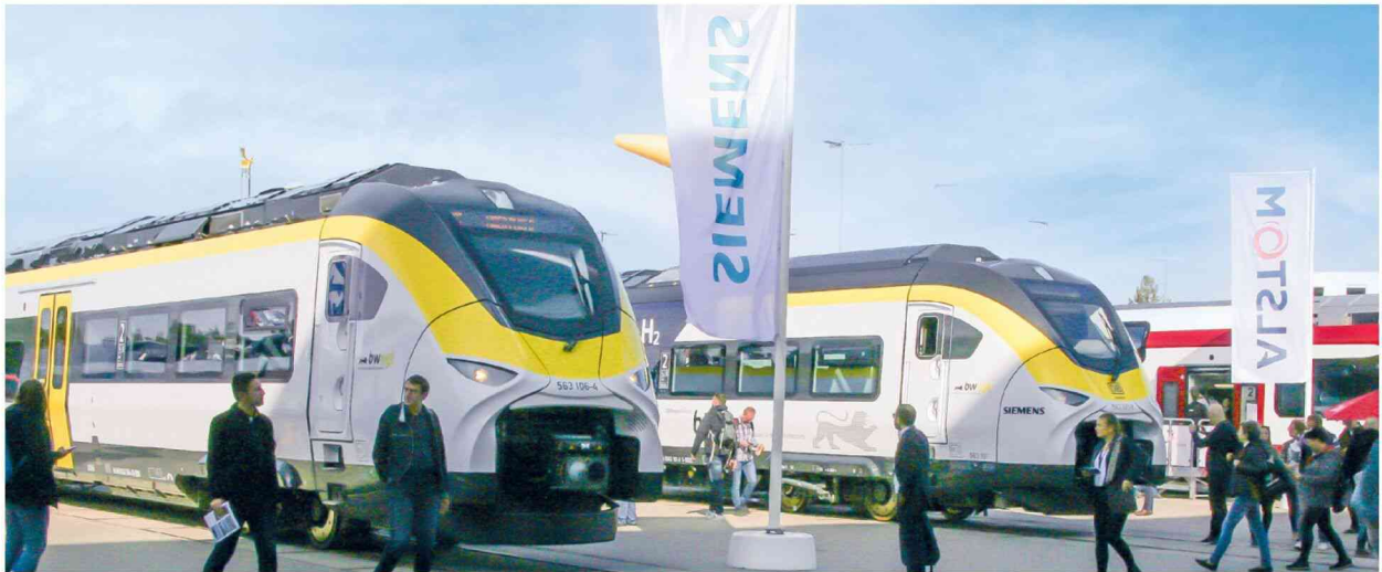
Der Mireo Plus B (links) und der Mireo Plus H von Siemens: Technisch Geschwister, gleichen sie optisch eineiigen Zwillingen. Ersterer ist als reiner Akkumulator-Triebwagen konzipiert, in Letzterem speist eine Brennstoffzelle die Fahrmotoren mit elektrischem Strom.
