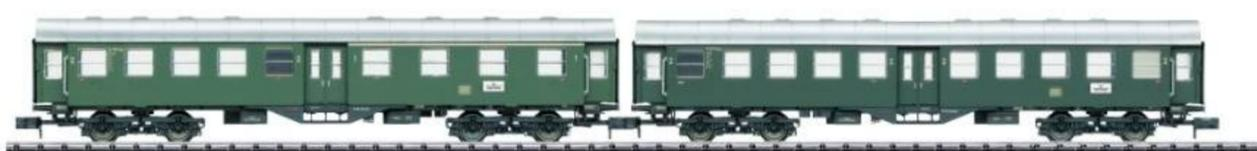
**Umbauwagen-Set (Trix Art. 15409):** Die DB-Nahverkehrswagen wurden neu konstruiert und mit Kinematik für Kurzkupplungen sowie LED-Innenbeleuchtungen ausgestattet.
