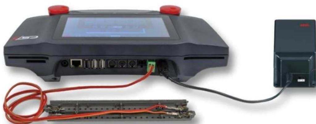
Einsatzbereitschaft herstellen: Erst die CS3 mit der Anlage verbinden, dann mit dem Schaltnetzteil an der Stromversorgung anschließen.
