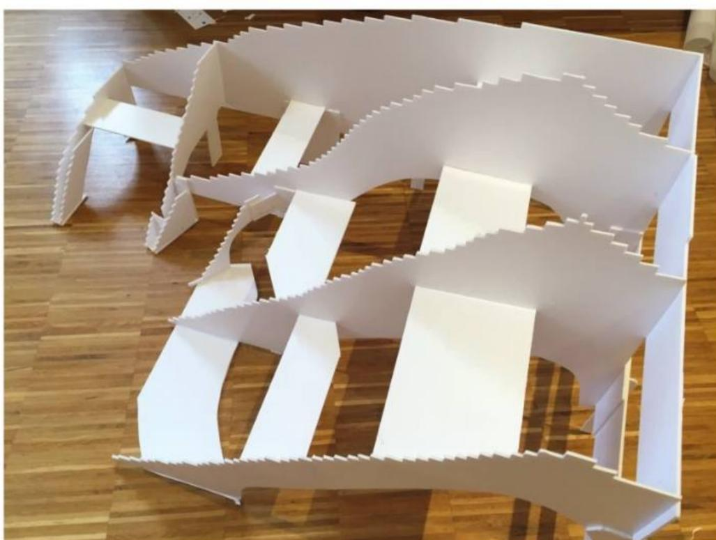
**Zwischenstufe beim Aufbau einer Anhöhe:** Die senkrechten Schotten werden durch wenige waagerechte Zwischenstücke stabilisiert, auf die treppenartigen Abstufungen werden die Höhenlinien-Flächen geklebt.
