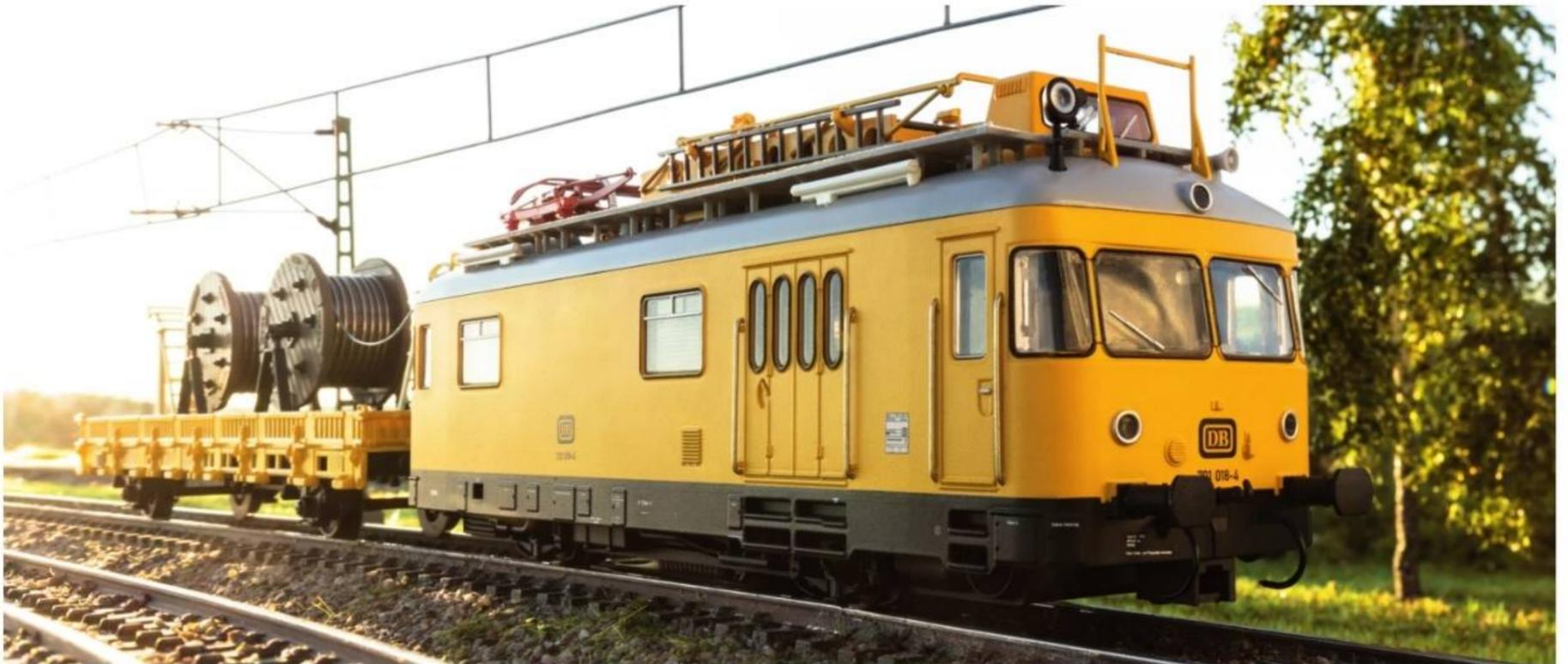
**Funktionsmodell:** Der Regelturmtriebwagen Baureihe 701 (Art. 39973) verfügt über eine digital steuerbare Arbeitsbühne sowie einen heb- und senkbaren Scherenstromabnehmer und zieht zusätzlich einen zweiachsigen Oberleitungsbauwagen mit Kabeltrommeln.
