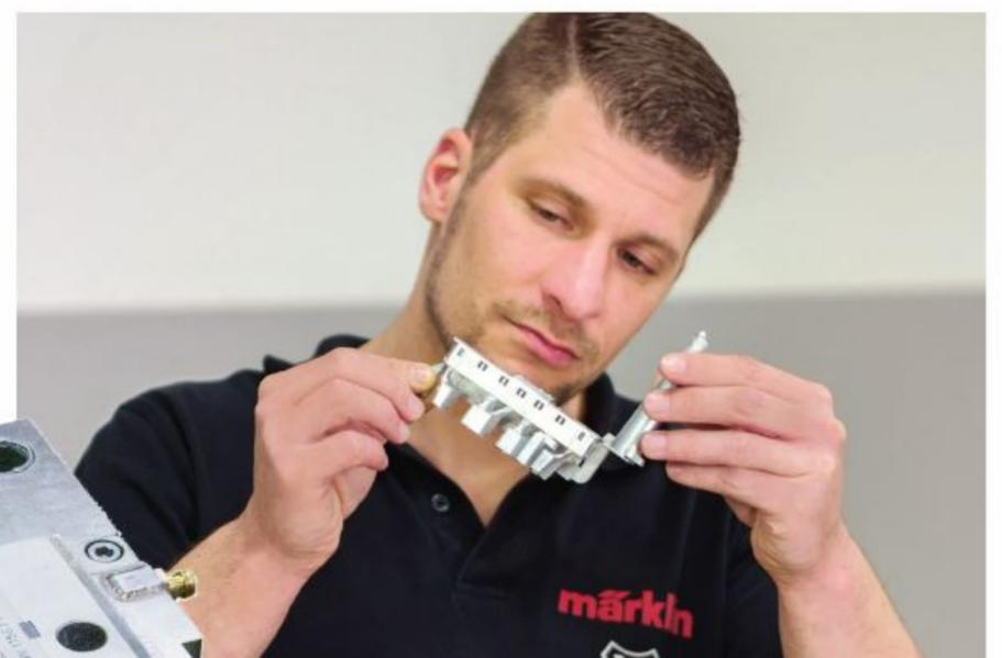
Prüfung eines gerade gegossenen Gehäuses: Der Anguss (Kegel) und der Überguss unten (Entlüftungsbohnen) sind noch zu sehen.
