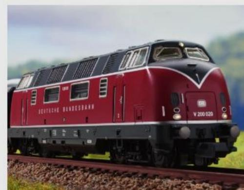
Die V 200 020 (Trix Art. 16224) ist eine schwere dieselhydraulische Lok – und das ist auch beim Digital-Modell zu spüren: Fahrgestell und Aufbau des purpurroten Klassikers sind aus Metalldruckguss für die sichere Stromabnahme und eine gute Zugkraft.
