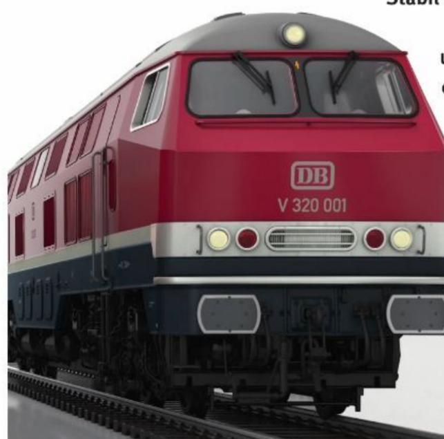
**Stabil und filigran: Neben Fahrgestellrahmen und Lokaufbau sind ebenfalls sehr viele angesetzte Teile aus Metall, wie beispielsweise die Scheibenwischer, die Griffstangen und die Haltegriffe.**
