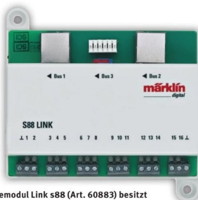
Das Rückmeldemodul Link s88 (Art. 60883) besitzt 16 Kontaktanschlüsse und kann mit zahlreichen weiteren s88 AC/DC gekoppelt werden.
