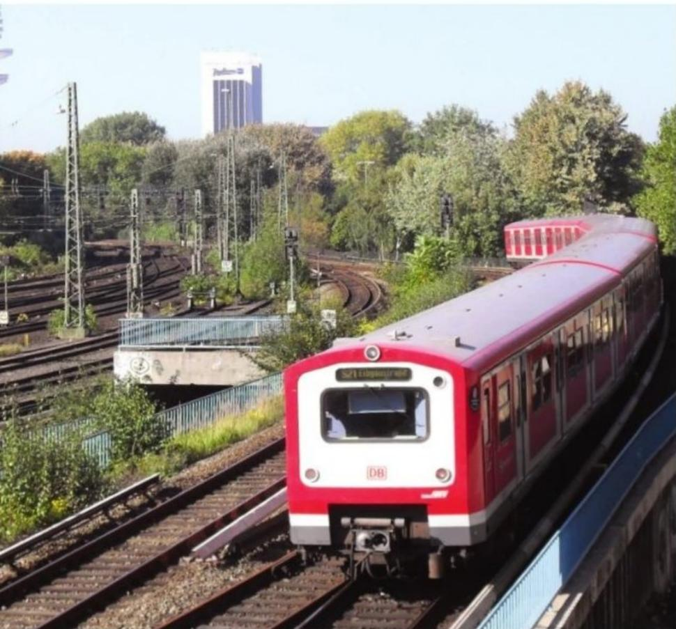
Derzeit verkehren in Hamburg S-Bahn-Triebwagen aus drei Baureihen, hier die älteste BR 472/473 aus den 1970er-Jahren in Richtung Dammtor.
