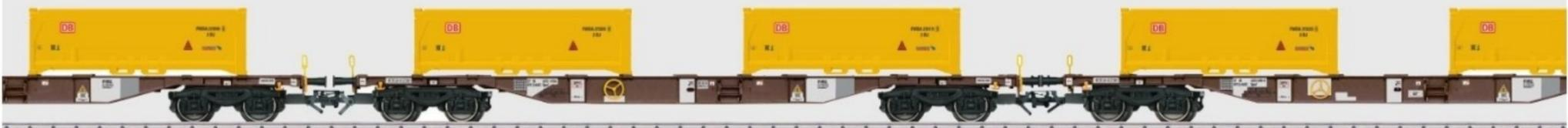
Set mit jeweils zwei vierachsigen Containertragwagen Bauart Sgns der AAE. Beladen mit jeweils zwei Mulden für den Erdaushub von S21.
