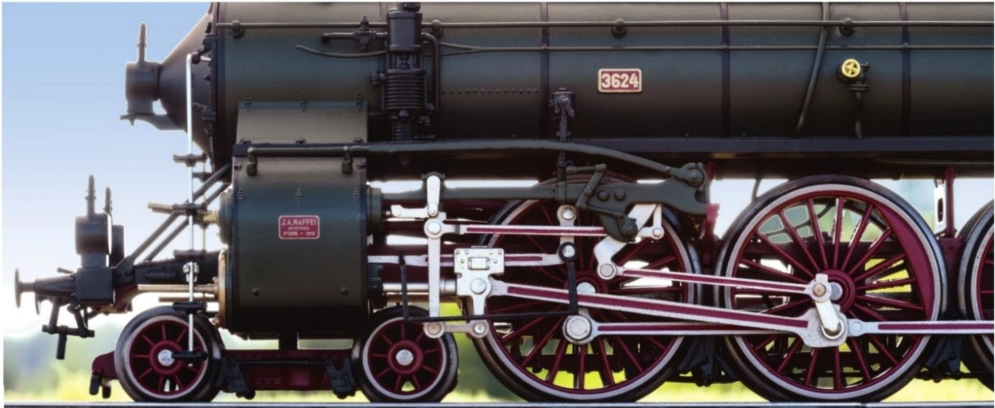
**Freier Fahrwerksdurchblick:** Filigranes Fahrwerk aus Metalldruckguss mit durchbrochenem Barrenrahmen und einer detaillierten und vollständigen Darstellung des kompletten Gestänges. Angetrieben vom 5-poligen Hochleistungsmotor mit Schwungmasse.
