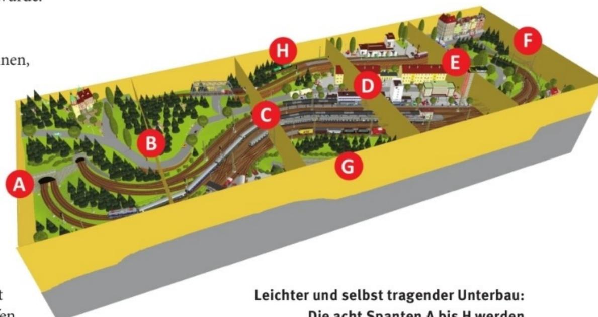
Leichter und selbst tragender Unterbau: Die acht Spanten A bis H werden miteinander verschraubt.
