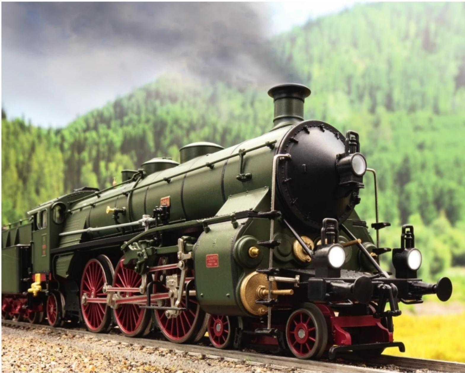
**Kontaktfreudige Dampflokomotive: Anschluss zwischen Lok und Tender mit Kurzkupplungs-kinematik sowie serienmäßig mit einer montierten Schraubekupplung an der Lok-Vorderseite.**
