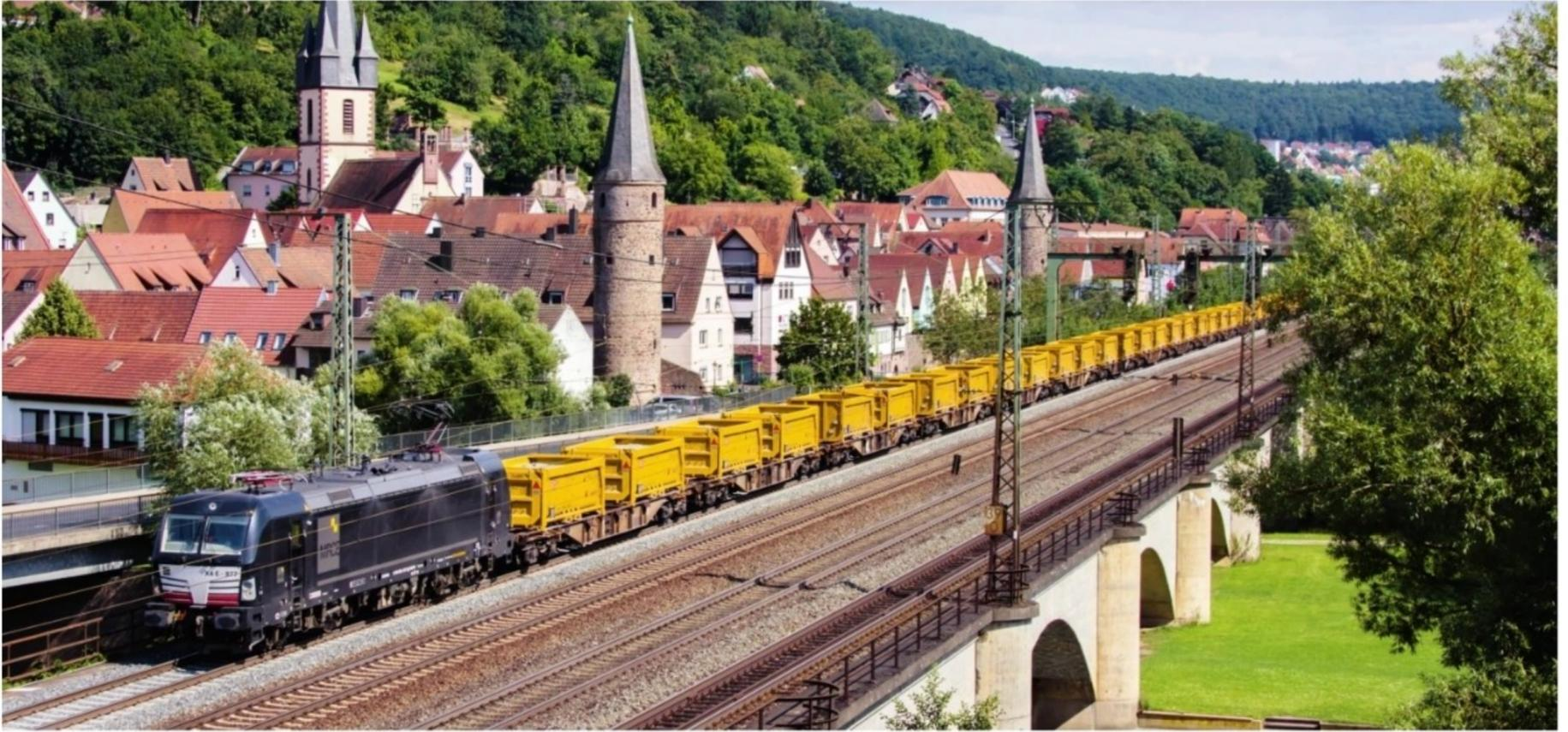
Jeder einzelne Zug, bestückt mit bis zu 20 Wagen und in der Spitze 400 Meter lang, kann rund 1.100 Tonnen Ladung transportieren.
