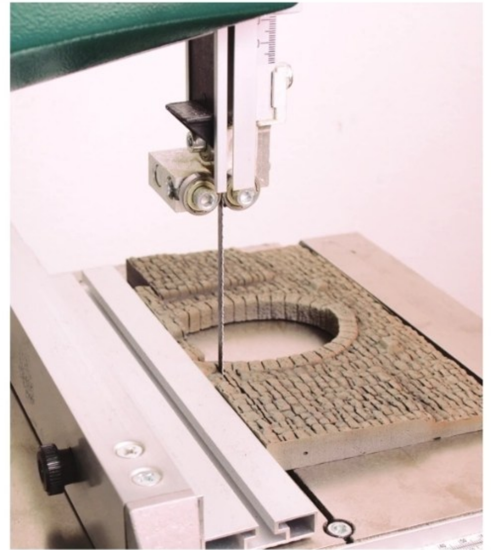
Abtrennen der unteren Steinreihe: Eine Bandsäge erledigt dies komfortabel und exakt.
