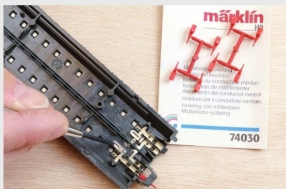
Durch Aufstecken der roten Fahrtstrom-Isolierhülsen (Art. 74030) an Anfang und Ende der Streckenabschnitte können diese stromlos gestellt werden.
