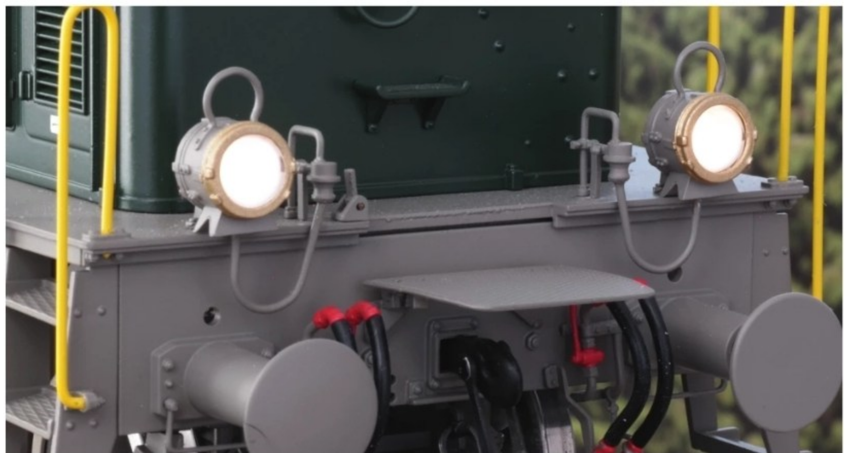
Das Übergangsblech an der Pufferbohle lässt sich vorbildgerecht entriegeln und herunterschwenken. Die Nachbildungen der Bremsschläuche sind flexibel.
