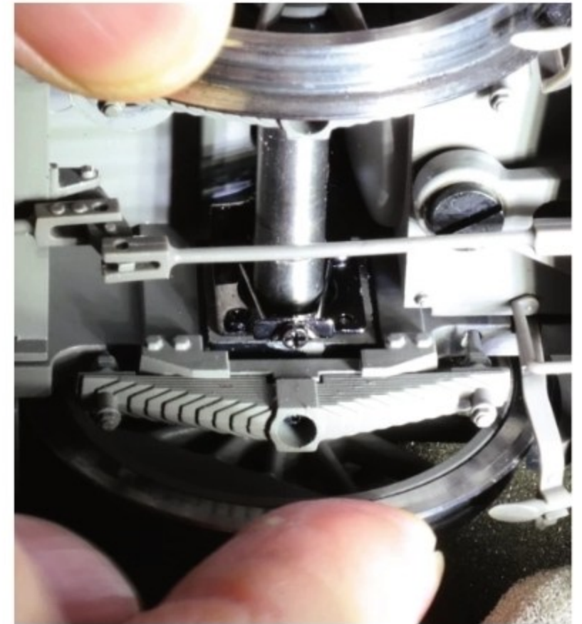
Die Stromaufnahme der Treibachsen erfolgt über die gefederten Kugellager über Achsschleifer.
