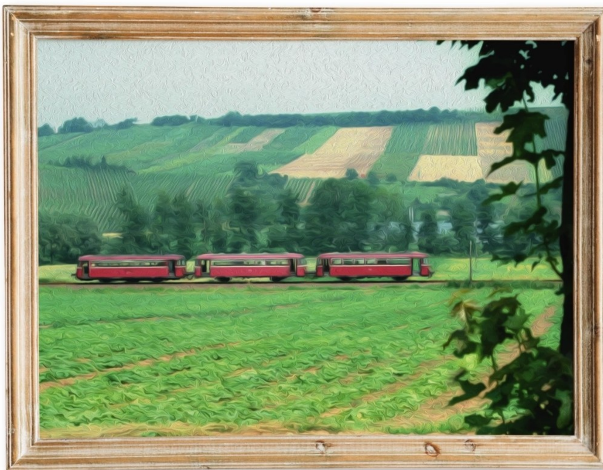
Typisch auf wenig frequentierten Strecken: Schienenbus bestehend aus Motor-, Bei- und Steuerwagen.
