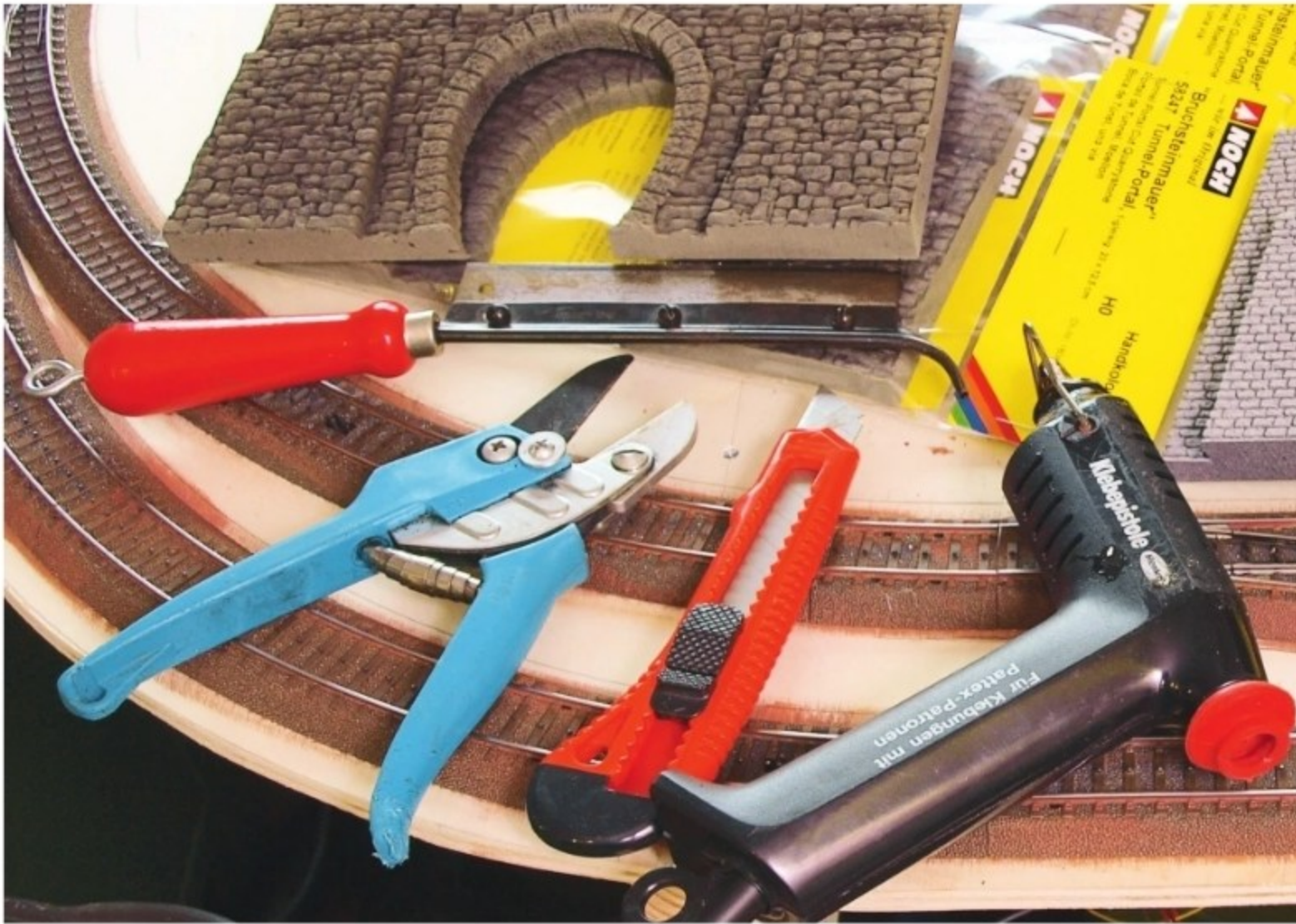
Es kann losgehen: Die Kunstbauten schneiden wir zu mit einem Teppichmesser, einer Gartenschere und einer Bastelsäge. Angeklebt wird mit der Heißklebepistole.
