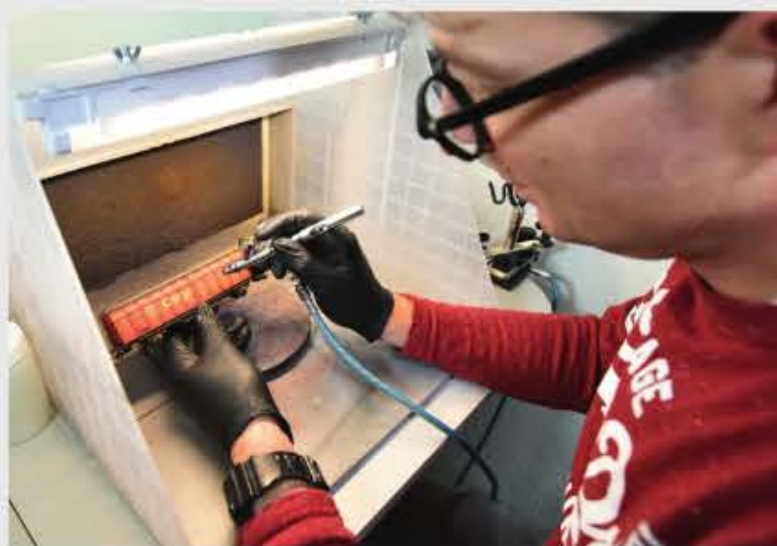
Hand in Hand: Die Airbrush-Pistole zählt neben diversen Pinseln zu einem der Hauptwerkzeuge für authentische Alterungsarbeiten.
