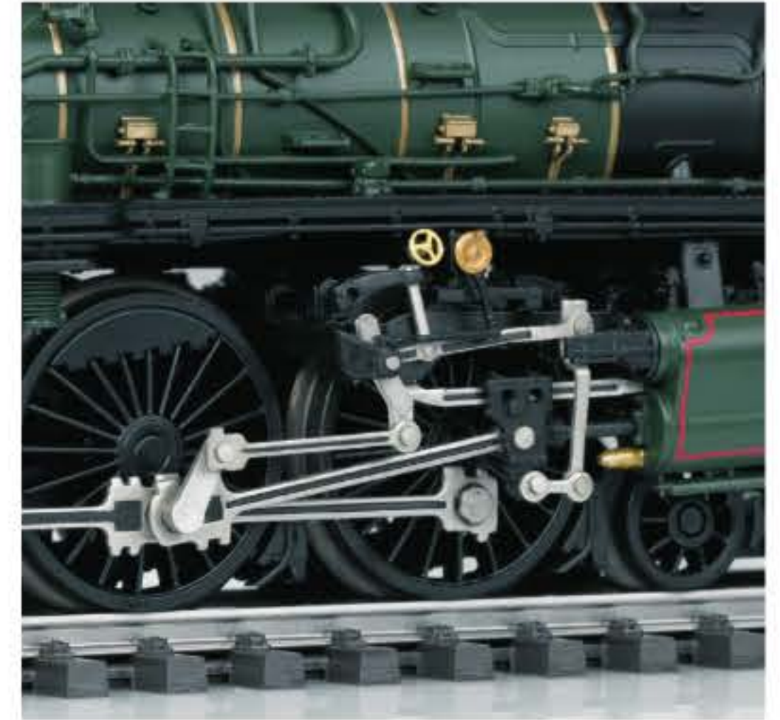
Technisch komplex: Der Hochdruckzylinder arbeitet auf die zweite, der Niederdruckzylinder auf die erste Triebachse.
