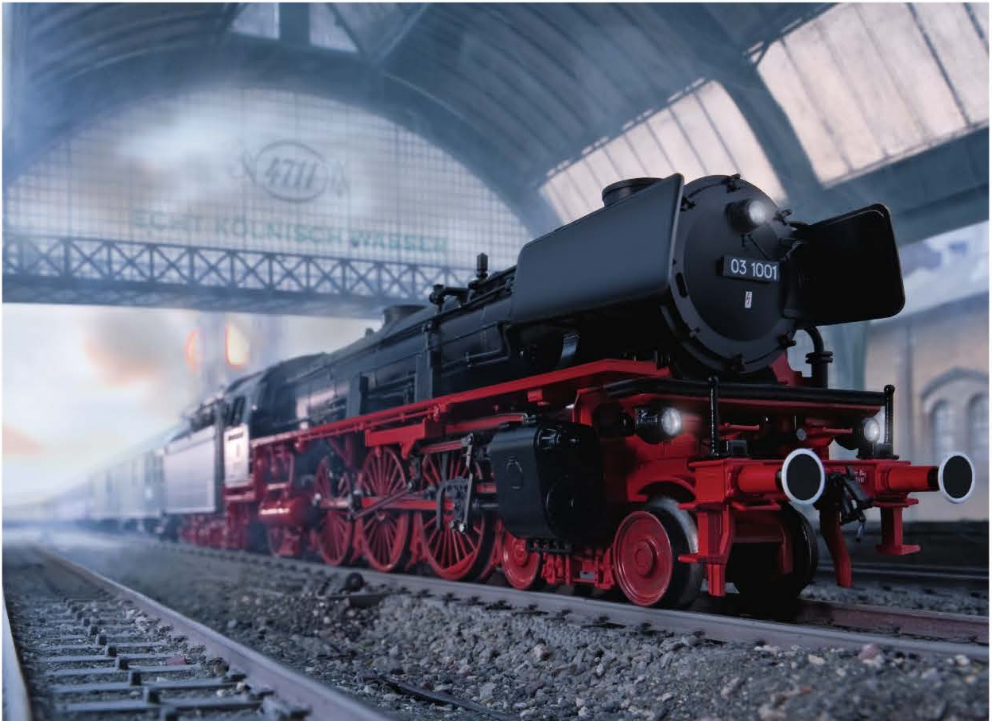
Tempomacher: Die Schnellzug-Dampflokomotive 03 1001 der DB im Betriebszustand um 1961, unverkleidet und bereits mit Neubau-Hochleistungskessel ausgestattet (Art. 37915).
