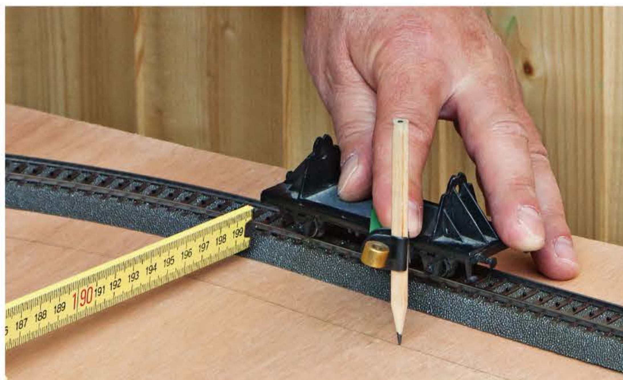
Anzeichnen der Trassenbretter in der Profi-Variante: Auch ein umgebauter Güterwagen kann als Lehre dienen.
