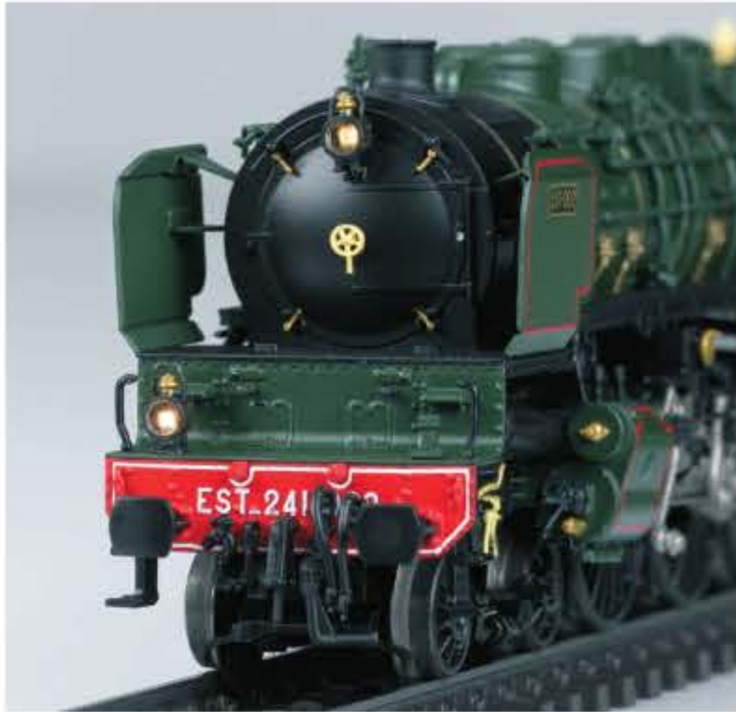
Das typische Zweilicht-Spitzensignal der französischen Ostbahn (EST) lässt sich beim Modell digital schalten.
