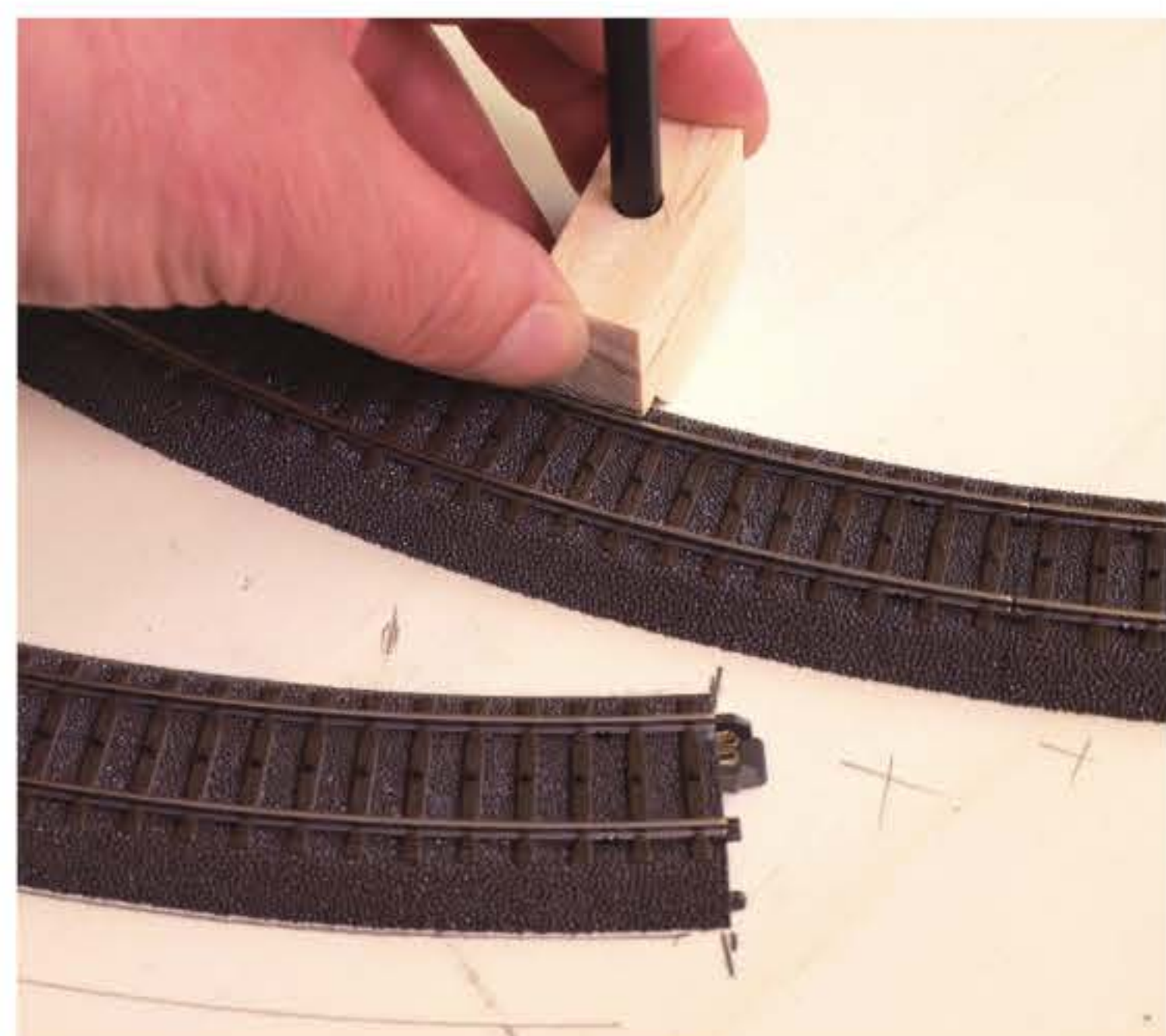
Große Erleichterung: Die Lehre hält den Bleistift stets in richtiger Entfernung zum Gleis.
