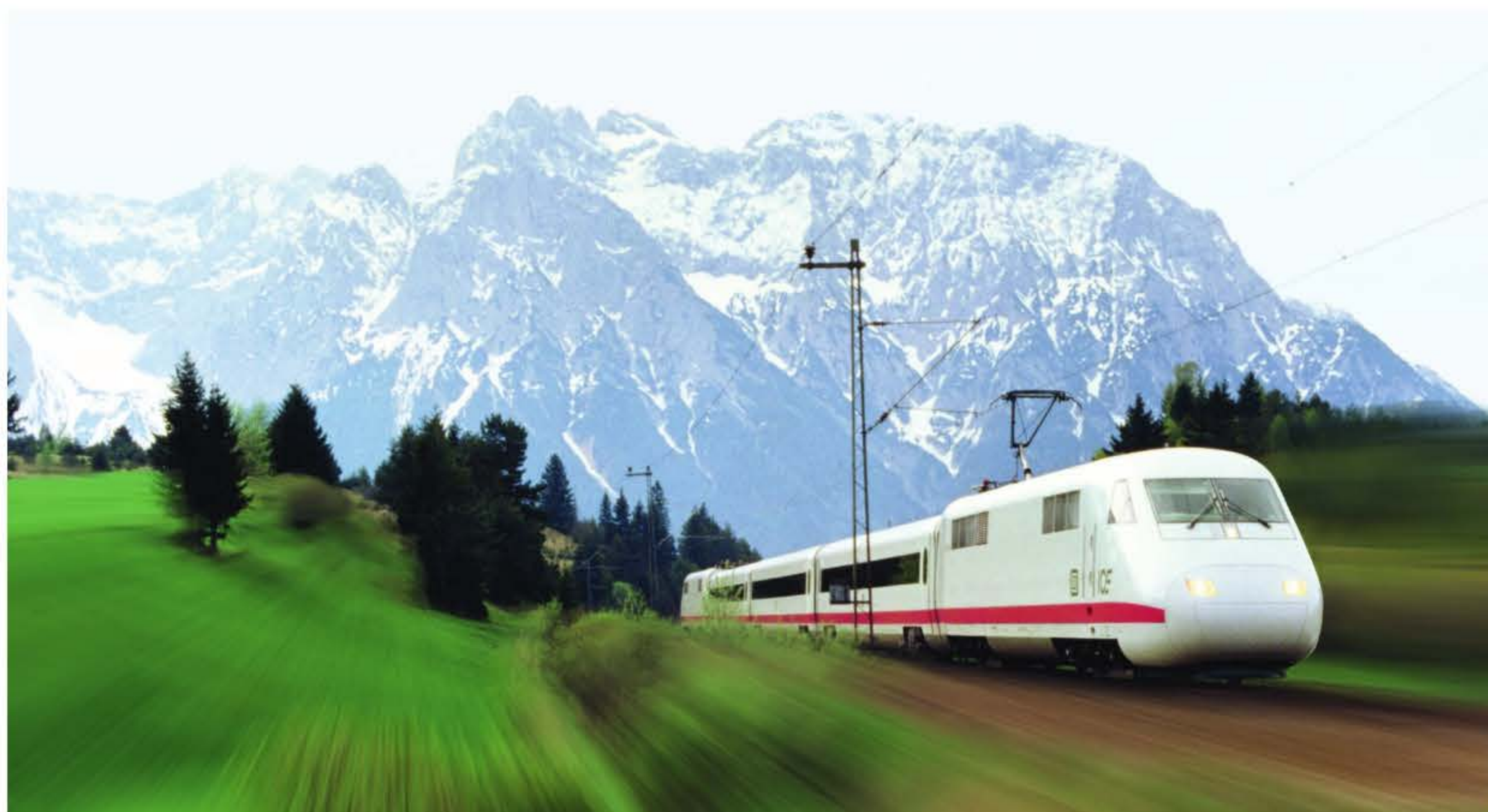
Vorläufer der heutigen ICE: Der InterCityExperimental war in den Jahren ab 1985 als Versuchsfahrzeug auf Deutschlands Schienen unterwegs. Er bestand aus zwei Triebköpfen der Baureihe 410 und drei Mittelwagen der Baureihe 810.
