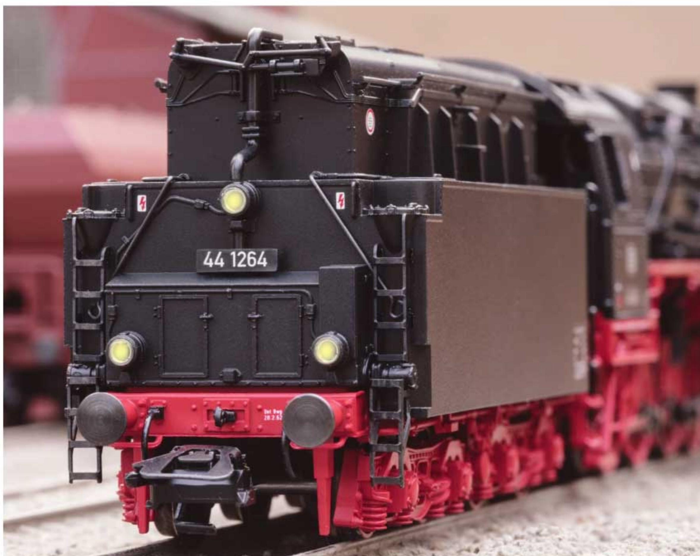
Öltender der BR 44: Die kulissen geführte Kurzkupplung sorgt für einen vorbildgerechten kurzen Abstand zwischen Tender und Waggon. Selbst das Doppel-A-Licht ist schaltbar.
