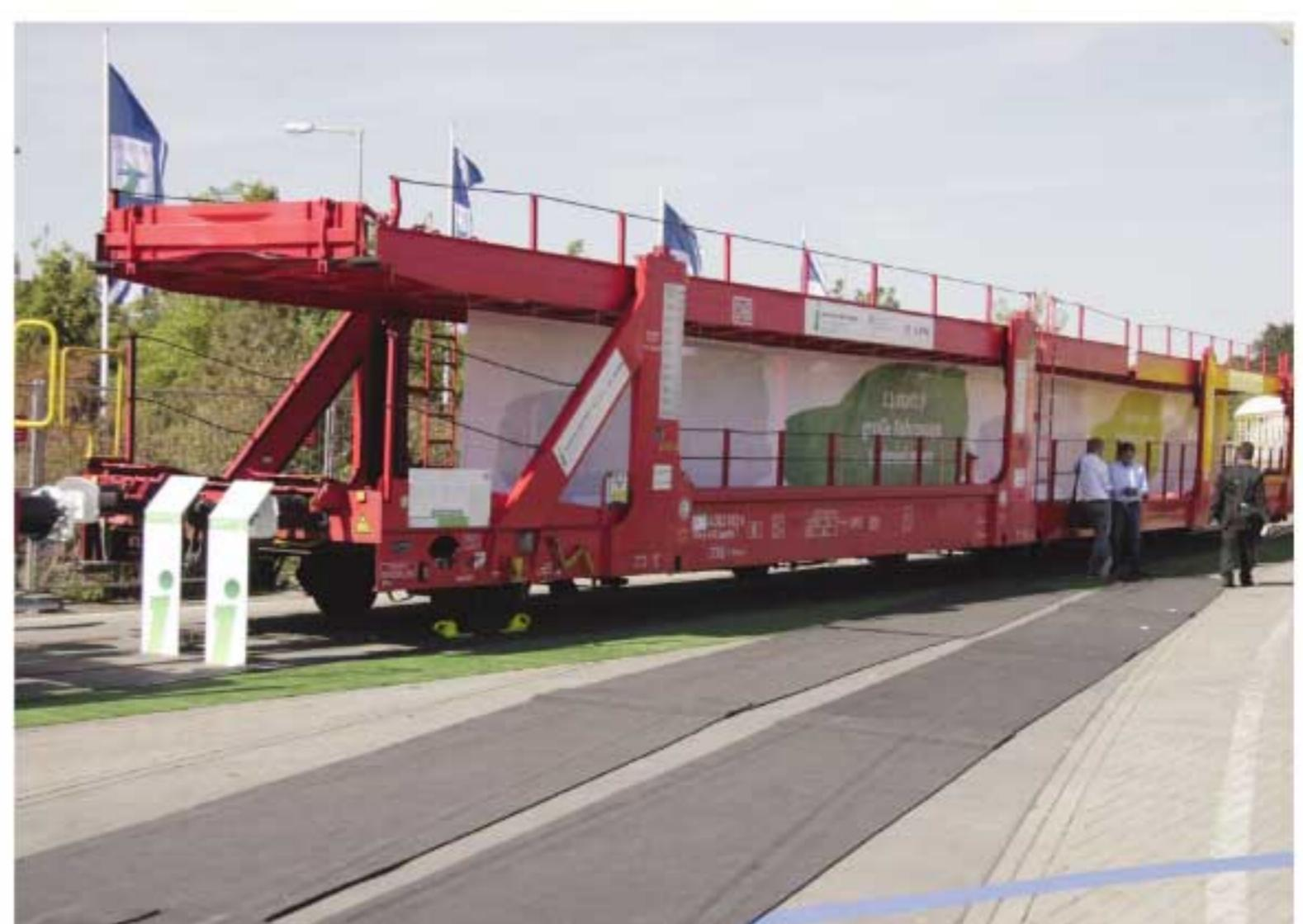
Fährt deutlich leiser und kann auch unterschiedlichste Automobile aufnehmen: der neue Autotransportwagen der Bauart Laaeffrs.
