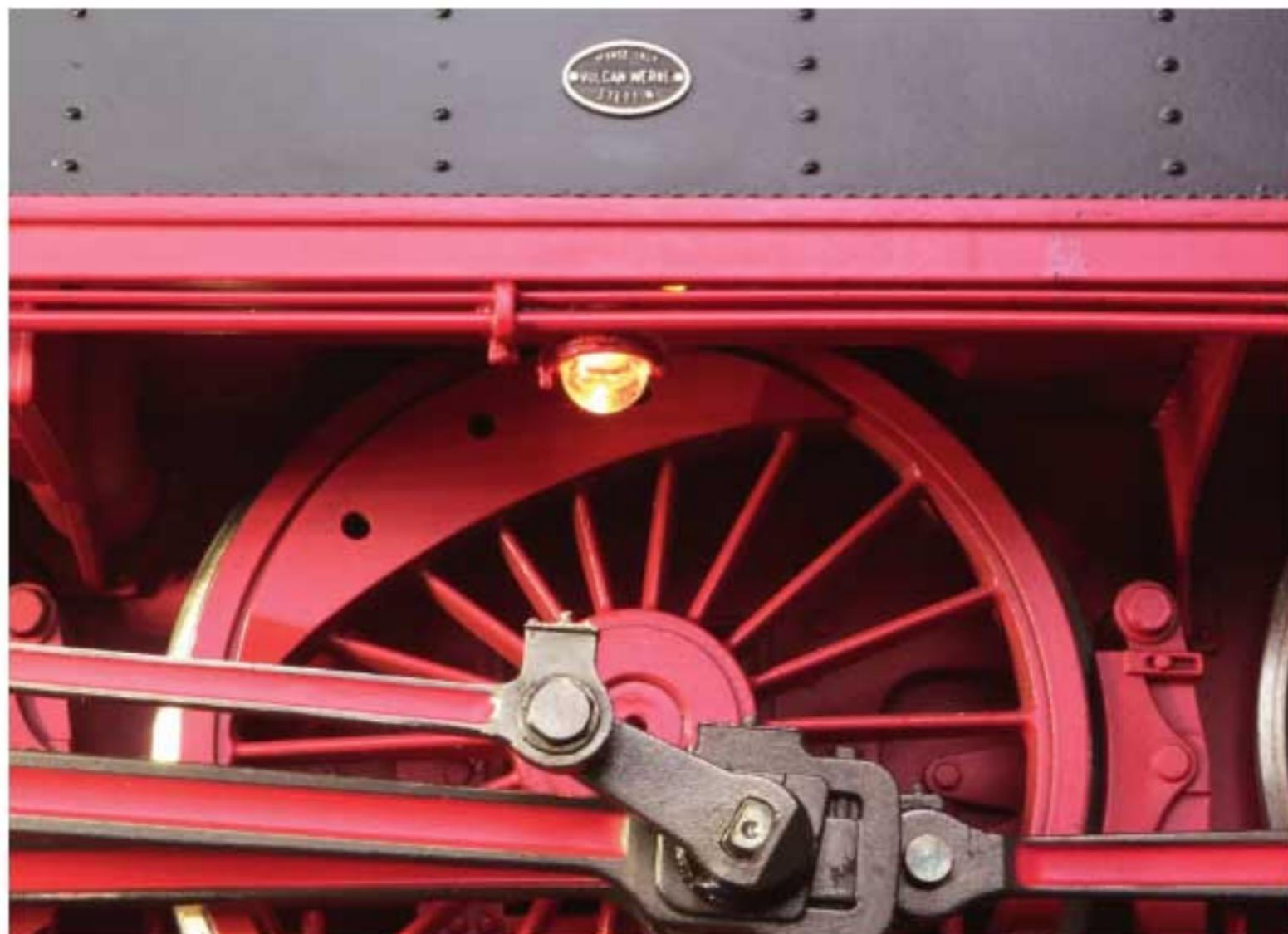
Über der digital schaltbaren Triebwerksbeleuchtung hat Märklin ein fein detailliertes und gut lesbares Fabrikschild angebracht.
