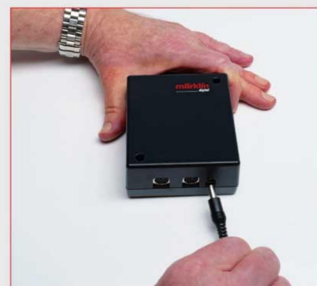
Eine Gleisbox (Art. 60116) kann bis zu zwei Mobile Stations 2 direkt aufnehmen. Die Buchse für das Netzteil befindet sich ganz rechts.
