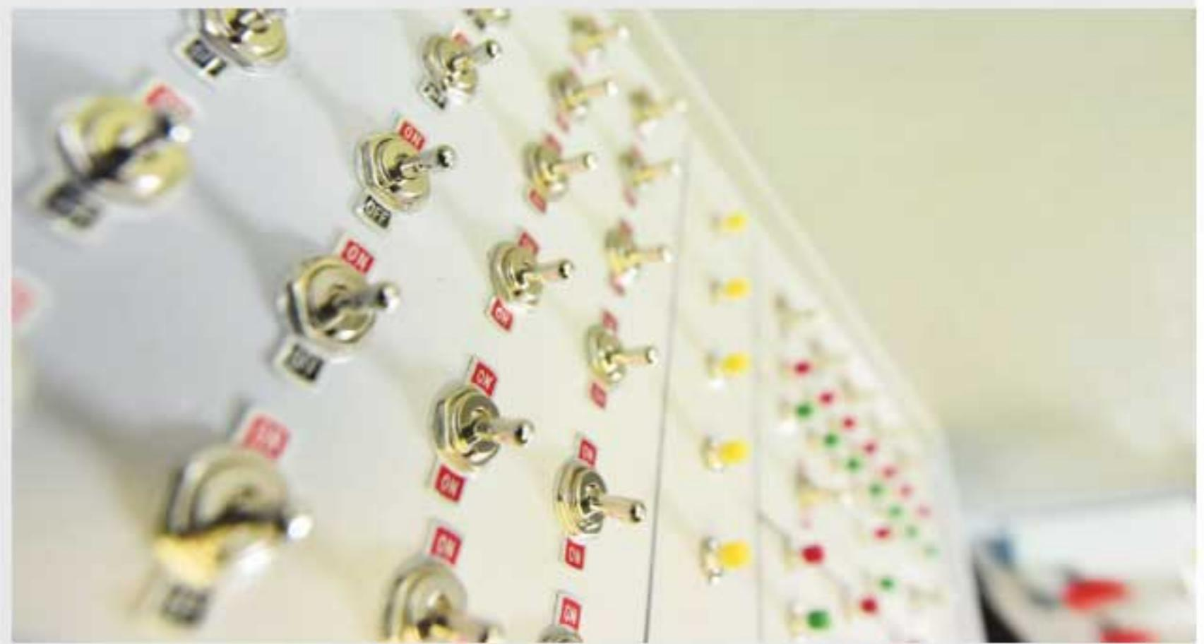
Während für die Schalter 13 bis 24 und 31 Exemplare in der Ausführung 2 x UM (=6 Lötpins) vorgesehen sind, genügen für die übrigen Schalter einfache Ein-/Ausschalter (= 2 Lötpins).
