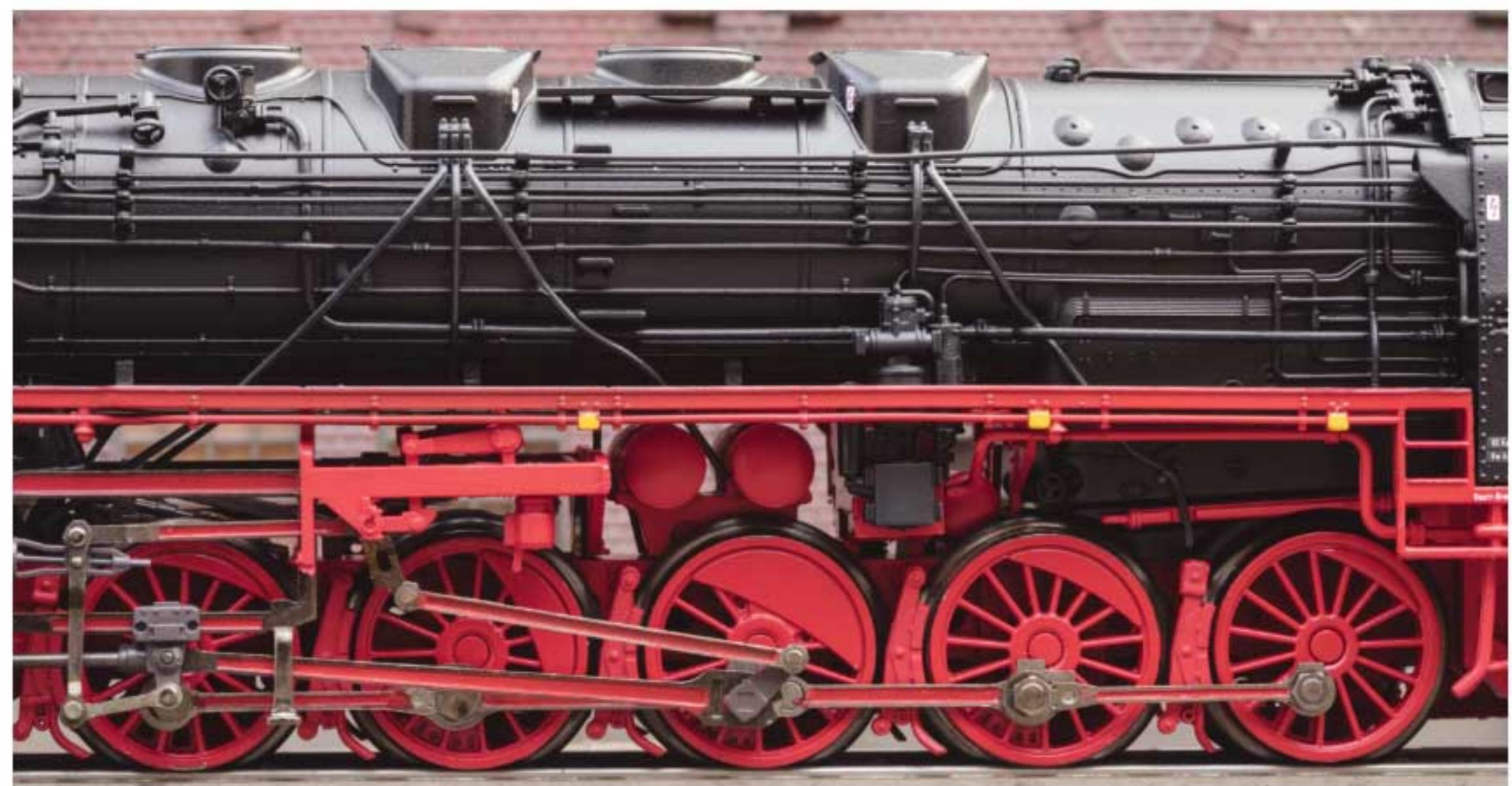
**Von der Seite gut erkennbar: Der durchbrochene Barrenrahmen bietet zwischen Kessel und Fahrwerk einen großzügigen Durchblick.**
