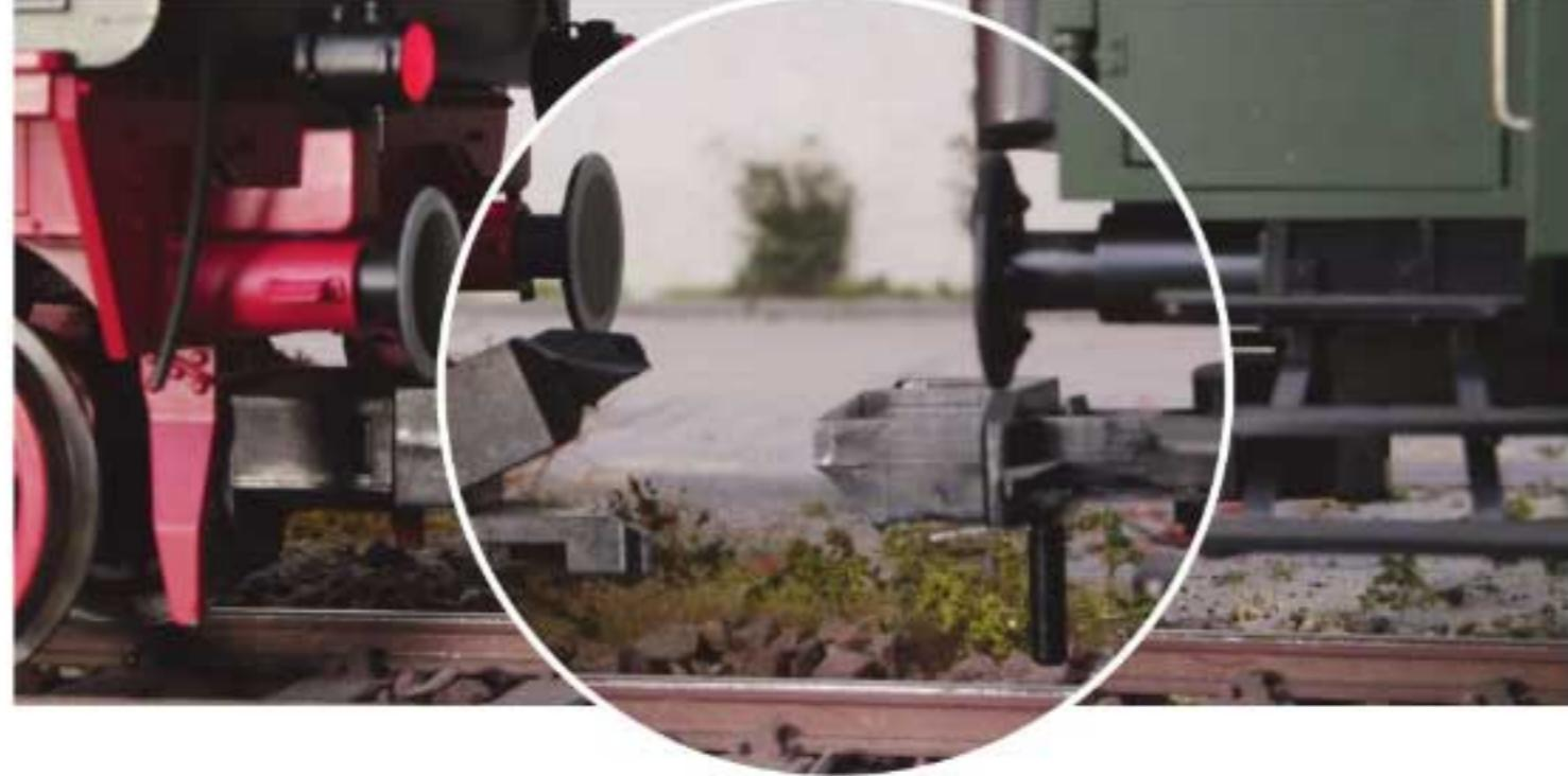
Für die Lokfront hat Märklin eine weitere Telex-Kupplung beigelegt. Am Lokende kann natürlich auch eine Schraubkupplung montiert werden.
