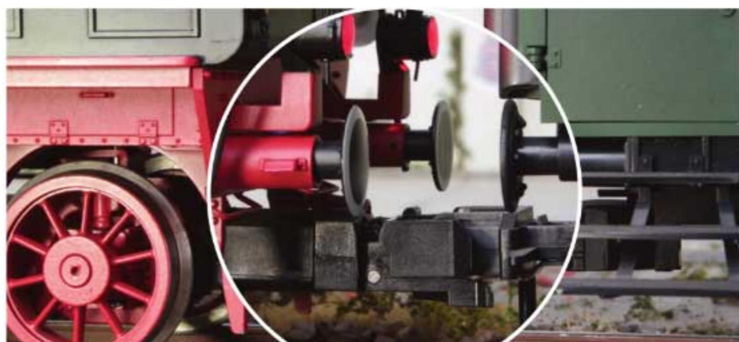
Die schlanke Telex-Kupplung am Lokende wird digital per f4 ausgelöst.
