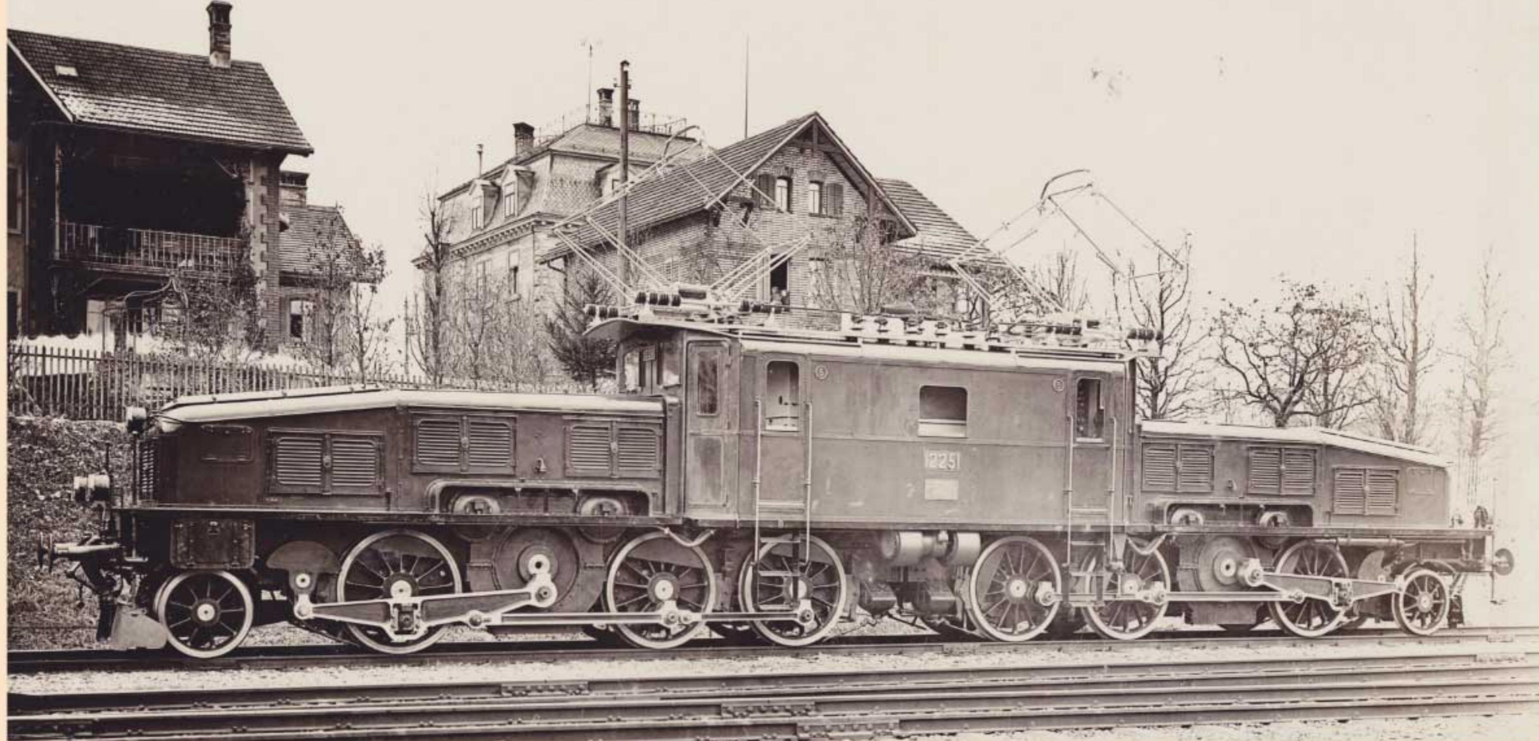
Absolut beeindruckend: das erste an die SBB ausgelieferte Krokodil – die Ce 6/8 II noch mit der Betriebsnummer 12251 (Aufnahme von 1920).
