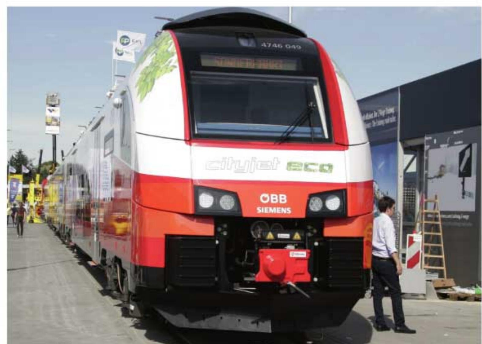
Überbrückt dank Akkumulatorenpaketen auch fahrleitungslose Abschnitte: der Desiro ML von Siemens – hier in der ÖBB-Ausführung.
