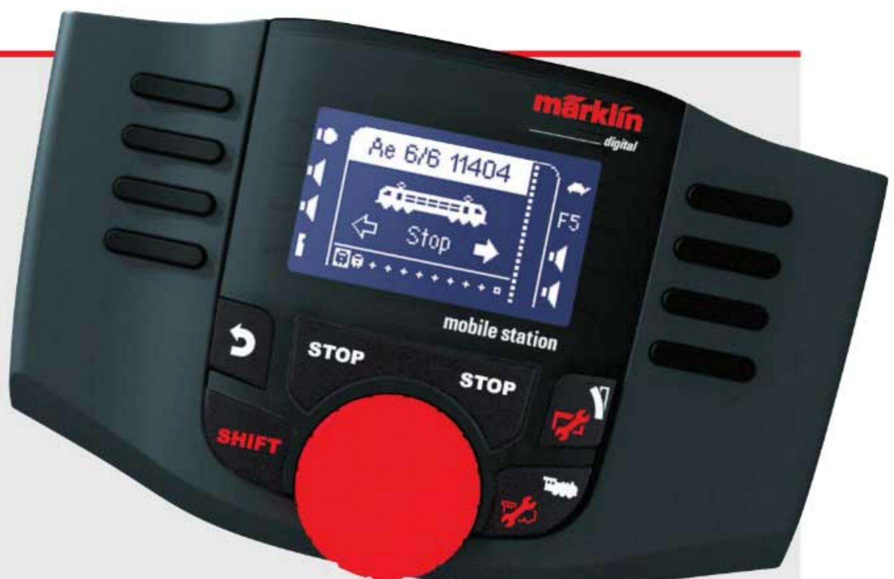
**Alles im Griff: Die Mobile Station ist ein überaus handliches Steuergerät, das Zugriff auf bis zu 40 Lokomotiven sowie deren Digital-Funktionen bietet.**
