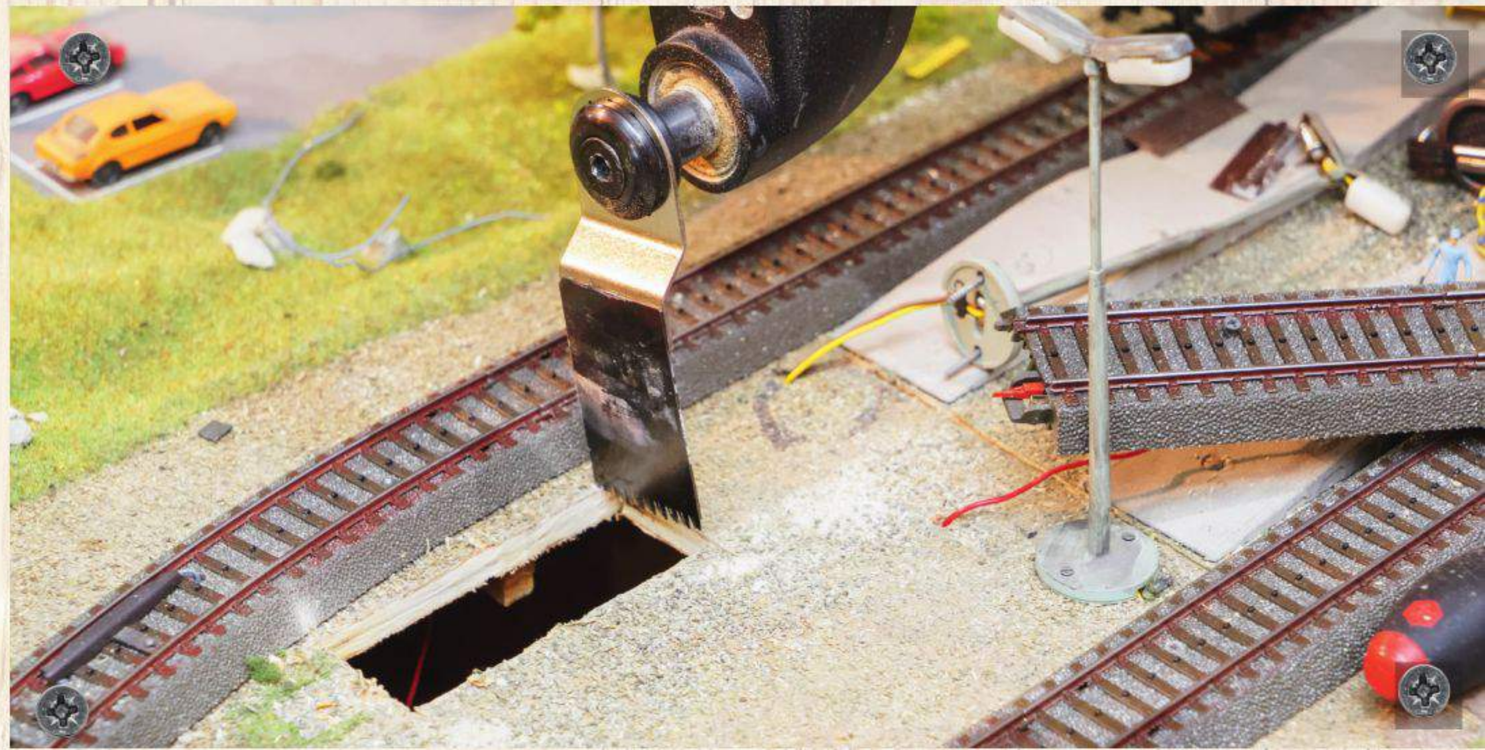
Da die Märklin Anlage von unten nicht gut zugänglich ist, erfolgt die „Unterflurmontage“ der Signale von oben. Dazu sägen wir ein rechteckiges Loch aus.
