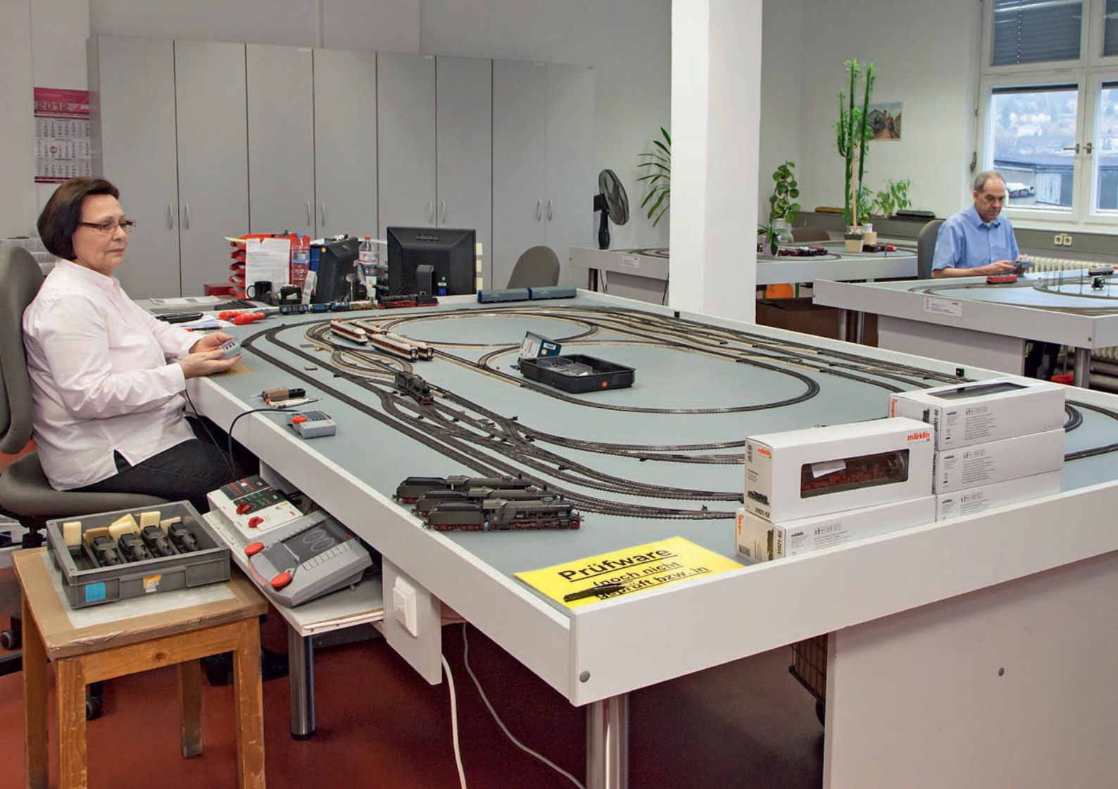
Audit-Raum: Maria Remy unterzieht Stichproben auslieferungsfertiger H0-Modelle einer Funktionsprüfung. Im Hintergrund testet Thomas Schork, Leiter Qualitätssicherung.
