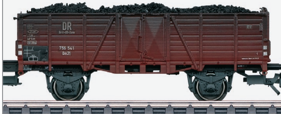
Om 21 Königsberg: Unter den Türen und dem jeweils angrenzenden Feld fallen Verstärkungen auf – und durch die Felder verlaufen kurze Diagonalstreben.
