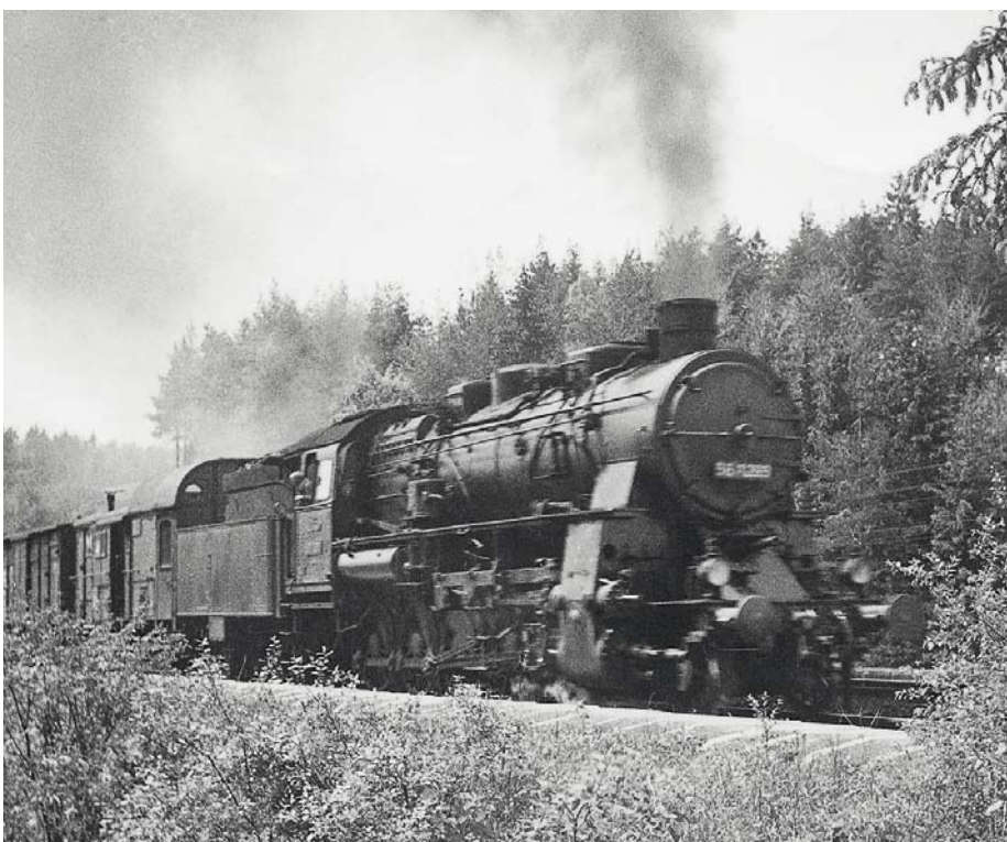
Auffällige BR 58: Die kleinen Höcker am Kessel oben vor dem Führerhaus verraten den eckigen Belpaire-Stehkessel – seine Form bot mehr Raum zur Dampfbildung.
