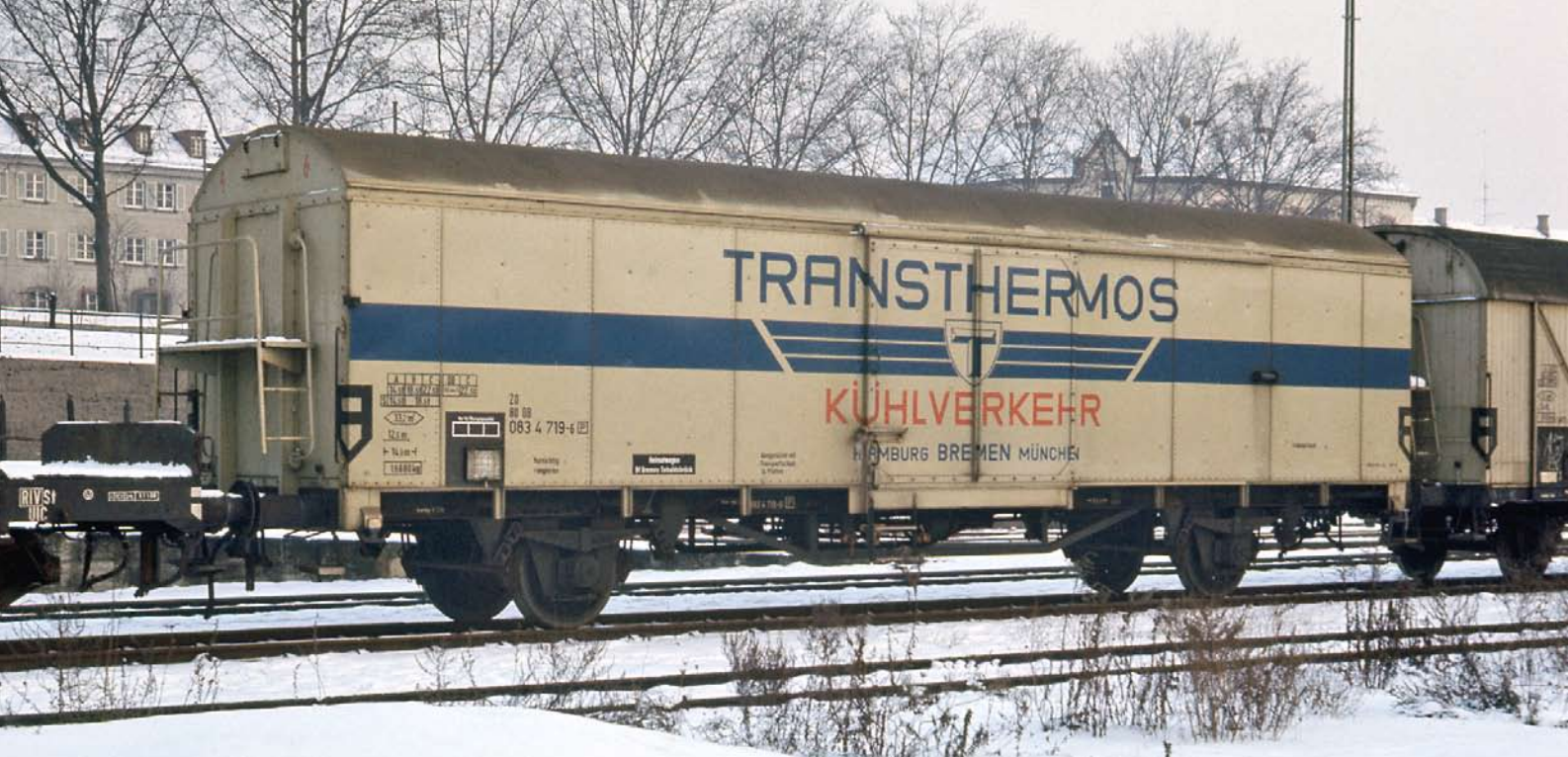
Insider-Jahreswagen in H0: Den mächtigen Kühlwagen der Bauart Ibbpls 379 mit Arbeitsbühne und Trockeneis-kanal hatte Transthermos von der DB gemietet.
