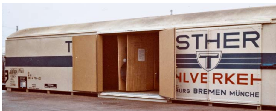
Einblicke: Hinter den aufgezogenen Schiebetüren des Ibbpls 379 öffnen sich Flügeltüren – die wärme-empfindliche Ladung wie Schokolade oder Margarine war stets gut isoliert.
