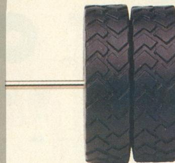
Manchmal ist Zwillingsbereifung erforderlich. Dann wird der zweite Reifen genauso aufmontiert.
