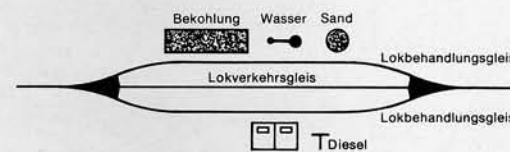
Lokbetriebswerk Bw mit Werkstattgleisen und Lokbehandlungsgleis. Das Zufahrtgleis darf nur von Loks befahren werden und wird Lokverkehrsgleis genannt.
