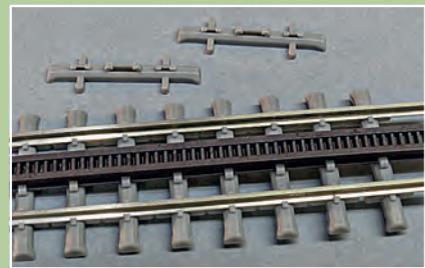
H-R-F Modellbahn Atelier hatte für H0m die Riggenbach-Zahnstange aus Kunststoff samt Stahlschwellen bis 2021 angeboten.
