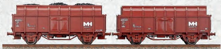
Roco: Für den effektiven Kokstransport mit maximaler Achslast erhielten die Wagen für die Maxhütte Sulzbach-Rosenberg spezielle Aufbauten.
