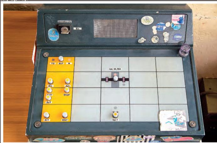
Im Stellwerks- oder Postenraum wird die Anrufschränke von einer schlüsselabhängigen Sprech- und Steuerstelle aus bedient.
