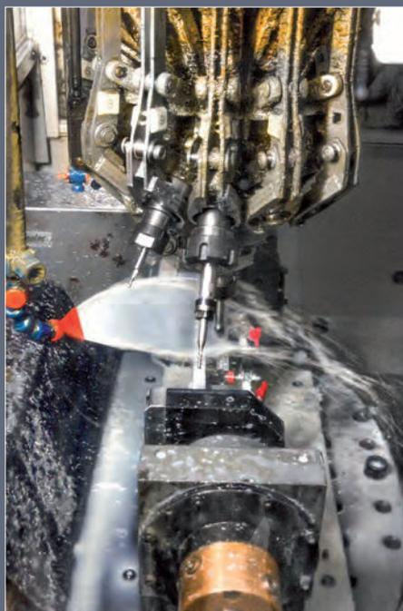
Im computergesteuerten Bohrautomaten werden gleich verschiedene Löcher gesetzt.
