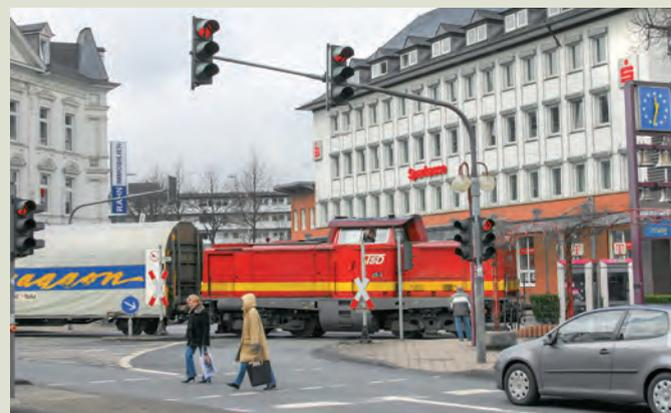
Im Zentrum von Gevelsberg kreuzt die Talbahn die B7. Die Sicherung des Überwegs direkt an der Straßenkreuzung erfolgt mit Ampeln.
