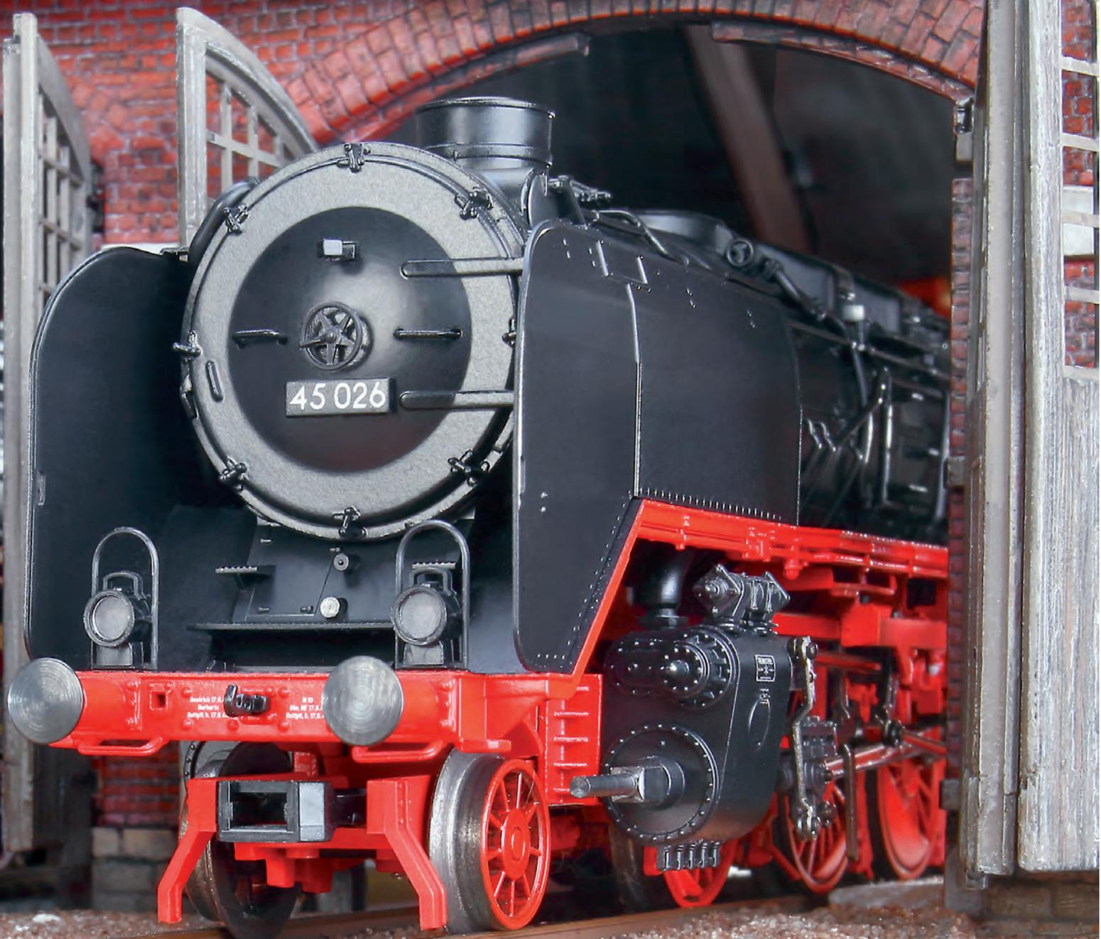
Bei Bahnfahrzeugen wird eine hohe, möglichst maßstäbliche Detaillierung von der Kundschaft gefordert. Dennoch sind die Zylinderblöcke bei allen Nachbildungen von Dampfloks in H0, TT, N und Z aus technischen Gründen bei der Steuerung zu breit. Auch die genormten Kupplungsaufnahmen sind wie hier bei den beiden 45 von Liliput und Märklin optisch sehr dominant.
