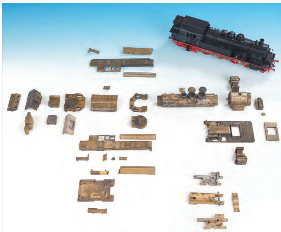
Alle Weißmetall- und Messingussteile der 78 benötigen Urmodelle aus Messing. Diese sind händisch hergestellt worden. Teilweise müssen die Teile zu Gruppen zusammengesetzt werden, um ein abformbares Gesamtteil zu ergeben. Verschiedene Lokvarianten sind so möglich.
