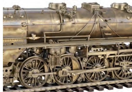
Steuerung und Räder sind kompletter Eigenbau. Auch am Kessel sind alle Leitungen aus Draht selbst angefertigt, lediglich die Handräder, einige Amaturen, sowie die Wasser- und Luftpumpen stammen von M&F.
