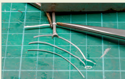
Das Schelleisen wird unter dem Kniestück angebracht. Zum Modellieren der Schraubenbefestigungen nutzt man Pinzetten.
