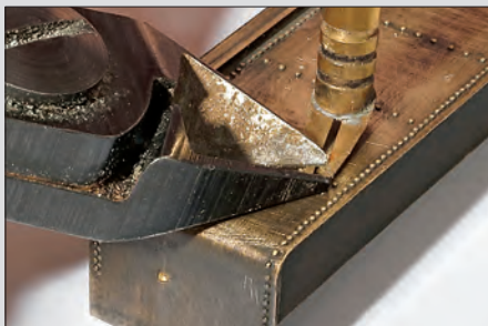
Der Abstandhalter sorgt beim Abtrennen des Drahtes für stets gleichlange Drahtenden.
