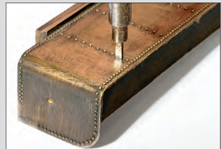
Mit einem leichten Schlag auf den Nietkopfsetzer erhält der Draht einen runden Kopf.
