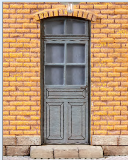
Am Gravurbild der Tür kann man die ungenügende Einstellung des Lasers erkennen.
