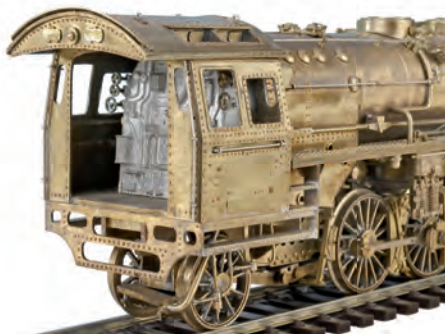
Der Stehkessel im Führerstand ist ein Weißmetallteil von M&F, alles andere sind selbst angefertigte Teile. Die Führerhauswände und das Dach sind gefräste Messingteile, in die die Nieten einzeln eingesetzt worden sind.
