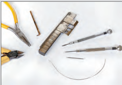
Für die Herstellung aller Niete hat Peter Drescher ausschließlich Messingdraht in kleine, 0,5 mm tiefe Bohrlöcher gesteckt.
