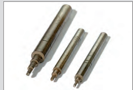
Zum perfekten Abrunden des in der Bohrung steckenden Drahtes fertigte er sich spezielle, nach innen gewölbte Nietkopfsetzer.
