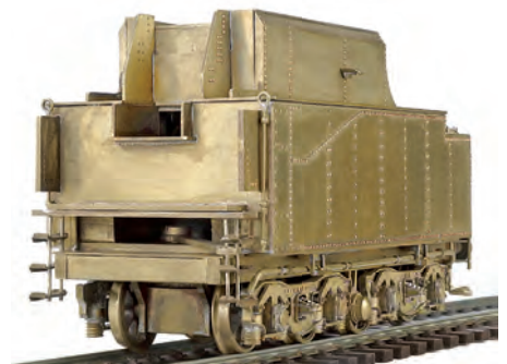
Die Blattfederpakete an den Drehgestellen sind einzeln verlötete Messingbleche. Die Lok-Tender-Kupplung ist konventionell als Deichsel ausgeführt und sorgt bei großen Gleisradien für einen engen Lok-Tender-Abstand.
