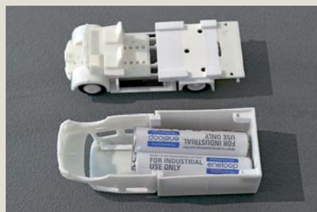
Die Modellbundesbahn benötigt dagegen zwei AAA-Akkus mit je 800mAh. Diese sind zu lang, deshalb weichen die Innenwände.
