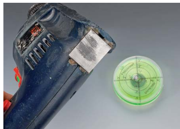
Eine Alternative bildet eine Dosenlibelle, die auf dem Rücken der Bohrmaschine aufgesetzt wird. Ein Magnet ist dabei sinnvoll.
