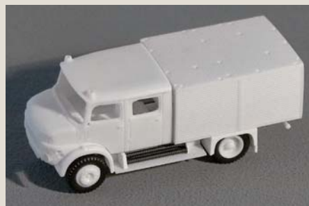
Der Brekina-Bausatz 10202 des MB LAF TLF 16 hat einen Kastenaufbau der Firma Metz und wird im Modell als Ziegler umgebaut.
