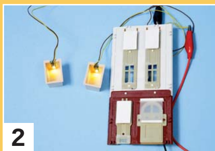
2 Die mit einer LED-Platine bestückten Kästen sollten vor dem Einbau getestet werden.
