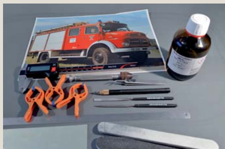
Die Werkzeuge zum DC-Car-Umbau: U.a. ein Messschieber, Leimzwingen, Bohrer 0,3 mm - 3,0 mm, Pinzetten und mehrere kleine Feilen.
