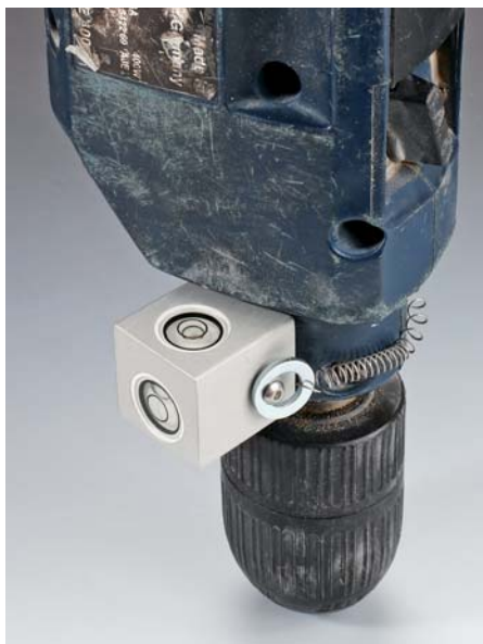
Man spannt den Libellenwürfel, beispielsweise bei Messtechnik Mollenkopf erhältlich, mit einer Spannfeder am Bohrhals fest.
