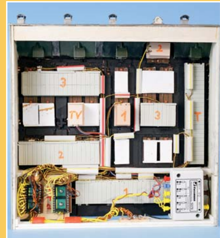
Die Hausbeleuchtungssteuerung sorgt für Abwechslung in den beleuchteten Räumen und hat als Zusatzfunktion auch noch eine TV-Simulation. Das so genannte Power-Modul von Viessmann wandelt ankommenden Wechselstrom in geglätteten Gleichstrom um und vermeidet zusätzlich das Flackern der LED. Trinkhalme bilden „Leerrohre“ und vermeiden den sonst anstehenden Kabelsalat.
