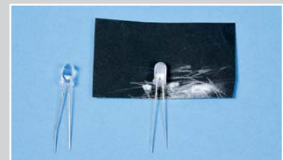
Durch das Schleifen einer glasklaren LED mit feinem Schleifpapier (600-800) lässt sich der Lichtaustrittswinkel vergrößern.
