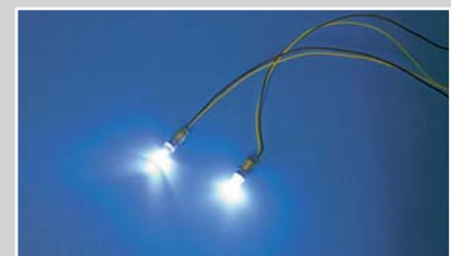
Der Direktvergleich zeigt den veränderten Lichtkegel nach dem Schleifen: links eine Original-LED, rechts die mattgeschliffene.
