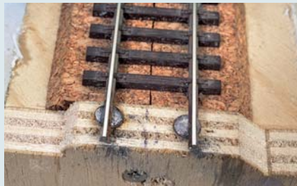
Zwei auf Nägel am Modulübergang aufgelötete Gleisprofile genügen zur Stabilität.
