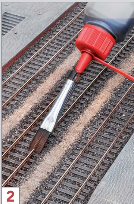
2 Zum Verteilen der Farbbeize direkt aus der Druckflasche dient ein Flachpinsel. Der erhält ein Aufsteckloch bis zu den Pinselhaaren.
