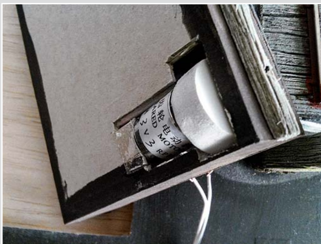
Auf der Unterseite sieht man den motorisch langsam sich drehenden Hebe-mechanismus. Diese Exzentrerscheibe sorgt durch Abheben der Schute von der Grundplatte für die Schaukelbewegung.
