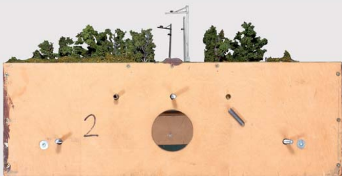
Zwei Bolzen in fest verbauten Buchsen sorgen für Passgenauigkeit, während drei Schrauben die Modulverbindung festziehen.
