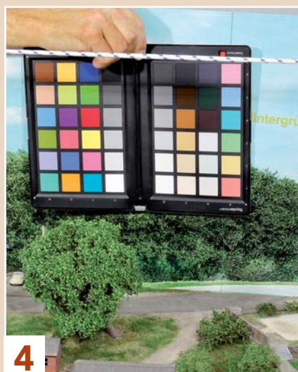
4 Eine Farbkarte sorgt beim Fotografieren für die korrekte Farbwiedergabe im Computer.
