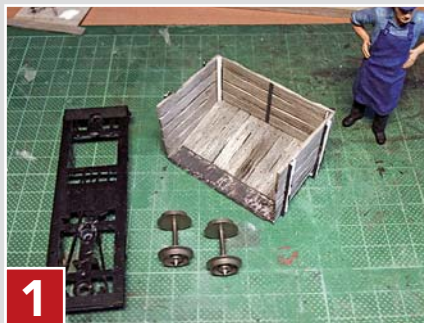
1 Der Schüttkasten ist komplett selbstgebaut und ruht später mit Seitengestell auf dem hier noch ungekürzten H0-Fahrwerk.
