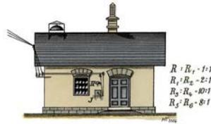
An einem Blockstellenhaus konnte das Glockenwerk auch auf dem Dach sitzen. Der Anschluss endete in einem Wandkasten.
