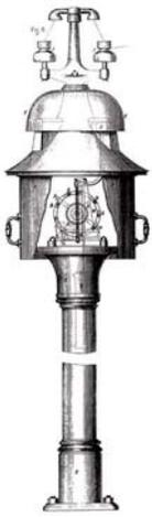
Aufbau der aus Blech und Gussteilen gefertigten Glockensäule von Siemens und Halske, die um 1874 fertig entwickelt war.
