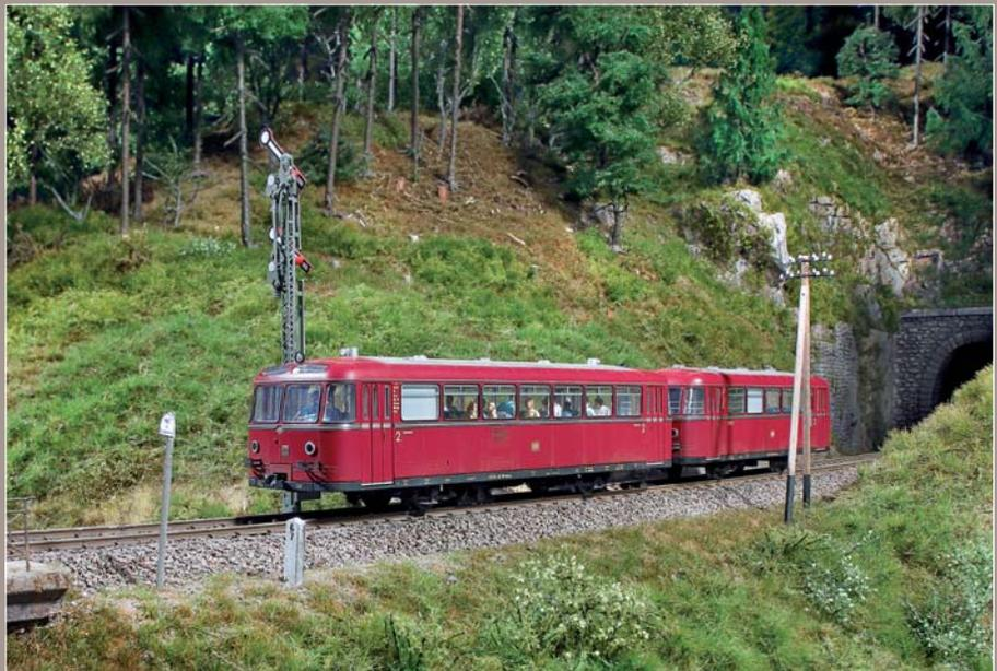
Der dieselangetriebene VT 95 besitzt als Motorwagen nur eine angetriebene Achse und zwar die vordere. Er erhält deshalb die simple Achsformel A1.
