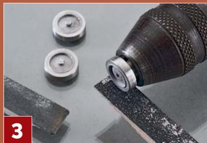
3 ... so dass man sie am überstehenden Zapfen an der Radvorderseite in ein Bohrfutter spannt, dieses mit der Hand dreht und die Laufflächen sauber nachschleift.
