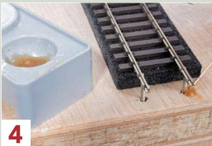
**4** Ist das Gleisende perfekt ausgerichtet, wird es mit Zweikomponentenkleber fixiert.
