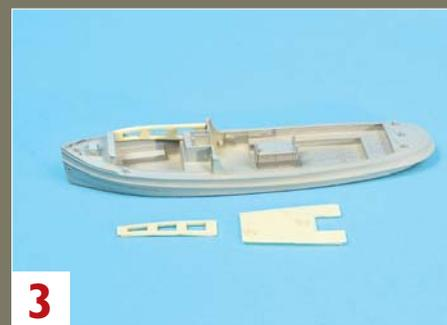
3 Nach der Grundierung beginnt man mit dem Zusammenbau der Wände des Deckhauses und mit der Innenraumnachbildung.
