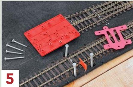
**5** Nun können die drei M3-Senkkopfschrauben in den Bohrlöchern positioniert werden.
