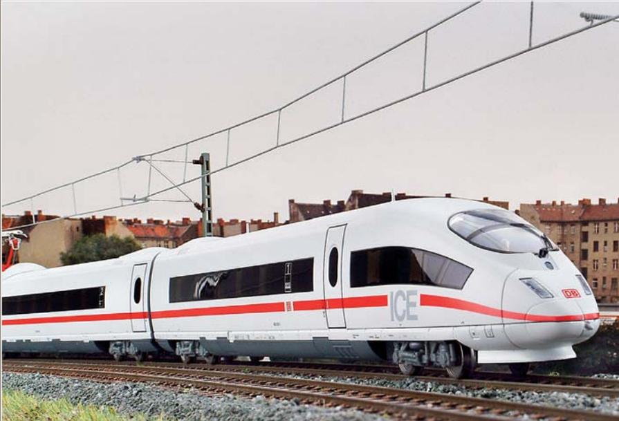
Das Flaggship der DB für den Fernverkehr, der ICE 3 (BR 403/406), hat über den ganzen achteiligen Zug verteilte Antriebsachsen und hat deshalb eine endlose Achsbezeichnung.
