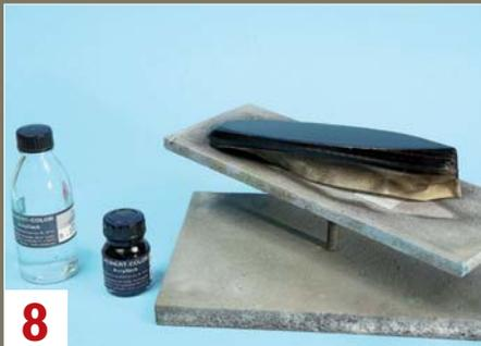
8 Nach gründlicher Reinigung wird der abgeklebte Rumpf mit einer Spritzpistole glänzend schwarz (Acrylfarbe) lackiert, ...
