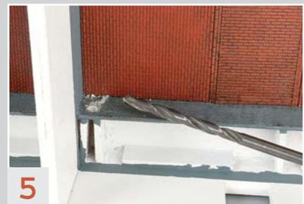
**5** Den Zulauf vom Wassergang in die Tröge simuliert man mit einer leichten Vertiefung auf Troghöhe. Ein 4,3-mm-Bohrer hilft dabei.
