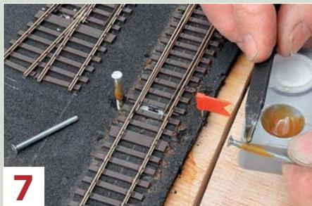
**7** Die Schrauben werden oben mit Zweikomponentenkleber zur Befestigung satt bestrichen.
