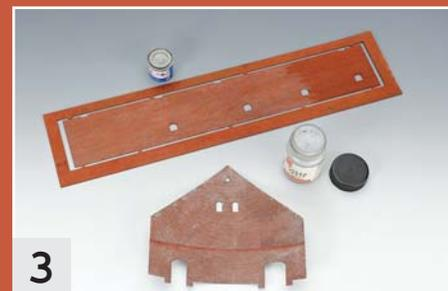
3 Die Acrylfarbe verläuft in den Fugen und wird anschließend mit Verdünnung von der Fläche weggewischt. Nicht geeignet ist Fugenspachtel.
