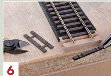
**6** Die zwei Endschwellen müssen zerschnitten und einzeln aufs Holz aufgeklebt werden.
