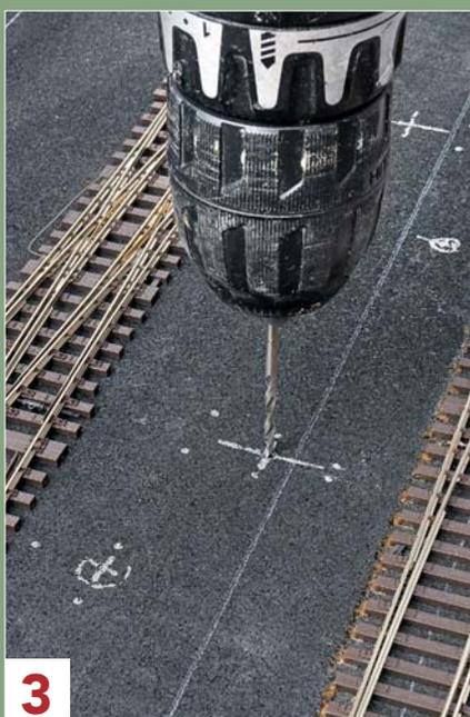
**3** Mit einem 3-mm-Bohrer entstehen alle Löcher an den festgelegten Markierungen.
