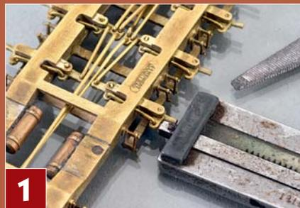
1 Die Achsaufnahmen werden am Gussast etwas länger abgezwickt und erst vor dem Einbau der zwölf Räder exakt auf eine Länge von 2,5 mm gefeilt.
