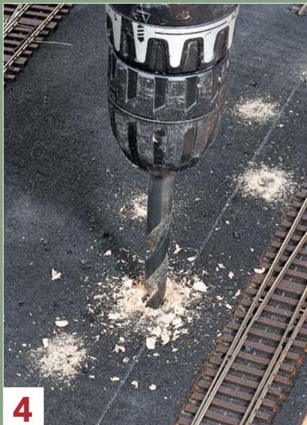
**4** Anschließend weitet man mit einem 10-mm-Bohrer die beiden Löcher der Stellstangen.
