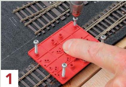
**1** Die Bohrschablone ist das A und O beim Motoreinbau. Holzschrauben fixieren sie.
