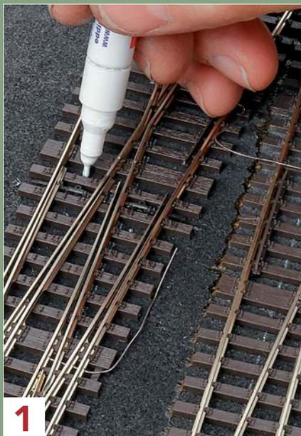
**1** Mit einem Filzstift markiert man die Stromzufuhren und die Löcher für die Stellstange.
