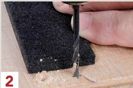
**2** Für die beiden Gewindestangen werden zwei passende Löcher in das Anlagenholz gebohrt.
