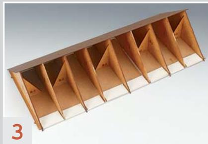
Weitere selbst angefertigte Stützen und Klebekanten an der Grundplattenkante sorgen später für eine verzugsfreie Dachplatte.
