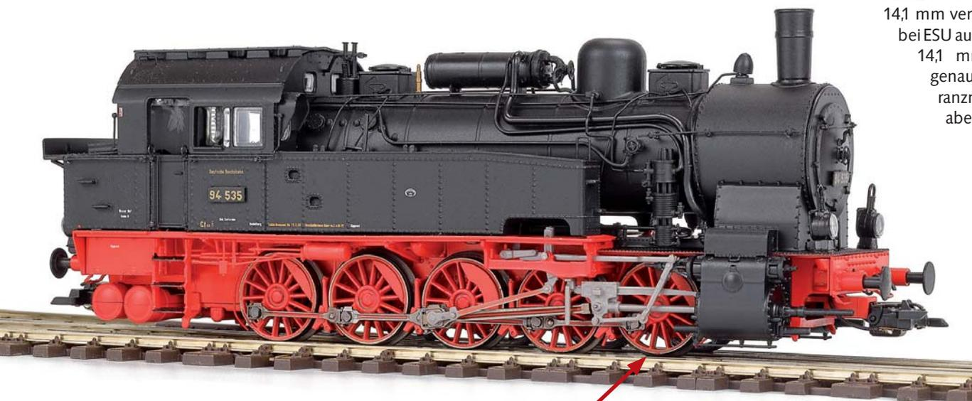
Sobald die ESU-Lok den engen Bereich der Schienenkreuzung erreicht hat, klettern die zu engen Räder auf das Gleisprofil und die Lok entgleist.
