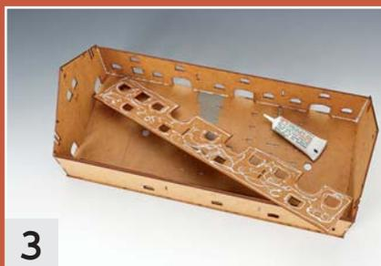
3 Die zusätzlichen Längswände, beides Ersatzteile, werden vor dem Kleben beidseitig um das Maß der Materialdicke gekürzt.
