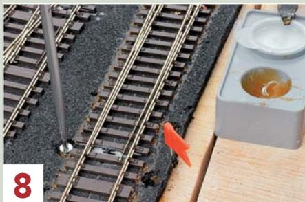
**8** Sorgsam dreht man die beklebten Schrauben in die Löcher und versenkt den Kopf im Holz.
