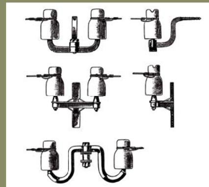
Halter konnten in Holz eingeschlagen oder an Wänden verschraubt werden.
