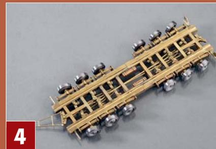
4 Bei den nur provisorisch aufgesetzten Rädern erkennt man, dass die Lenkung der Räder sie zu den Fahrzeugenden hin immer stärker ausschwenken lässt.
