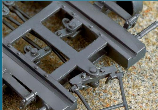
Je nachdem, wie die Deichsel eingeschlagen wird, übertragen die unterschiedlichen Stellstangen den Rollradius auf die Räder.
