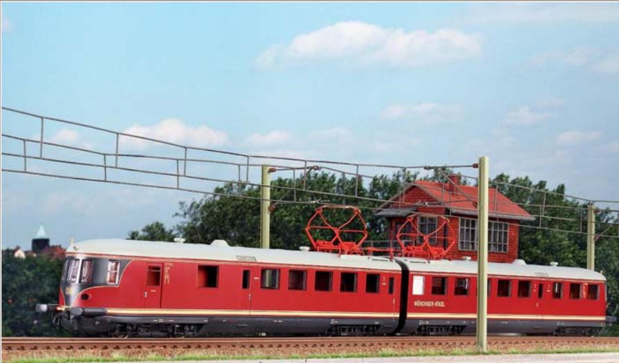
Der zweiteilige ET 11 besitzt zwar vier Zweiachs-Drehgestelle, aber nur zwei davon werden angetrieben. Die Bezeichnung lautet bei diesem Schnelltriebwagen Bo'2'+2'Bo'.
