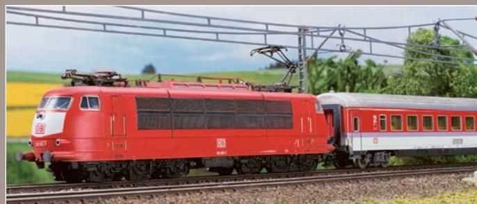
Alle Achsen der 103 besitzen einen Einzelantrieb, weshalb man der Schnellzuglok mit ihren zwei Drehgestellen die Bezeichnung Co' Co' gab.
