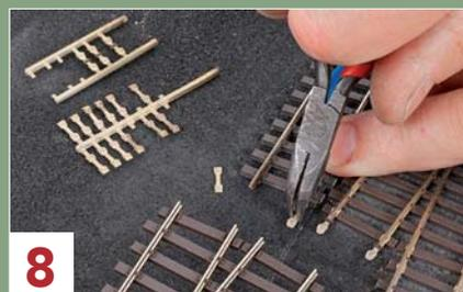
**8** Auf die Nachbargleise schiebt man zuerst die jetzt erforderlichen Schienenverbinder.
