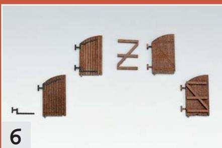
6 Zuerst verklebt man die dünnen Türbänder in den vorgegebenen Vertiefungen, dann folgt auf der Innenseite die z-förmige Türversteifung.
