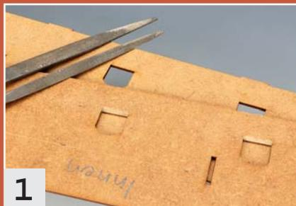
1 Stark vom Bausatz abweichend erhalten die Längswände eine Mauerverdoppelung. Die Fensterunterkante wird unten angeschragt.
