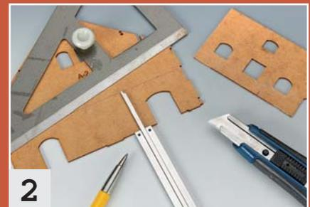
2 Für einen späteren Zwischenboden legt man mit einer leichten Schnittfuge die Höhe der zu montierenden Längsbalken fest.
