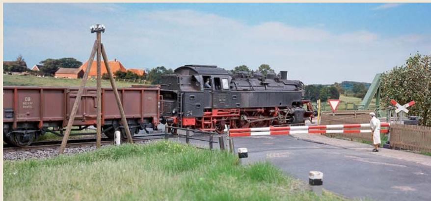
Ein nach beiden Gleisrichtungen abgestützter Mast ist ein Festpunktgestänge mit einer oder zwei Abstützungen. Er steht als siebter bis zehnter Mast zur Zugentlastung.
