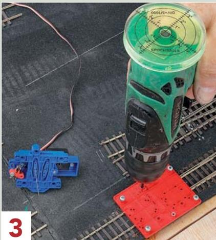
**3** Senkrecht von oben und mittels einer Wasserwaage werden die Löcher gebohrt.
