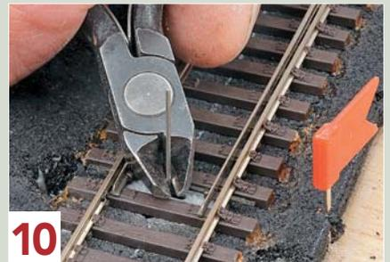
**10** Den oben überstehenden Stelldraht des Weinert-Motors schneidet man bündig ab.
