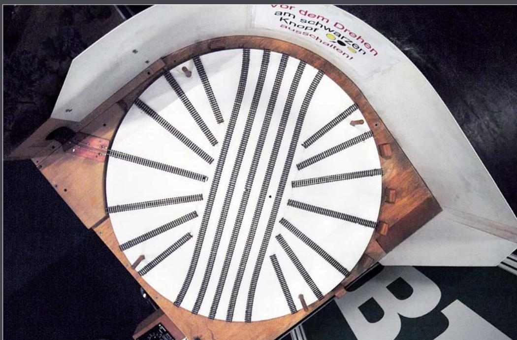
Etwas aufwendiger gestaltet sich der Bau einer großen Drehscheibe, die mit Gleisen belegt ist, die genau zum Einfahrtsgleis ausgerichtet sind. Hier können die Züge und Loks schnell und bequem gewechselt werden.
