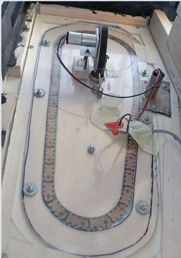
Die Grundplatte mit Kette von unten. Gut erkennbar ist die Verschraubung.
