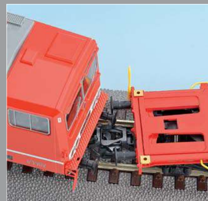
In engen Kurven tritt beim Schieben eine unerwünschte Pufferverkantung auf.
