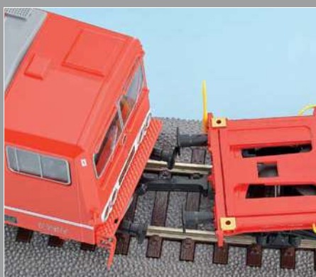
Beim Schieben der Wagen berühren sich trotz Kupplung in vielen Kurven die Puffer.
