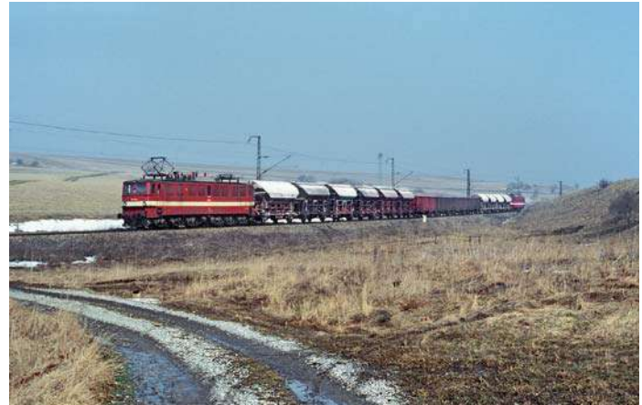
Es müssen nicht immer lange Züge sein, wenn nachgeschoben werden muss, wie das Beispiel der Rübelandbahn zeigt: Der kurze Güterzug wurde nicht nur von der eigens konstruierten Elektrolok 171 gezogen; eine zweite 171 bot ihre Schubhilfe am Zugschluss an.
