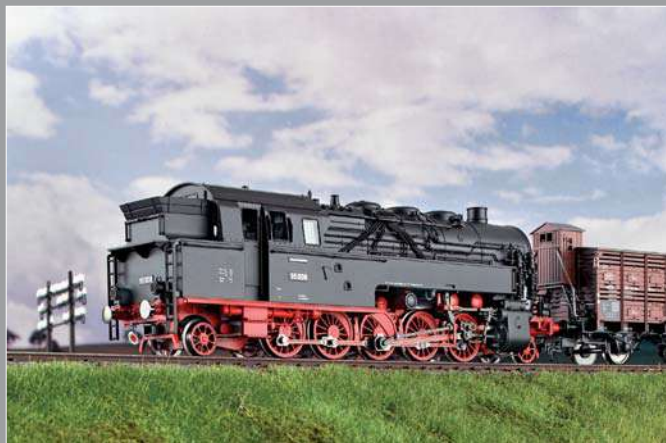
Die (hier rote) Schluss Scheibe am Puffer kennzeichnet die 95 (H0-Modell von Fleischmann) eindeutig als Schiebelok am Zugende.
