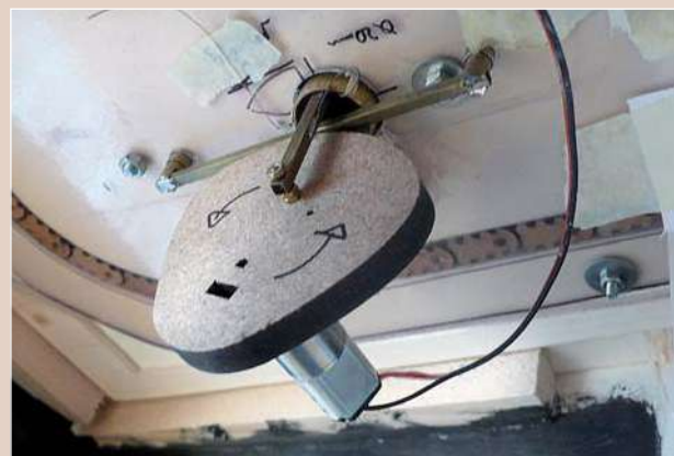
Der unterhalb des U-Bootes installierte Motor mit Unwuchtscheibe und Schieber.
