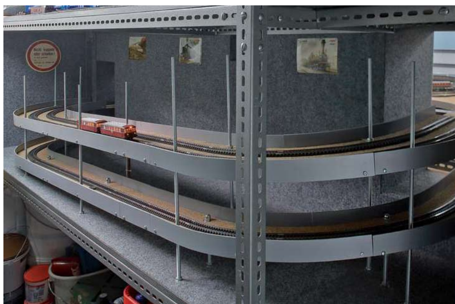
Um versehentliche Fahrzeugabstürze zu vermeiden, montiert man seitlich eine Blende.
