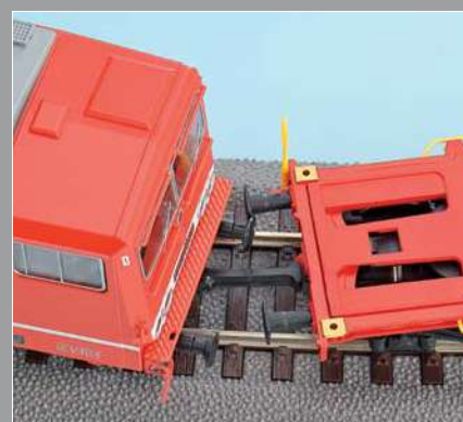
Fallen die Kurven eng aus, drückt sich der schiebende Puffer hinter den anderen.
