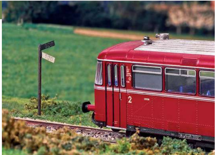
Am Scheitelpunkt der Steigungsstrecke stand früher ein Neigungsanzeiger mit den Angaben der Neigungen in Verhältnissen.
