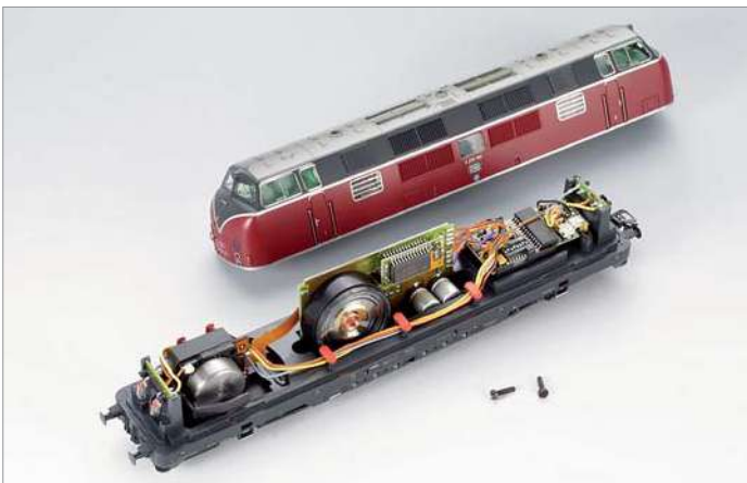
Die Diesellok V 200 von Märklin in H0 treibt nur ein Drehgestell mit ihren beiden Achsen an. Strom erhält es vom zweiten Drehgestell. Dank Druckgussgehäuse hat das Modell ordentlich Gewicht.
