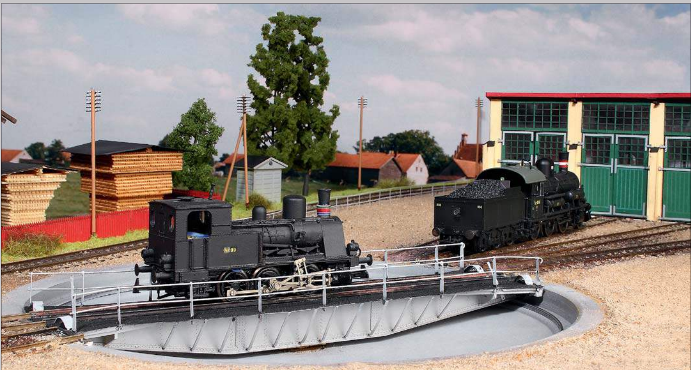
Länderbahndreh scheiben haben einteilige Bühnen, deren ganze Last auf dem Königstuhl ruht. Diese dänische stammt von Epoke Modeller.
