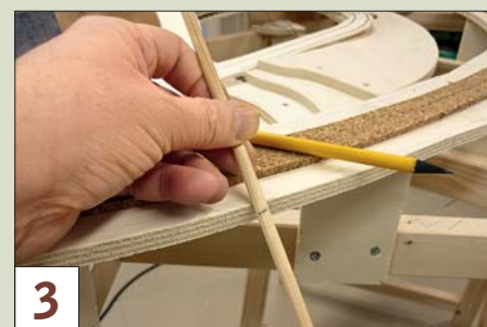
3 Die jeweilige Länge der einzelnen Streben bestimmt man am schnellsten durch Anhalten und Markieren mit einem Bleistift.
