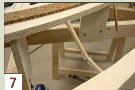
7 Die Durchmesser der Hüllen sind auf die Holzstäbe abgestimmt, so dass diese nur in die Hüllen eingesteckt zu werden brauchen.
