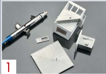
1 Der weiße Haftgrund mit der Bezeichnung Allgrund von Euro Top wurde mit einer feinen Spritzpistole deckend aufgetragen.
