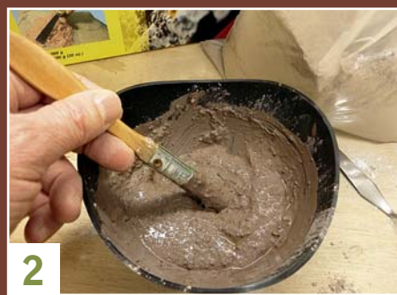
2 Die Spachtelmasse wird entsprechend der beiliegenden Anleitung in einem flexiblen Gipsbecher mit Wasser sämig angerührt.
