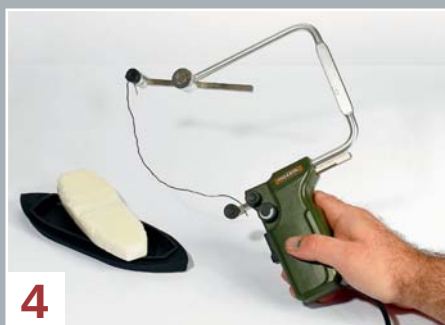
4 Mit dem flexiblen Draht von Proxxon kann man sehr gut die Konturen herausarbeiten.
