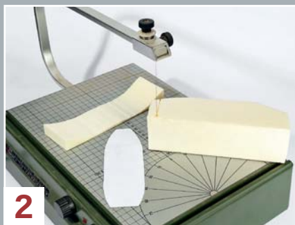
2 Aus Styrodur entsteht nach dem Übertragen der Ladungsform der Grundkörper.
