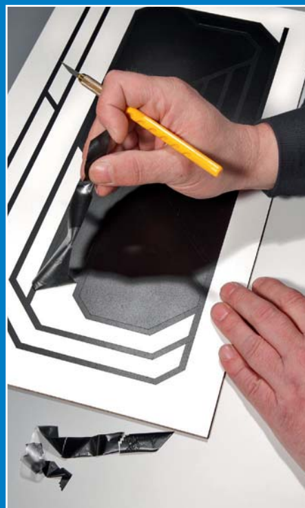
Mit Hilfe einer Abdeckfolie können größere Flächen vor der Sprühfarbe geschützt werden. Da sie schneidbar ist, lassen sich mit einem Skalpell individuelle Motive erstellen.
