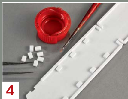
Die Sitzgruppen werden später auf 2 mm starken Polystyrolsockeln verklebt, die jedoch jetzt auf den Boden geklebt werden.
