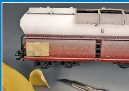
Die anstehende starke Verschmutzung des Kalktransportwagens benötigt die Abdeckung des Schriftfeldes mit Klebeband.
