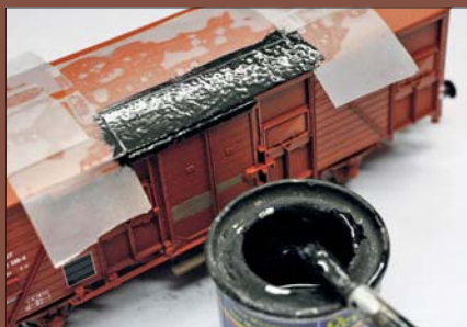
Für die Andeutung reparierter Dachpartien werden mit Klebestreifen Flächen abgegrenzt, um Mattschwarz aufzutupfen.
