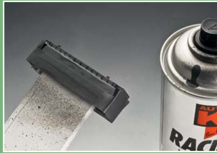
Kleine Bauteile fixiert man auf griffigen Halterungen wie hier einem langen Plastikstreifen, um sie rundum spritzlackieren zu können.
