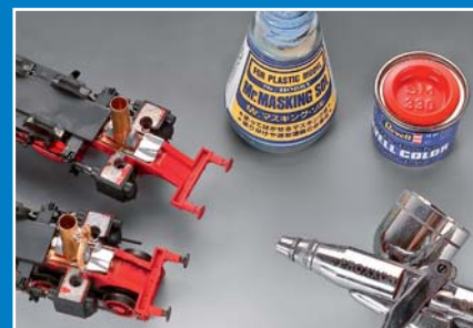
Abdecklack ist beim Lackieren von Fahrzeugpuffern sehr hilfreich. Wenn der Lack trocken ist, wird das Latex abgezogen.
