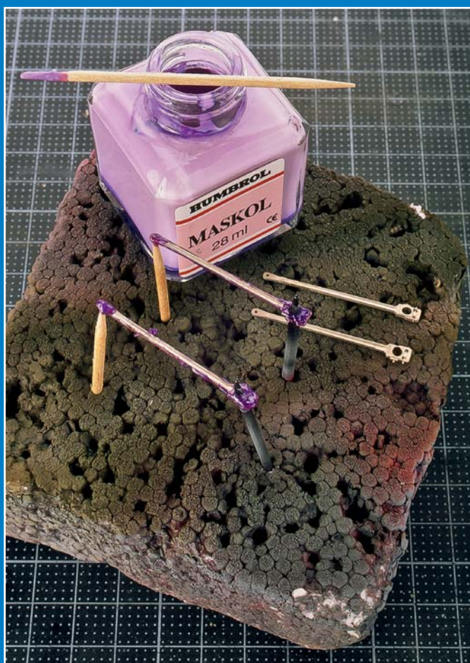
Die Bereiche einer Dampfloksteuerung, die nicht spritzlackiert werden sollen, schützt man am einfachsten mit einem Abdecklack.
