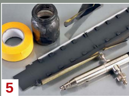
Sind die Warmluftschächte silbern lackiert und abgedeckt, folgt eine Spritzlackierung der Bodenfläche in dunklem Graubraun.
