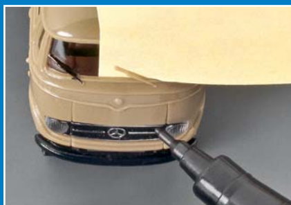
Manchmal reichen einfache Hilfsmittel wie ein Stück Papier zwischen Scheibenwischer und Scheibe, um das Übertreten der Farbe auf ein anderes Teil zu vermeiden.
