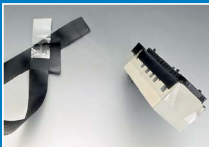
Sauberes Abkleben bereits lackierter Partien mit geeignetem Klebeband sorgt für das Gelingen von mehrfarbigen Lackierungen wie hier am Aufbau eines Behelfsstellwerks.
