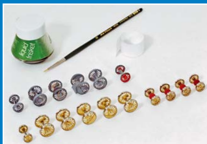
Die Laufflächen von Eisenbahnradern lassen sich mit Abdecklack bedecken, während das Klebeband die Achsen schützt.
