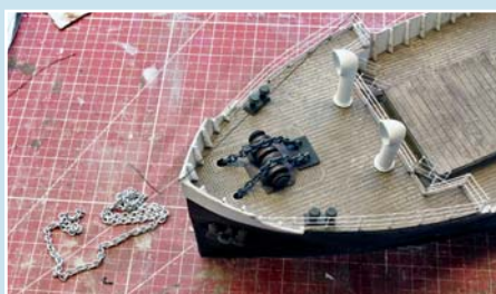
Die Ankerkette wird schwarz lackiert und in die Öffnungen an der Bugspitze versenkt.
