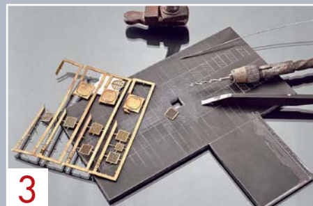
3 In der Mitte der Wanne entsteht eine Öffnung für den Ablauf. Die Abdeckung erfolgt mit einem geätzten, quadratischen Gullydeckel.
