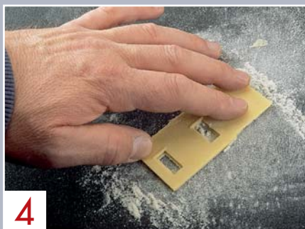
4 Resinbauteile sind mit Übermaß gegossen. Sie sind rückseitig auf einem plan liegenden Schmirgelbogen auf Maß zu schleifen.
