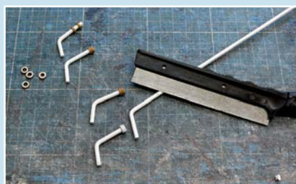
Die Davits für die Rettungsboote werden aus ABS-Material gebogen und abgelängt.
