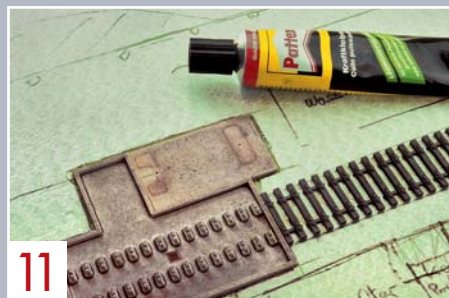
11 Das Einkleben der Wanne sowie das Fixieren der Schwellenroste erfolgt mit einem verträglichen Kontaktkleber wie Pattex.
