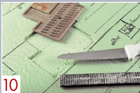
10 Beim Schaustück wird die Einbaufäche der Wanne mit Messer und Raspel sauber aus dem Styrodur-Unterbau herausgearbeitet.
