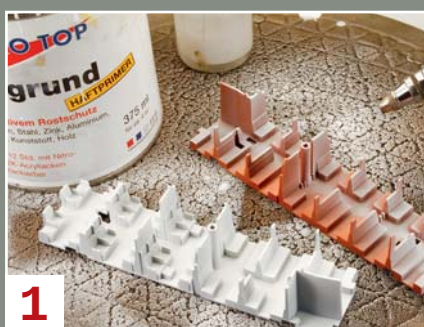
1 Die Basis für die nachfolgende Farbgebung bildet eine weiße Spritzlackierung des Einsatzes mit neutralem Haftgrund.
