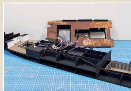
Der Einbau der elektrischen Leitungen für die Beleuchtung erfolgt beim Rohbau.
