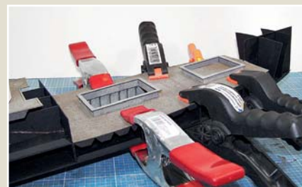
Mit großen Klammern wird das Oberdeck auf den Spanten beim Festkleben fixiert.
