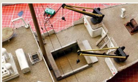
Die fertigen, drehbaren Heckkräne haben über der offenen Schiffs Luke Platz gefunden.
