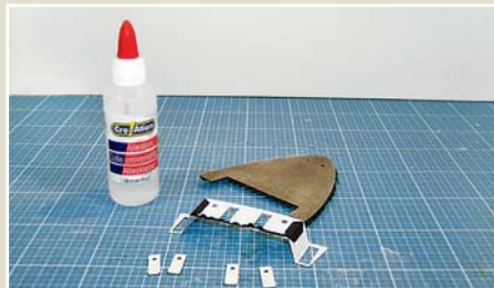
Mit Haftkleber auf Acetonbasis werden die zahlreichen Kartonteile stabil verklebt.
