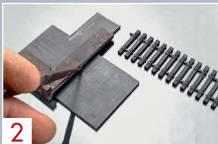
2 Die exakten Schwellenabstände werden vom Gleisjoch abgenommen und mittels einer Reißnadel auf dem Wannenboden markiert.
