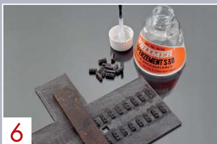
6 Die Schwellensockel werden auf die markierten Bereiche geklebt, wobei ein Anschlagwinkel die korrekte Ausrichtung garantiert.
