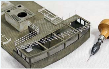
Mit einem 0,5-mm-Bohrer werden im Deck die Löcher für die Relingstützen gebohrt.
