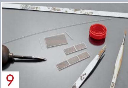
9 Die Einfassungen der Laufroste entstehen aus dünnen L- und Flachprofilen aus dem Sortiment von Evergreen.
