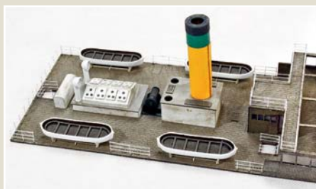
Das Oberdeck wird fertig detailliert, bevor es auf den Schiffsrumpf aufgesetzt wird.
