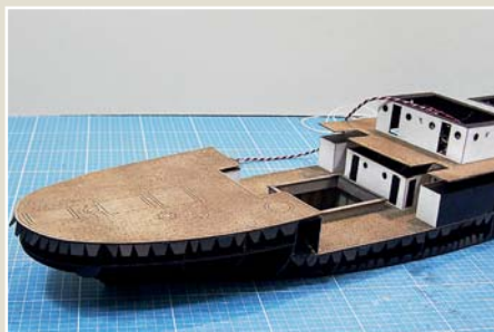
Das eingebaute Oberdeck des Hecks sitzt fest verklebt auf den inneren Rumpfspanten.
