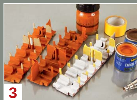
3 Nachdem die oberen Wandbereiche vollständig abgedeckt sind, folgt die Lackierung der Sitze im gewünschten Farbton.
