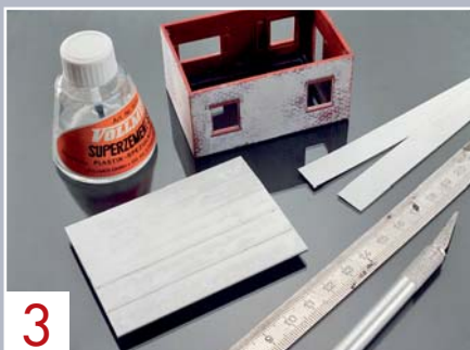
3 Einzelne Teerpappbahnen lassen sich mit etwa 10 mm breiten aufgeklebten 0,15-mm-Polystyrolstreifen darstellen.
