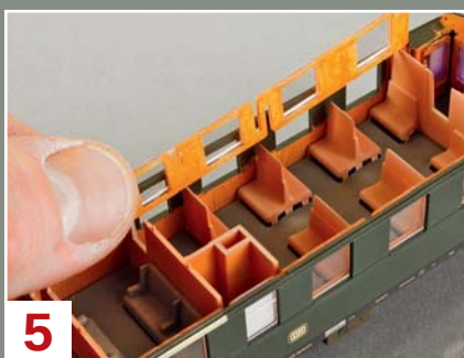
5 Der Inneneinsatz ist fertig lackiert und eingesetzt. Erst jetzt lassen sich die ebenfalls bemalten Fensterbänder einrasten.
