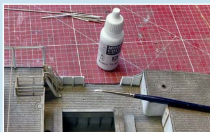
Mit weißer Farbe und feinem Pinsel werden die Laserkanten der Spanten bemalt.
