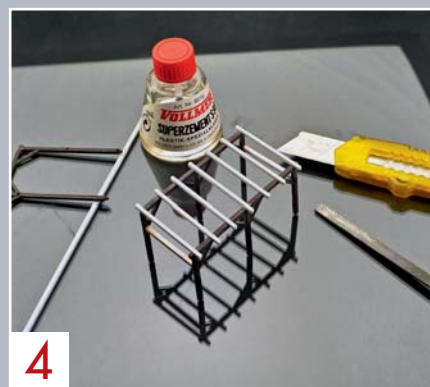
4 Die Überdachung des kleinen Schmierstofflagers entsteht aus Kibri-Bausatzresten und 1,5x1,5-mm-Evergreen-Profilen.
