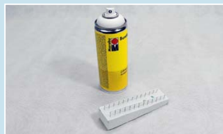
Weißer Farbe lässt die fertige Messing-Reling nach der Grundierung edel erscheinen.
