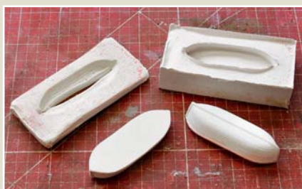
Mit einer zweiteiligen Silikonform entstehen beliebig viele Abgüsse des Rettungsbootes.
