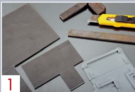
1 Die originale Auffangwanne des Bausatzes von Kibri wird durch einen Selbstbau aus Polystyrolplatten und -profilen ersetzt.
