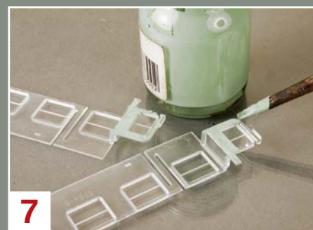
7 Die Rückseite des der Einfachheit halber demontierten Fensterbandes der Wagen lässt sich ebenfalls mit dem Pinsel bemalen.
