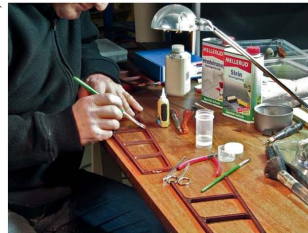
Die krummen Teile werden mit Steinversiegler getränkt und anschließend mit Gewichten beschwert, bis der Versiegler ausgehärtet ist.
