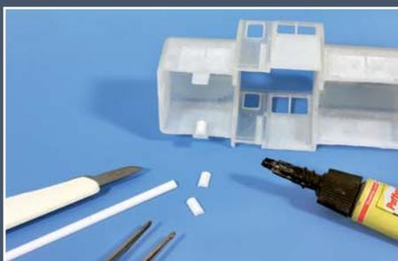
Die Haltenasen zur Befestigung des Gehäuses werden mit Kunststoffstücken stabiler.
