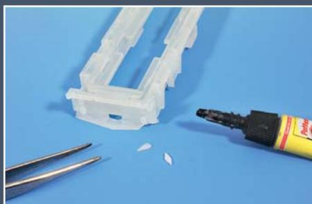
Abgebrochene Teile des spröden Materials befestigt man wieder mit Sekundenkleber.
