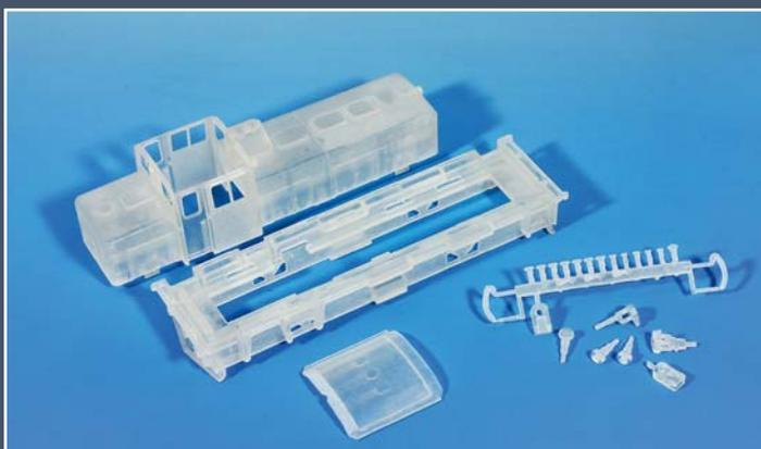
Im 3D-Druck erstellte Gehäuse von Fahrzeugen bestehen aus unterschiedlichen Baugruppen und vielen extra anzusetzenden Details.
