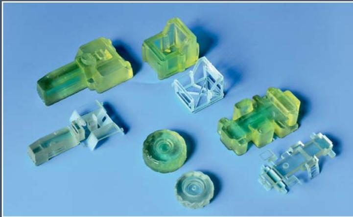
Die filigranen Bauteile des Traktors sind zusammen mit ihrem Stützmaterial in einem 3D-Poly-Jet-Verfahren hergestellt worden. Die Stützbetten und Traktorteile liegen nach der Entnahme nebeneinander.
