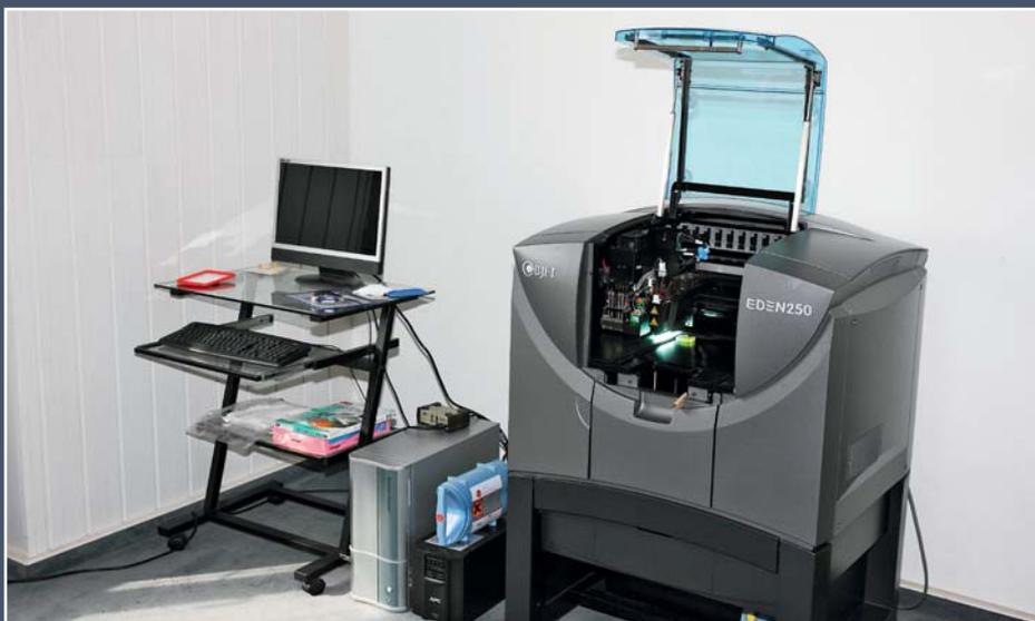
Der bei Technik und Design Neubrandenburg verwendete Drucker misst 25 x 25 x 20 cm. Das recht kompakte Gerät arbeitet in einem Drucktoleranzbereich von 0,1 mm.
