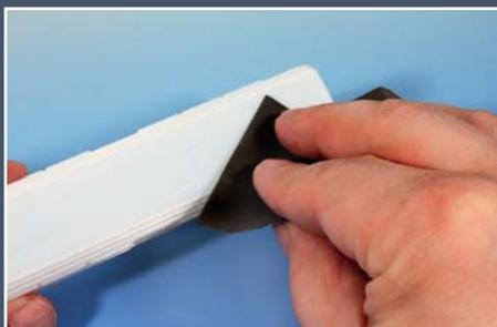
An glatten Oberflächen werden nun die druckbedingten Kanten weggeschliffen.
