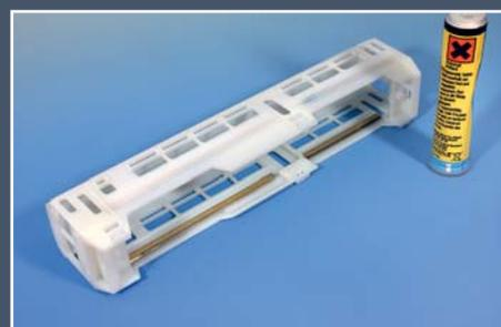
Zur Erhöhung der Stabilität wurden in dieses Gehäuse lange Messingprofile eingeklebt.
