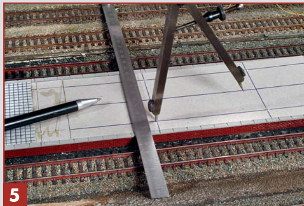
Die ermittelten Abstände für vier Säulen der Bahnsteigüberdachung werden mittels Zirkels auf eine Pappschablone übertragen.
