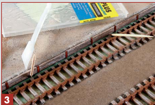
Nach der Bemalung und farblichen Alterung verklebt man die lange Holzkannte am besten mit einem Zwei-Komponentenkleber an dem mit Styrodur aufgefüllten Bahnsteig. Zahnstocher fixieren das Teil.
