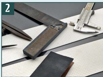
Das Kachelmuster mit den Maßen von 3 x 5 mm wird in eine Polystyrolplatte geritzt. Für die Längsrillen nutzt man den Feinmessschieber, für die senkrechten Winkel und Reißnadel.
