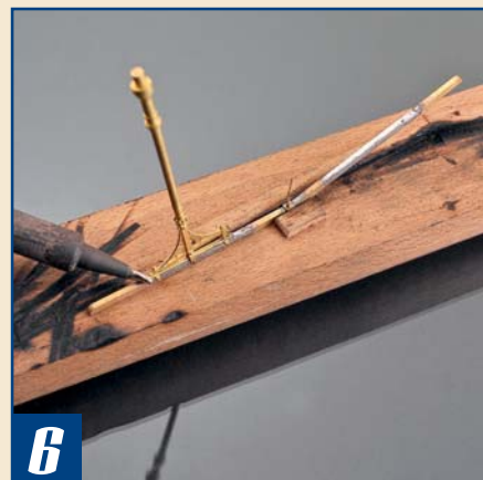
6 Die am Pfeiler angegossenen Haltetaschen für die Giebelbalken werden mit einer Pinzette nach oben gebogen, um anschließend den Pfeiler am Giebel anzulöten.
