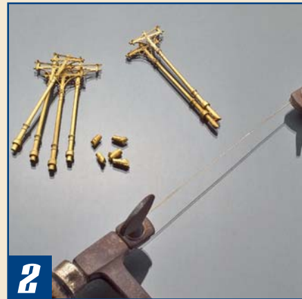
2 Die Angusskanäle unterhalb der Pfeiler entfernt man mit einem Sägeschnitt, so dass 4 bis 5 mm für die spätere Steckverbindung in der Bahnsteigfläche erhalten bleiben.
