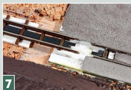
7 Wenn das Gleis flach aufgelegt ist, lassen sich die zierlichen Gleisverbinder problemlos zusammenstecken.
