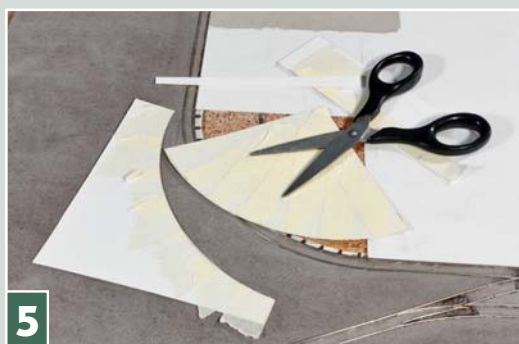
Die Kreppbandfläche klebt man auf eine 0,5 mm starke Polystyrolplatte und schneidet die Kanten gemäß Markierung aus..
