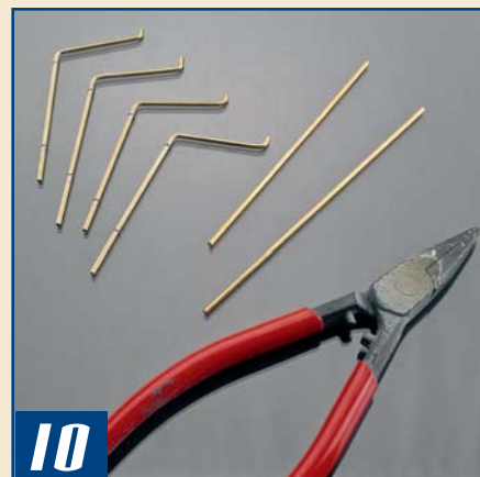
10 Die Regenwasserabflussrohre biegt man aus massivem Messinggrundmaterial mit einem Durchmesser von 1,5 mm zurecht. Eine Flachzange ist dabei sehr hilfreich.
