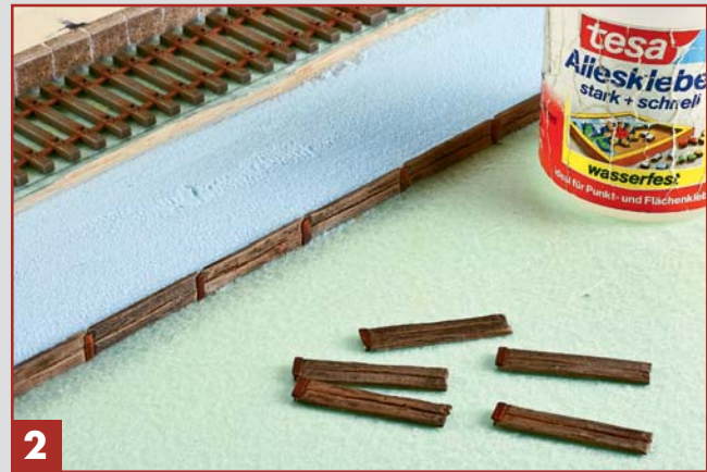
2 Nach dem Grundieren und Bemalen schiebt man beim Verkleben auf der Anlage das abgeflachte Ende der Schwellen in die Nut des angegossenen Schienenprofils vom benachbarten Bauteil.
