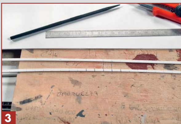
Als Abschlusskante kann man aus einer 2 mm starken Polystyrolplatte etwa 3 mm breite Streifen schneiden, die alle 10 mm eine feine Kerbe als Zementfuge erhalten.
