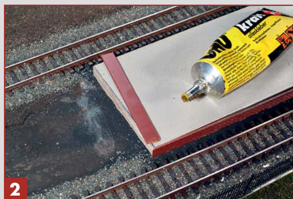
Hat man die Holzplatte als Kern etwas zu schmal gesägt, kann man den Abstand mit Holzleisten verbleiten. Auch dienen sie als Abstandshalter.
