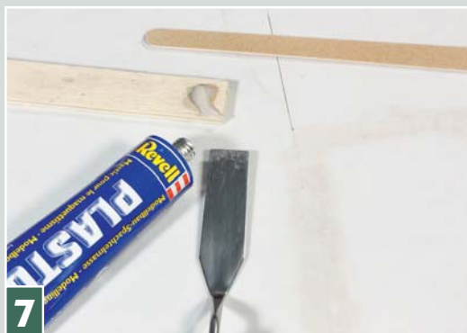
Soll eine Teerdecke simuliert werden, verschleißt man mit Nitropachtel die Klebefuge und verschleißt sie nach dem Aushärten nahtlos.
