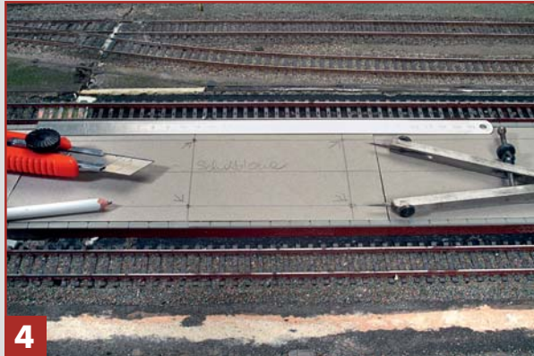
Die ermittelten Abstände für vier Säulen der Bahnsteigüberdachung werden mittels Zirkels auf eine Pappschablone übertragen.
