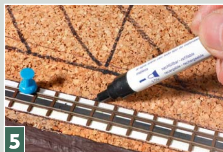
5 Mit einem Filzstift markiert man auf dem Korkuntergrund den Rand der Streifen mit den aufgeklebten Gleisen.
