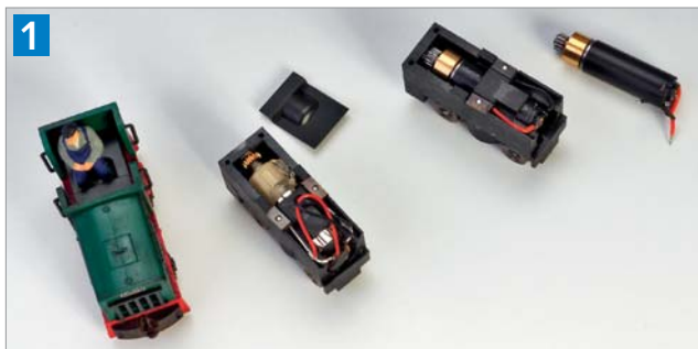
Links der Original-Busch-Antrieb mit 3-Volt-Maximalleistung, rechts der von „sb-modellbau“ angebotene Motor für den 12-Volt-Betrieb.
