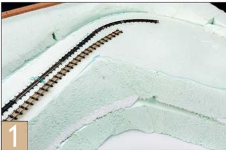
1 Die Basis der Grube bilden je nach Tiefe ein bis zwei Styrodurplatten. Sie erhalten am Grubenrand eine Schräge von zirka 40 Grad.
