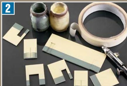
2 Die Wände erhalten eine zweifarbige Spritzlackierung, wobei die Farbtrennung durch Abdecken mit dünnem Malerkreppband erfolgt.
