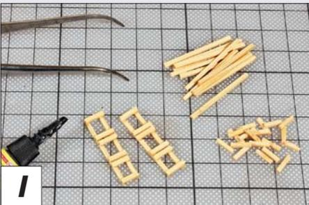
1 Aus Profilholzleisten mit 1,5 mm Kantenlänge sägt man kleine Stücke zur Anfertigung der Transportgestelle für die Radsätze.
