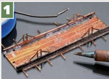
1 Begonnen wird die Fahrwerksmontage mit den beiden Längsträgern, an denen sich auch die Radaufhängung befindet.
