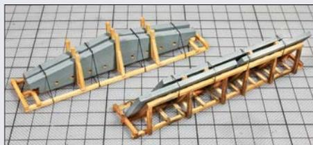
Unterschiedliche Betonfertigteile bekommt man mit Transportgestellen als fertige Ladegüter von unterschiedlichen Herstellern.
