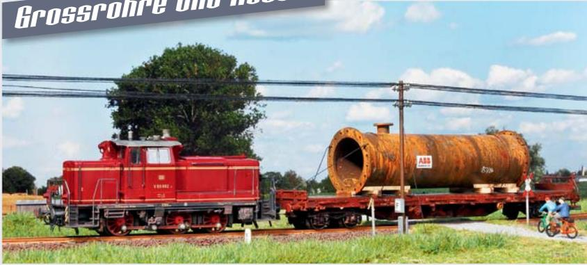
Das gekaufte Ladegut Stahlrohr wurde auf einen Flachwagen verladen. Es erhielt zusätzlich an den Stirnseiten noch Kanthölzer gegen ein Verrutschen des Rohres.
