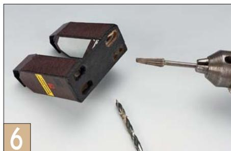
6 Entgegen dem Bausatz bekommt das Modell Räder. Dafür erhält der Boden Langlöcher.
