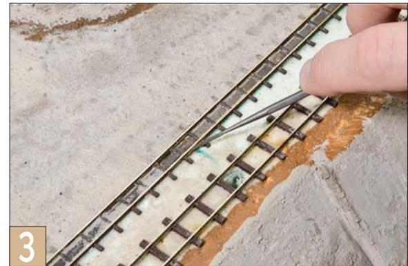
3 Das überschüssige Lötzinn feilt man weg und reinigt die Lötstelle mit Aceton, damit später Lötwasserreste nicht mehr oxydieren können.
