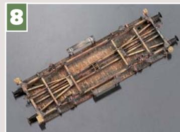
8 Nach der Montage von Federpuffern, Bremsschläuchen mit Luftleitung und Rangiererritten ist das Fahrwerk komplett.
