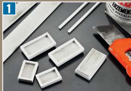
1 Größere Blumenkübel aus Beton für Bahnsteig und Vorplatz ab der Epoche III entstehen im Eigenbau aus Polystyrolplatten und Vierkantprofilen.
