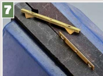
7 Das geradlinige Abkanten der Pufferbohlen gelingt am besten mit Hilfe eines kleinen Schraubstocks mit glatten Backen.
