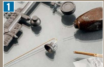
1 Eine Leuchte älterer Bauart entsteht im Eigenbau unter Verwendung von Kibri-Lampenschirmen und 0,3-mm-Messingdraht.
