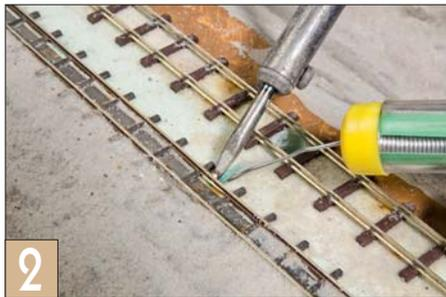
2 Die Gleisübergänge der Feldbahn, hier von Busch, sollten verlötet werden, damit Farbe die Übergänge nicht versehentlich isoliert.
