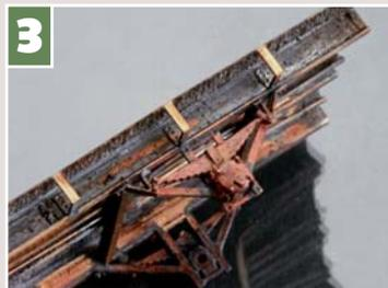
3 Die abgewinkelten Wagenkastenstützen werden am vorstehenden Schenkel des Längsträgers mit etwas Lot fixiert.
