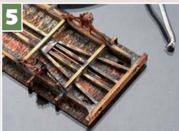
5 Die Messing-Pufferbohlen werden mittig an den Stirnseiten platziert und mit Wagenboden sowie den Trägern verlötet.
