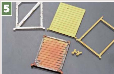
Die beiden Schiebetüren werden Schicht für Schicht zusammengelötet und dann die Räder angesetzt.
