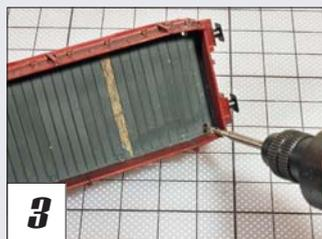
In die Wagenböden bohrt man kleine Löcher, durch die man die Spanngurte fädelt.
