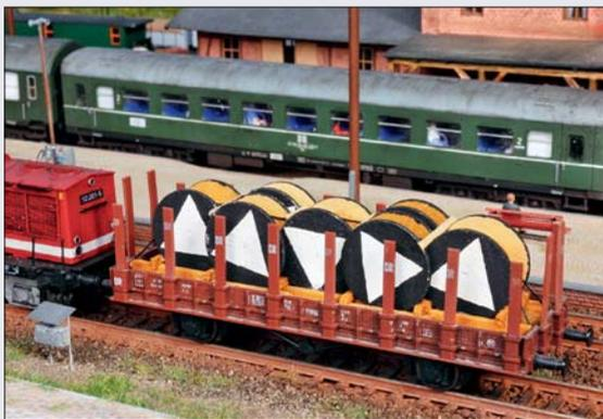
Die beiden Transportsituationen zeigen die Verladung mehrerer und einzelner Kabeltrommeln auf einem Runnenwagen. Die Gestelle werden beim Vorbild aufgenagelt, im Modell dagegen mit leicht haftendem Kleber befestigt, damit sie jederzeit abnehmbar sind. Beachtenswert sind die mit Holzplatten komplett als Schutz verkleideten Kabel.
