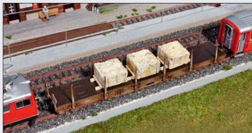
Die beim Vorbild aufgenagelten Unterlegbalken mit Querhölzern verhindern das Verrutschen der schweren Steine auf dem Holzboden des Flachwagens.
