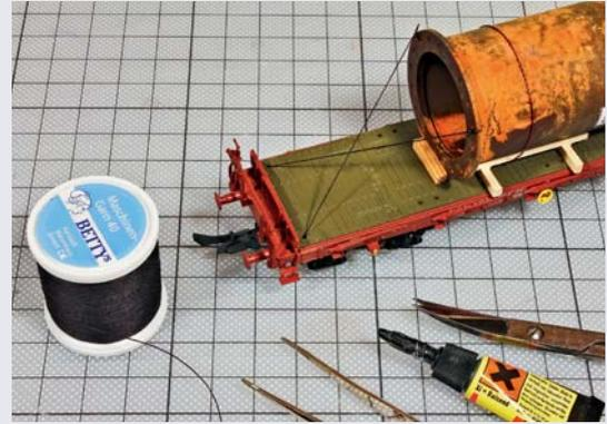
Mit Zwirn wird das Rohr über Kreuz am Wagen verspannt. Dazu führt man den Zwirn durch kleine Bohrungen im Wagenboden und fixiert ihn auf dem Wagenunterboden mit Sekundenkleber.
