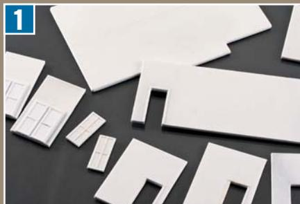
1 Die Innenwände entstehen aus 2-mm-Polystyrolplatten, die Türen und die Rahmen aus 1-mm-Polystyrolplatten und aufgeklebten Evergreenprofilen.
