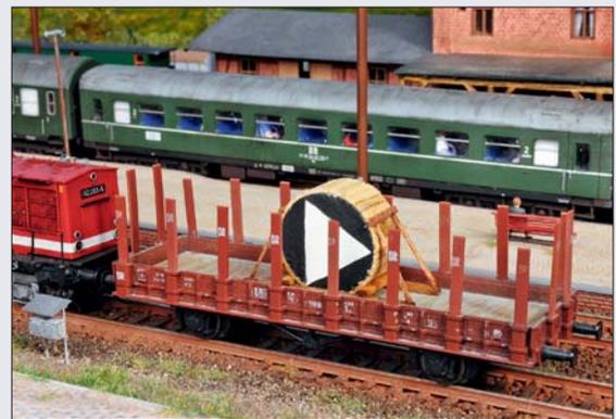
An den Wagenböden oder an den Seiten von Wagen sind stabile Ringe, Haken oder Ösen vorhanden, die heute aus mindestens 16 mm starkem Rundstahl bestehen und an denen man gegebenenfalls die Ladegüter fest- oder niederbindet.
