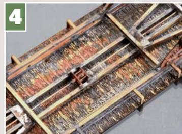
4 Am Wagenboden wird die fehlende Zugfeder ergänzt. Die zugehörige Zugstange ist ein Messingdraht und 0,6 mm dick.
