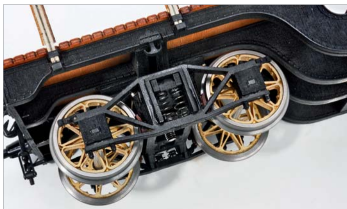
Die Speichen sind bei „LaserSachen“ auch aus Karton, der nach der Montage mit Sekundenkleber getränkt und dann total fest wird.
