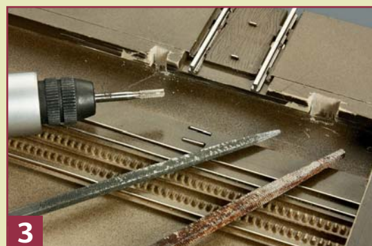
3 Die Vertiefungen zum Herausnehmen der Schiebebühne werden durch Fräsen und Feilen nachgebildet. Dabei übernimmt man die alten Maße von Größe und Abstand.
