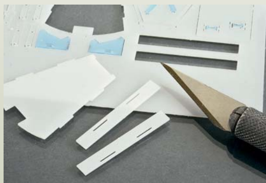
Der Bausatz besteht aus lasergeschnittenem Kunststoff bzw. Acrylit.
