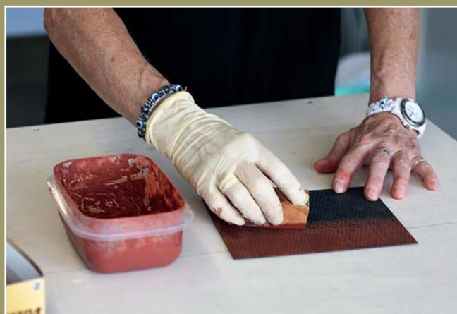
Die aus Karton gelaserte Dachfläche wird zuerst schwarz lackiert und dann in einem zweiten Arbeitsgang rot patiniert.
