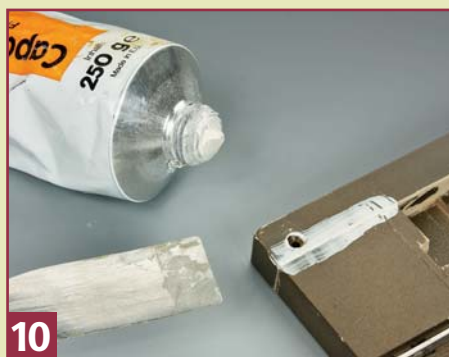
10 Klebspalten verspachtelt man mit einer Nitrospachtelmasse, die nach dem Aushärten und mehreren Schleifgängen mit verschiedenen feinen Schleifpapieren und Überlackieren nicht mehr zu sehen sind.
