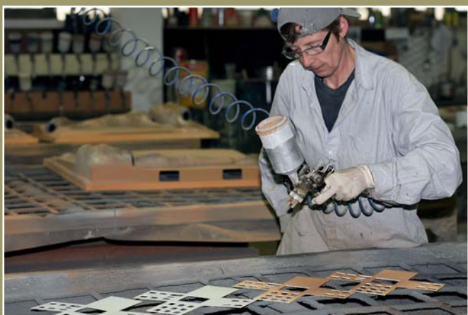
Nach der Herstellung der Bauteile werden die Außenflächen nebst Innenkanten der Fensterhöhlen komplett matt lackiert.
