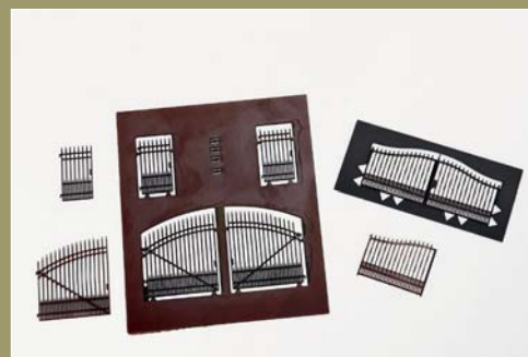
Besonders filigrane und bruchempfindliche Teile fertigt man aus deutlich stabilerem WAD-Plast, einem kunststoffähnlichen Material.
