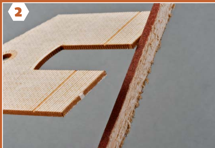
Letzte Reste der Haltestege verschwinden durch vorsichtiges Abschleifen mit einer feinkörnigen Schmirgellatte oder Feile.
