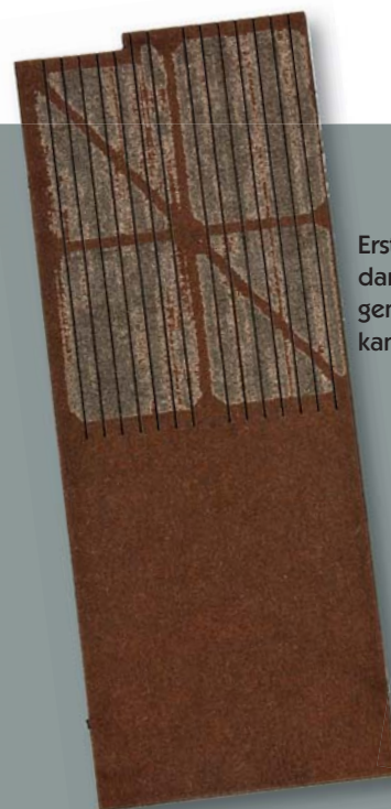
Dieser komplett verwitterte Lattenzaun besteht im Modell komplett aus Fotokarton, der sein Aussehen nur durch den Laser erhalten hat.
