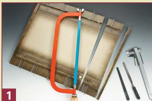
1 Zwei saubere Sägeschnitte mit Nacharbeit sind erforderlich, wenn man die Grube der Märklin-Schiebebühne um eine Standlänge kürzen möchte.
