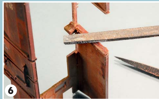
6 Die letzten Reste vom Sägeschnitt glättet man mit einer kleineren Flachfeile und passt die Kante der Wagenform sauber an.
