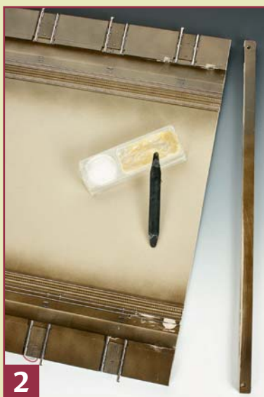
2 Die abgetrennte Grubenseitenwand klebt man mit einem Zweikomponenten-Kleber seitlich wieder an die verkürzte Grube an.
