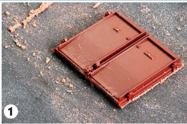
1 Vom Spenderwagen werden die Türpaare so herausgetrennt, dass beiderseits die Konturen der Scharniere erhalten bleiben.
