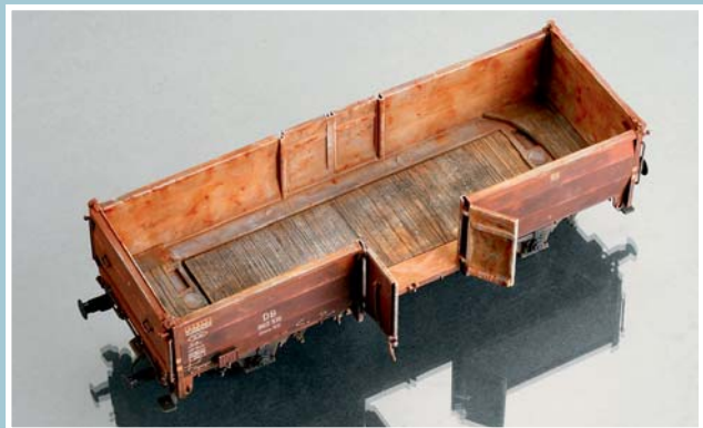
6 Vor dem Verkleben der Türen an ihren Scharnieren werden die Berührungsflächen zwecks besseren Halts flacher gefeilt.
