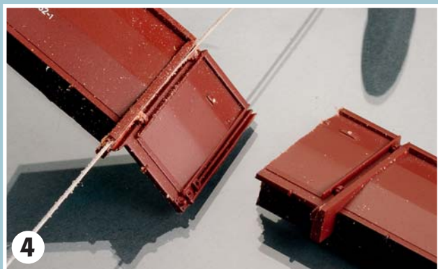
4 Beim Heraustrennen der Türen beim Ersatzteil bleiben die Türscharniere erhalten, man sägt deshalb durch den Wandträger.
