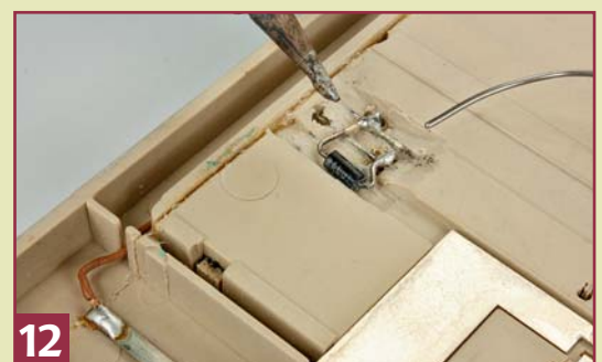
12 Im letzten Arbeitsgang lötet man das braune Massekabel und die kleine Diode an den vorgesehenen Plätzen wieder an.
