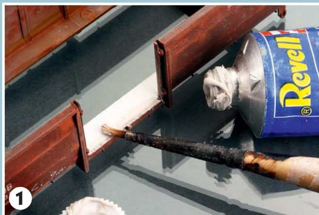
1 Die ausgesägte Bodenfläche wird durch einen 0,4 mm dünnen Polystyrolstreifen ergänzt und der Spalt sodann verspachtelt.
