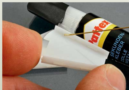
Die meisten Bauteile werden durch eine Steckverbindung gehalten. Ein Sichern mit dünnflüssigem Sekundenkleber ist ratsam.
