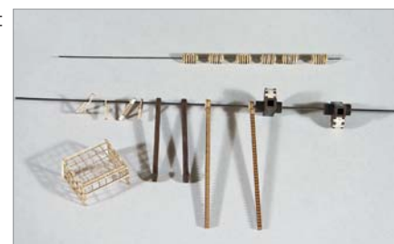
Beide Stellstangen mit Zahnkranz und die Seilräder bestehen aus mehreren Teilen.
