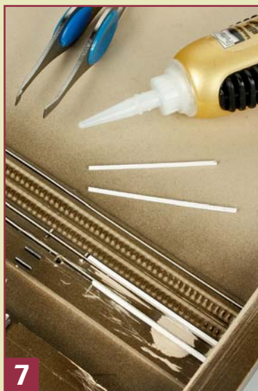
Die neuen Gleitbahnen befestigt Sekundenkleber auf dem Grubenboden.
