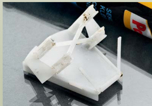
Das Verkleben der Stützen mit der Rutsche gelingt am besten in Kopflage.
