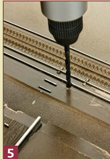
5 Für die Stromtrennung an der äußeren Leiterbahn bohrt man ein 2-mm-Loch, um sie dann mit einer Bügelsäge zu durchtrennen.
