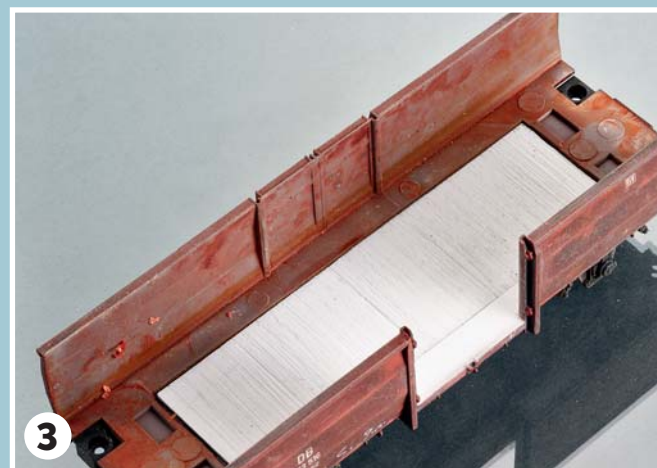
3 Beim Verkleben der neuen Polystyrol-Bodenfläche am Fahrwerk dient der lose aufgesetzte Wagenkasten als Montageschablone.
