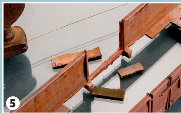
5 Beim unteren Querschnitt dient die Oberkante des Verbindungsrahmens als Sägeblattführung bzw. Orientierung.
