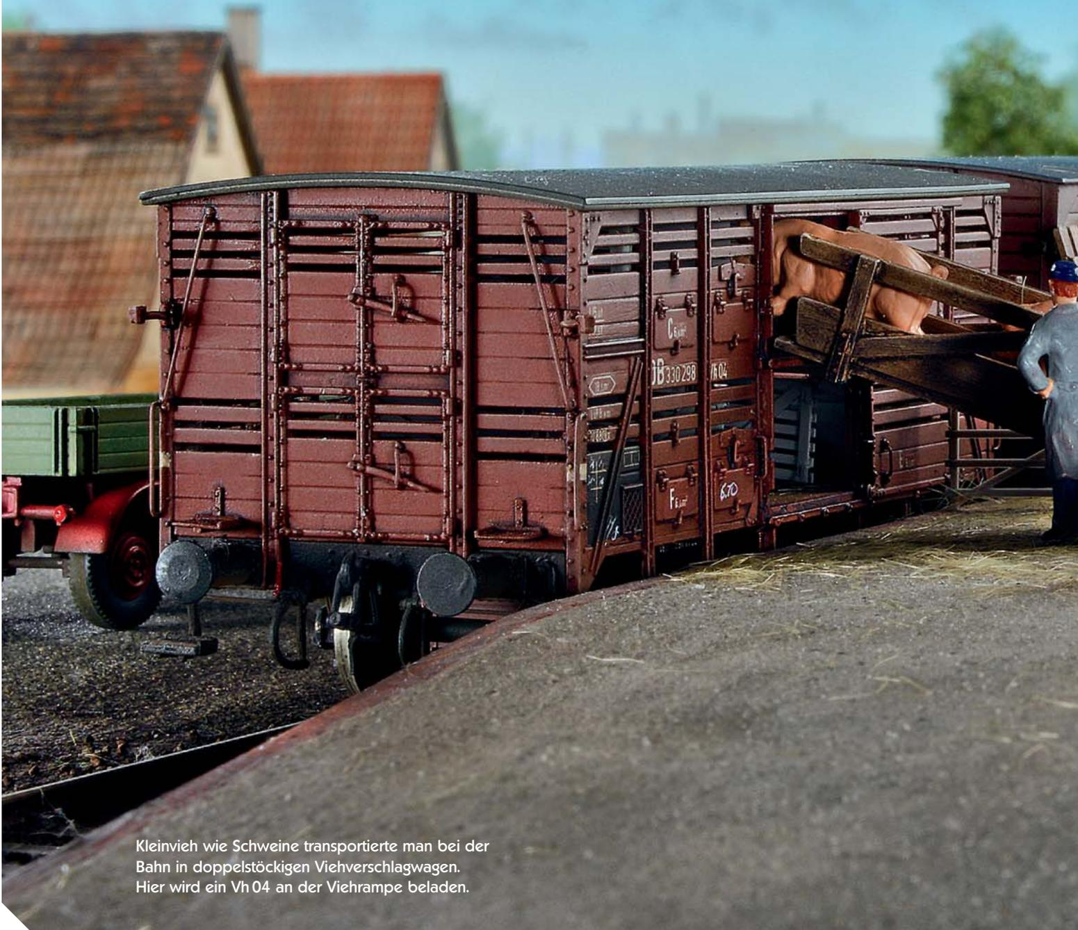
Kleinvieh wie Schweine transportierte man bei der Bahn in doppelstöckigen Viehverschlagwagen. Hier wird ein Vh 04 an der Viehrampe beladen.
