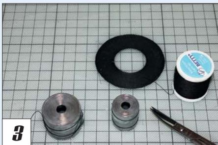
**3** Coils besitzen eine Bindung, hier mit Zwirn, als Schutz gegen unabsichtliches Abrollen.
