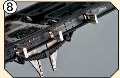
In die zuvor mittels Bohrschablone gebohrten Löcher werden nun die Stützen und Mikronieten geklebt.
