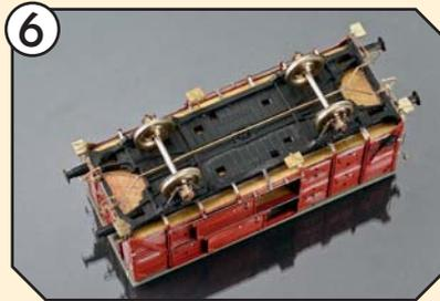
6 Am Wagenboden wird die durchgehende Luftleitung ergänzt. Auch die Messing-Trittstufen verfeinern das Modell.
