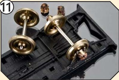
Die H0-pur-Achsen müssen bei diesem Wagenumbau eine Spitzenweite von 22,0 mm aufweisen.
