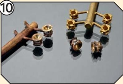
Bei den Gleitlagergehäusen aus dem Bahn-Sinn-Shop von Kosak wird rückseitig die Führungsbuchse aufgelötet.
