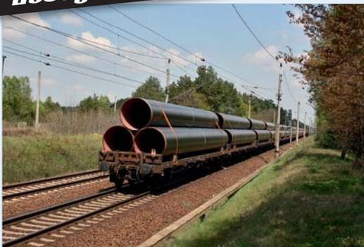
Rohre mit großen Durchmessern dürfen zweilagig auch ohne Rungen transportiert werden, sofern Sicherungskeile existieren.
