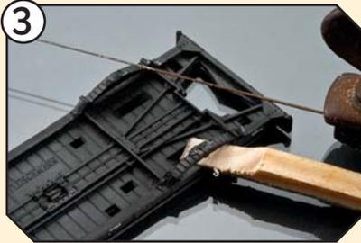
Vom Fahrwerk werden die Fachwerksachshalter komplett abgetrennt. Die Federpakete bleiben stehen.
