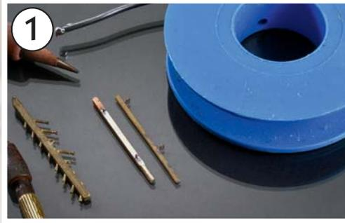
Für den Maschendrahtzaun von Saemann entstehen Betonpfosten aus 2x2-mm-Vierkantprofil.
