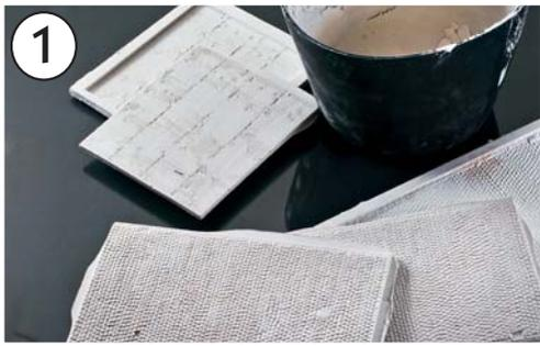
1 Straßen- und Mauerteile entstanden durch zahlreiche Gipsabgüsse von Spörles Silikonformen.
