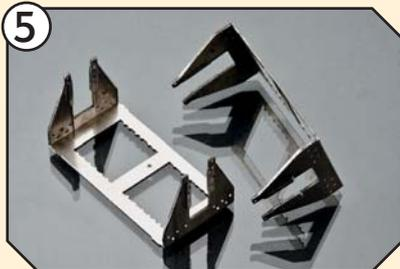
Die Achshalterbrücke ist dreiteilig ausgeführt. Sie wird nach dem Verlöten der Teile jeweils um 90 Grad abgewinkelt.
