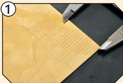
1 Der neue Innenboden entsteht aus 0,5-mm-Messingblech, wobei die Bretterstäbe mit der Schieblehre quer zur Fahrtrichtung eingeritzt werden.
