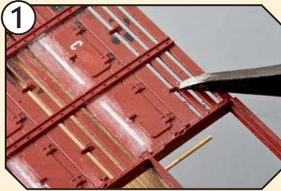
1 Mit einem Stichel entfernt man alle angespritzten Griffe, die später durch Messingdraht ersetzt werden sollen.
