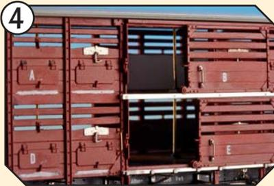
4 Die Verriegelung für die inneren Klapp-tore wird mit entsprechenden Ätzteilen der Platine ergänzt.
