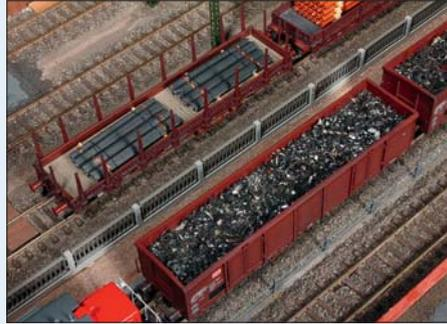
Um Verwehungen durch Fahrtwind (Vorbild) zu vermeiden, wurde der Schrott hier nicht bis an die Ränder der Bordwände beladen.
