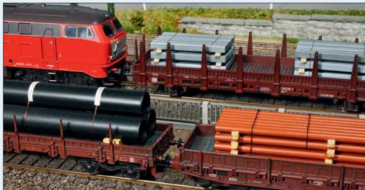
Die Art des Stapelns und der Niederbindung der Rohrladung richten sich nach den jeweiligen Durchmessern der Einzelrohre.
