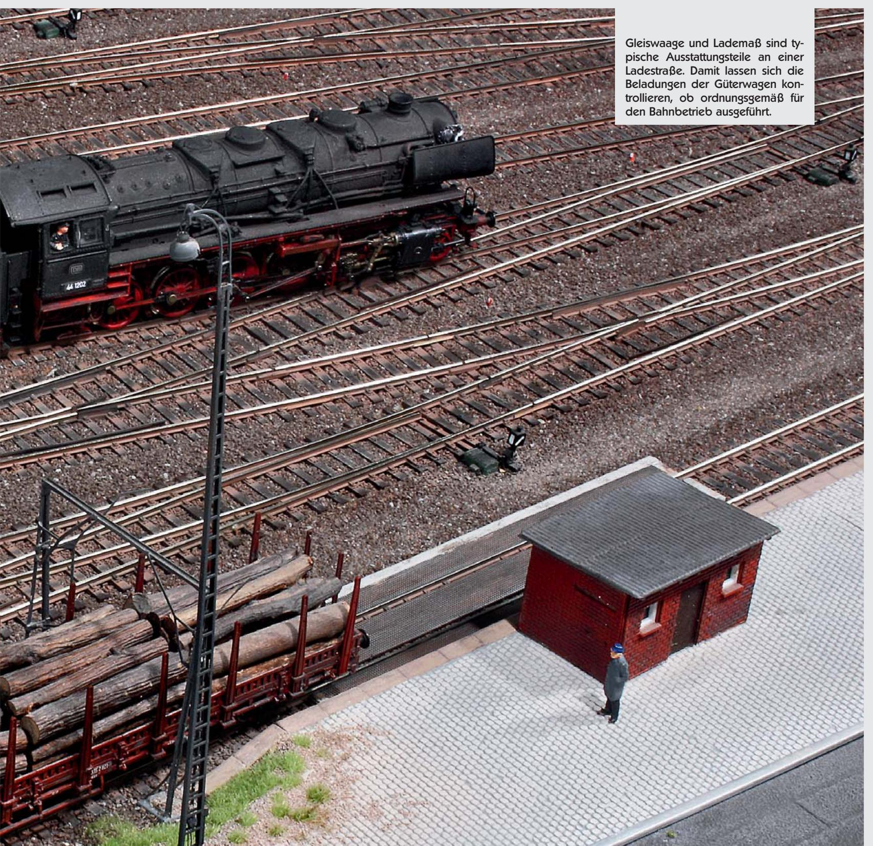
Gleiswaage und Lademaß sind typische Ausstattungsteile an einer Ladestraße. Damit lassen sich die Beladungen der Güterwagen kontrollieren, ob ordnungsgemäß für den Bahnbetrieb ausgeführt.
