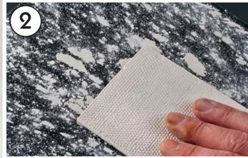
2 Alle Gipsplatten schleift man auf der Unterseite, um eine einheitliche Materialdicke zu erlangen.
