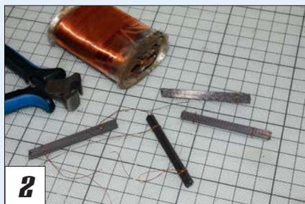
Sehr dünner Kupferdraht hilft beim Zusammenschnüren der Stahlstab-Bündel.
