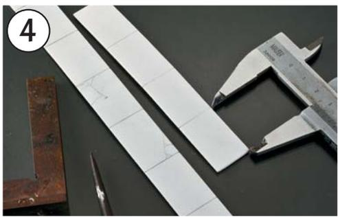
4 Die Betonelemente zum Abdecken der Gleise sind 20 mm breite und 2 mm dicke PS-Streifen.
