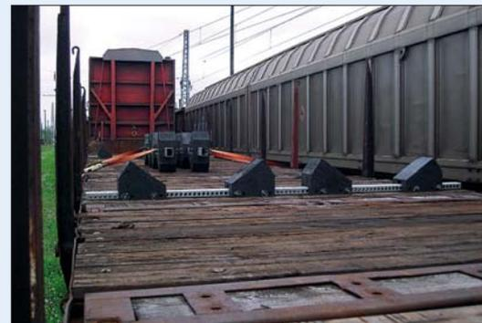
Das Auffangen der Seitenkräfte auf dem Wagen übernehmen bei regelmäßigen Transporten verstellbare Keilsysteme.
