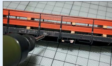
An den Zurrösen bohrt man im Wagenrahmen kleine Löcher, um die Verspannung der Profile befestigen zu können.
