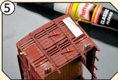
5 Die zugestützte Stirnseite: Beim Montieren der Draht-Handgriffe dient ein Stück 0,5-mm-Polystyrol als Distanzstück.
