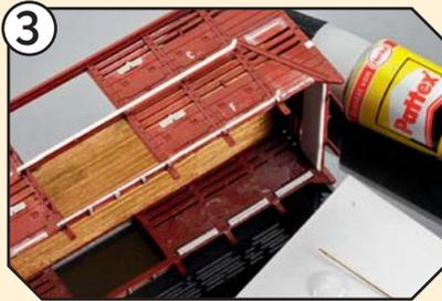
3 Im Gegensatz zur unteren Türschiene wird die obere nur durch eingelötete 0,2-mm-Drahtstücke gehalten.
