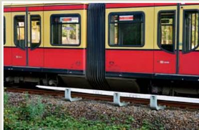
Bei der Berliner S-Bahn wird der Strom am Drehgestell von einer seitlich verlaufenden Stromschiene abgenommen. Die Stromschiene ist auf den Schwellen montiert. Sie können wechselseitig auch mit Unterbrechungen angeordnet werden.
