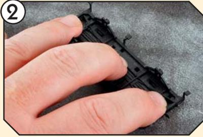
Beim Fahrwerk wird alles, was über das Niveau der Langträgerbrücke nach oben ragt, plan verschliffen.
