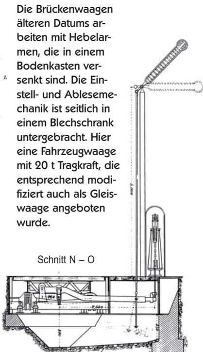
Die Brückenwaagen älteren Datums arbeiten mit Hebelarmen, die in einem Bodenkasten versenkt sind. Die Einstell- und Ablesemechanik ist seitlich in einem Blechschrank untergebracht. Hier eine Fahrzeugwaage mit 20 t Tragkraft, die entsprechend modifiziert auch als Gleiswaage angeboten wurde.
