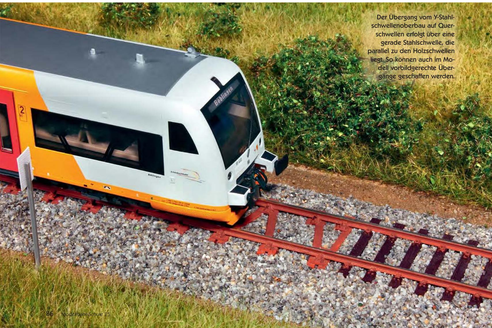
Der Übergang vom Y-Stahlschwellenoberbau auf Querschwellen erfolgt über eine gerade Stahlschwelle, die parallel zu den Holzschwellen liegt. So können auch im Modell vorbildgerechte Übergänge geschaffen werden.
