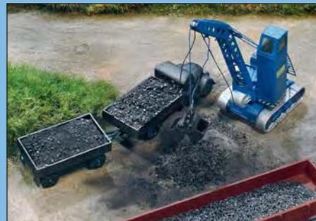
Ein typischer DDR-Mobilbagger war der auf Raupen fahrende RK Mitschurin. Ab 1953 baute man ihn im VEB Schwermaschinenbau Verlad- und Transportanlagen Leipzig in verschiedenen Varianten, unter anderen mit normalem und hochgelegtem Führerhaus (letzteres vor allem für die Bekohlung von Dampfloktendern). Er hatte eine Tragkraft von 3000 kg und wog insgesamt 8,7 t. Gebaut wurde er bis 1960 und dient heute noch als Bekohlungs-kran in einigen Schmalspur-Bw.
