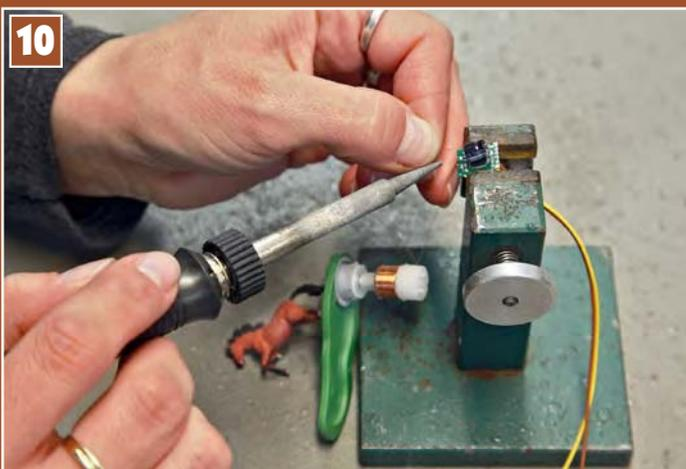
10 Im nächsten Arbeitsgang lötet man die beiden Drähte der Magnetspule an der bereits fertigproduzierten Stellplatine fest.
