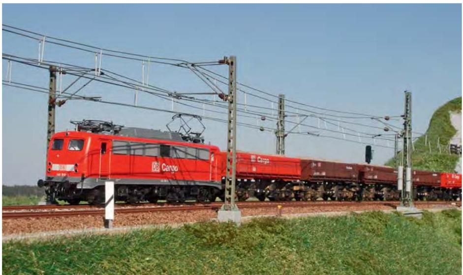
Zur Versorgung großer Baustellen mit Schotter oder Kies beschaffte die Deutsche Bahn AG ein- und zweimuldige Seitenkipperwagen als Spezialkonstruktionen (Prinzip wie Lkw-Pritsche) mit ihrer eigenen Energieversorgung. Sie verkehren fast ausnahmslos in Ganzzügen.
