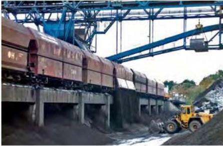
Die schlagartige Entladung von Fals-Wagen erfolgt meistens über Tiefbunkern, hier im Kraftwerk Oberhavel in Berlin. Die Wagen sind so ständig im Güterwagenumlauf.
