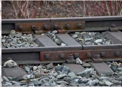
Bei Metallschwellen folgte nach jeder 22. Schwelle die beim Vorbild aus einem Guss gefertigte Doppelschwelle, korrekter auch Breitschwelle genannt. Hier die massive Sto verbindung K2.
