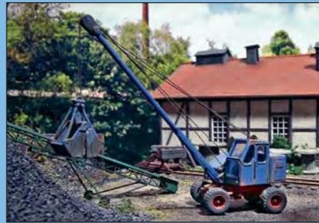
Der 1950 bei Fuchs begonnene Baggerbau führte 1955 zum Mobilbagger Fuchs 300, der ab 1957 vom hier gezeigten, noch erfolgreicheren Typ F301 abgelöst wurde. Bis 1978 entstanden über 14000 Stück mit verschiedenen Ausstattungen. Seine Leistung betrug 30 PS und er wog zirka 7 t. Der Greifer konnte 0,3 m<sup>3</sup> fassen. Der Bagger wurde sowohl mit normaler wie auch mit einer Hochkabine angeboten und war vielerorts im Westen anzutreffen, auch in Bahnbetriebswerken.
