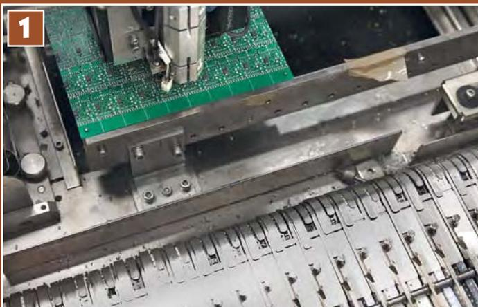
Am Anfang des Produktionswegs steht die Herstellung der Elektronikplatinen. Per Automat werden sie mit ICs und Widerständen bestückt.
