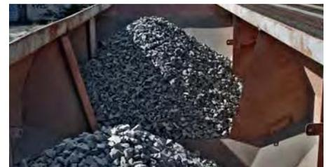
Hier ist am Beispiel eines zweiachsigen Fcs-Wagens zu erkennen, wie wenig Schotter geladen werden kann, bis die Grenzlasten bei diesem Wagentyp erreicht sind.
