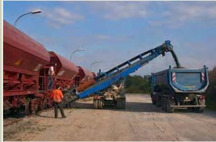
Mittels Förderbändern können Schüttgüter sehr flexibel aus Fac- oder Fc-Wagen entladen werden, da bei diesen die Schütten einzeln und seitenweise geöffnet werden.
