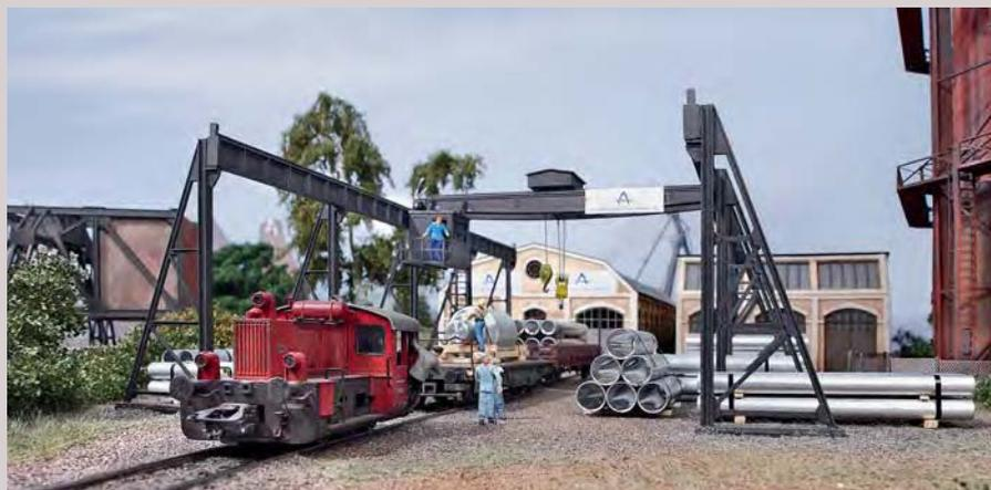
Bockkräne können auch verfahrbar sein. Man spricht von einem Brückenkran, wenn beide Seiten aufgeständert sind. Sie stehen üblicherweise in Hallen (HO-Modell Walthers).
