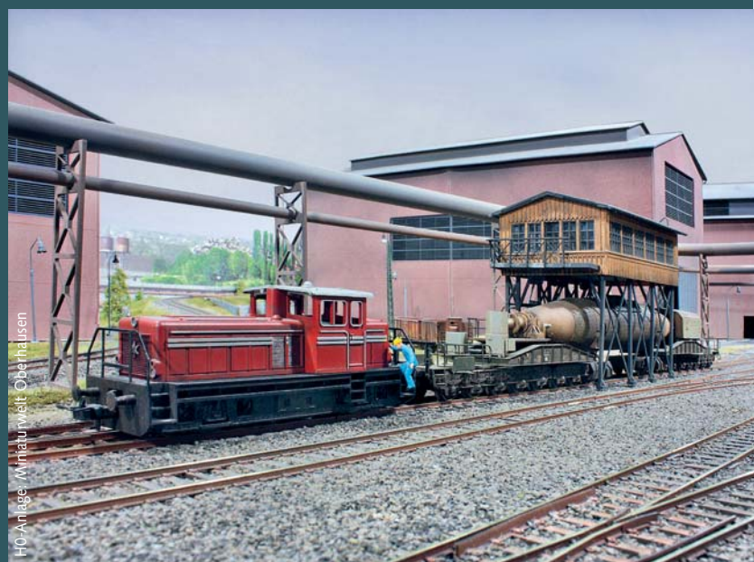
Roheisen wird in Torpedopfannenwagen transportiert, wenn besonders weite Strecken zurückgelegt werden müssen. Der Verschluss des Deckels geschieht unter der sogenannten Deckelbude.
