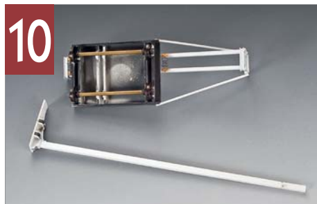
Das Fahrwerk ist ein Eigenbau aus Messingrohr und eingeschobenen Schmalspurrädern.
