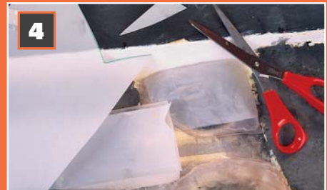
4 Auf der Haubeninnenseite dient die eingesetzte Softscheibe besserer Lichtstreuung.
