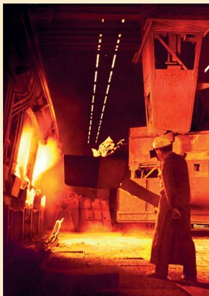
Im Ofen des Siemens-Martin-Verfahrens wird aus Roheisen und Schrott unter gleichbleibender sehr hoher Temperatur Stahl unterschiedlicher Güten hergestellt.
