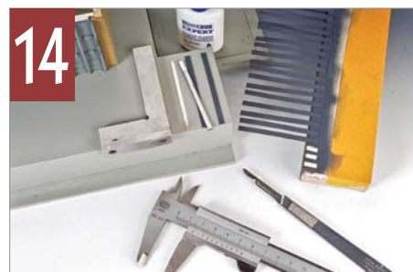
14 Ein Anschlagwinkel hilft bei der Verklebung der Schwellen auf der Ofenplattform.
