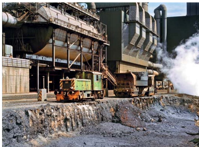
Schlackenbeete können in unmittelbarer Nähe zum Hochofen liegen. Hier wird ein Schlackenwagen zum Abkippen vorbereitet.
