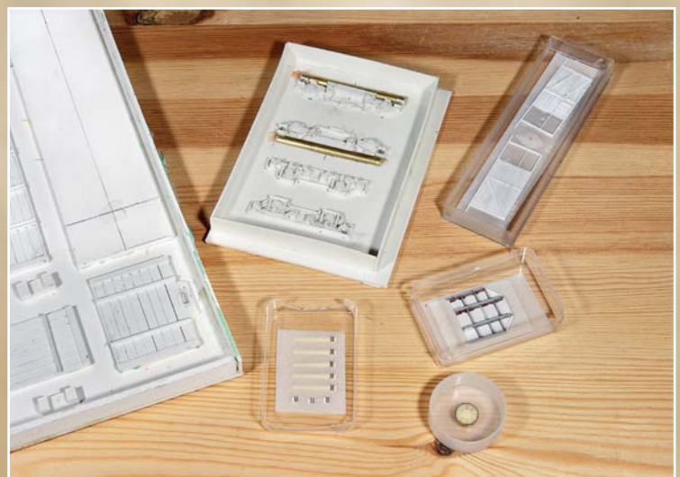
Verschiedene Gießkästen aus Verpackungsresten mit zugehörigen Urmodellen. Die Kastenränder sind höher als das Werkstück.
