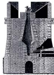
Bis in die 1870er-Jahre waren alte Hochöfen gemauert und hatten nur einen Blasebalg.
