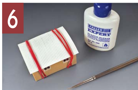
Kräftige Gummibänder halten das Wellblechdach bis zum Aushärten des Klebers in Form.
