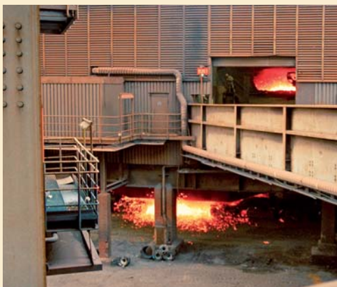
Während des Befüllens des Torpedopfan-nenwagens spritzt das Roheisen auch schon mal daneben, daher ist der Bereich nicht zu betreten.
