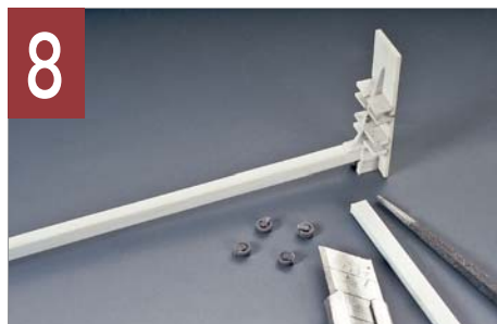
Die Versteifungen an der Ausdrückplatte bildet man aus passendem Polystyrol nach.
