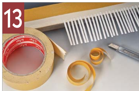
13 Doppelseitiges Klebeband fixiert die Schwellen beim Lackieren an einer Leiste.
