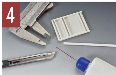
Eine Polystyrolplatte sowie U-Profile bilden das Fahrgestell des Ausdruckwagens.
