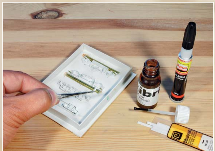
Mit Kunststoffkleber und einer ruhigen Hand werden die Bauteile des abzugießenden Urmodells zusammengefügt.
