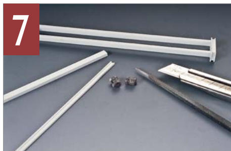
Die Führung des Ausdrückarms entsteht aus Kunststoffprofilen und überzähligen Rädern.
