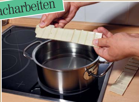
Bei Verzug können Bauteile über Wasserdampf mit leichtem Druck wieder gerichtet werden.
