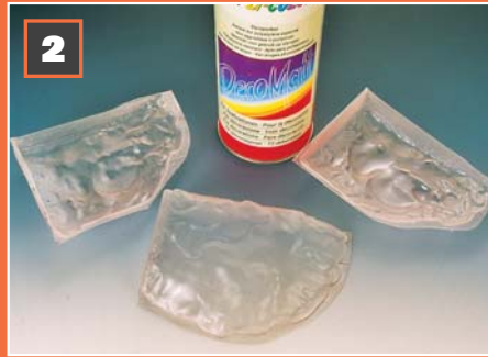
2 Die Haube lackiert man matt, damit später die sichtbare Oberfläche nicht glänzt.
