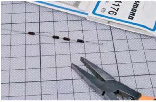
Zuerst werden die benötigten Isolatoren auf den unteren Richtseil-Draht des Tragwerkes aufgefädelt.
