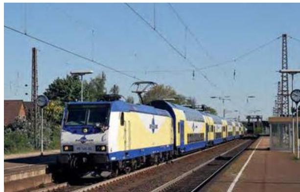
Ein asymmetrisch aufgebautes Quertragwerk für zwei Gleise, hier im Bahnhof Celle. Gut erkennbar ist der im Modell oft vernachlässigte parabolische Verlauf des Quertragseiles.
