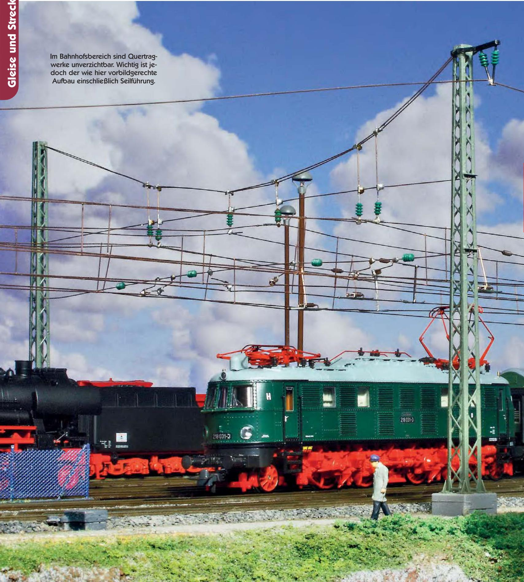
Für einen vorbildgerechten Modellbahnbetrieb sind bei moderneren Hauptstrecken Fahrleitungen unverzichtbar. Deren wichtigster Bestandteil in den Bahnhöfen und auf mehrgleisigen Streckenabschnitten sind Quertragwerke. Deren korrekte Nachbildung auch im Detail sowie über Weichenverbindungen steht im Mittelpunkt des Beitrages.
