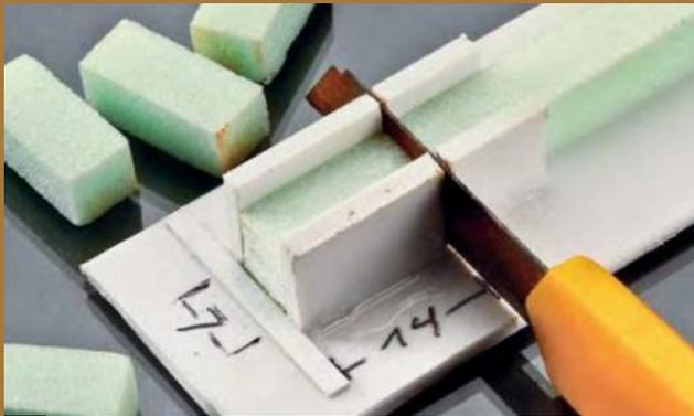
**1** Das Ausgangsmaterial sind Hartschaumplatten, in Streifen geschnitten und mittels Schablone abgelängt.
