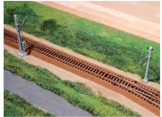
Als Fixpunkt dient ein Abspannmast, der gleichzeitig die Fahrleitung des Hauptgleises aufnimmt.
