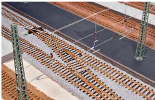
Entsprechend des Gleisverlaufes werden die Fahrdralthalter in die Richtseile eingeklipst.
