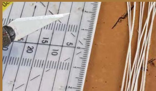
**5** Holzlatten imitiert man mit 0,3 mm breiten Polystyrolstreifen, die aus einer 0,25mm starken Platte geschnitten werden.
