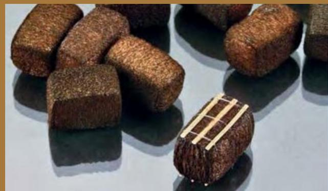
**8** An der sichtbaren Stirnfront muss die Ballenschauseite komplett mit Latten und Spanndrähten ausgestattet sein.
