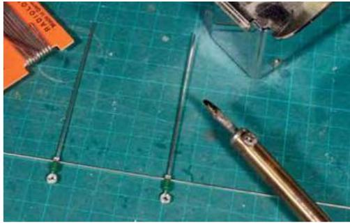
Anschließend werden die Hänger mit dem oberen Richtseil rechtwinklig verlötet. Ein Raster hilft.
