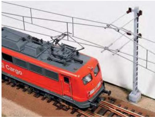
Wichtig ist eine regelmäßige Funktionsprobe mit einer Lok zur Kontrolle des Fahrdrahtverlaufes.
