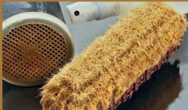
**6** Abschließend erhält die gesamte Ladung nochmals mit einem Elektrostaten eine dünne Grasfaserschicht.
