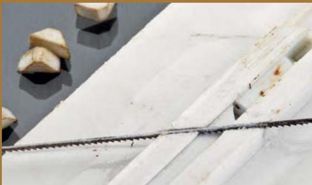
**6** Die Ladungssicherungskeile werden in einer kleinen Lehre schräg und auf Maß aus einem PS-Vierkantprofil gesägt.
