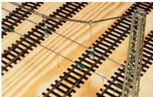
Das fertige Sommerfeldt-Quertragwerk vor dem Einhängen der eigentlichen Fahrleitungen.
