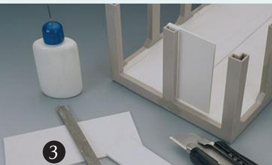
3 Aus PS-Platten werden die Bodenplatte angefertigt und die Stützen verkleidet.
