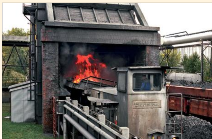
Wenn der Löschwagen komplett mit Koks beladen ist, fährt die Lok den Wagen unter einen hohen Löschurm.
