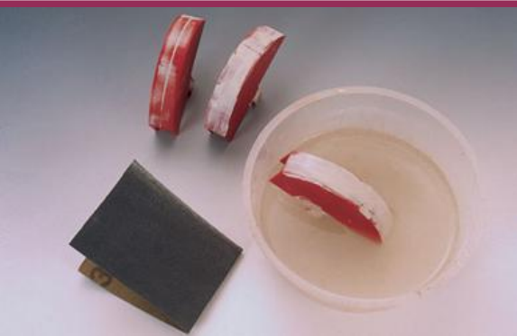
Die etwas grob gehaltenen Hauben verspachtelt man und schleift sie dann glatt.
