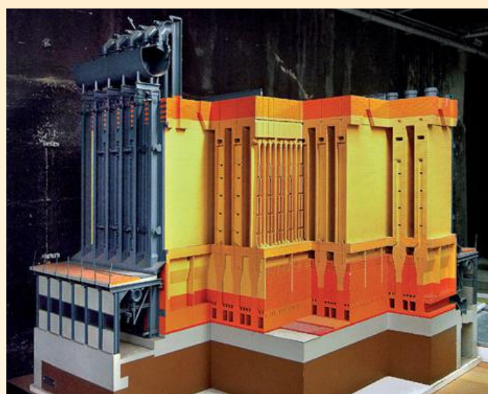
Im Schnitt des Flammofens erkennt man die vielen Gaskammern mit den Spezialsteinen zur Hitzeabgabe an den Koks in den Kammern.
