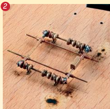
Das Verlöten der vielen Rahmenbauteile erfolgt auf einer selbstgefertigten hölzernen Lötstablone.
