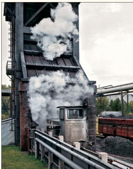
Gewaltige Wassermengen fallen auf den glühenden Koks, um ihn schlagartig abzukühlen.
