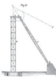
Ab ca. 1870: Stahl-Pyrami- dengerüst kontra Mala- kow-Turm.
