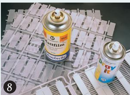
8 Die durchsichtigen Fensterscheiben mattiert man mit kunststofffreundlichem Mattspray.
