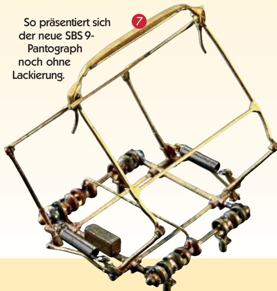
Für die Montage der neuen Stromabnehmer ändert sich die Befestigung. Die am Dachteil angeformten Sockel sind hierfür zu entfernen.
