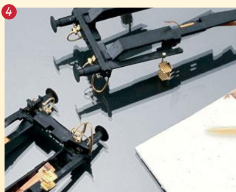
4 An beiden Umlaufteilen sind die Pufferbohlen zugestrichen und die seitlichen kleinen Aufstiegstritte durch feinere ersetzt worden.
