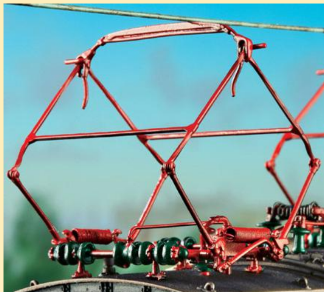
Der fertige Dachbereich überzeugt vor allem wegen der feinen SBS 9-Pantographen und der sauberen Lackierung aller Teile.
