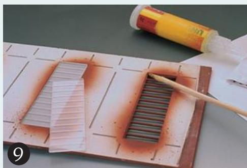
9 Da durch den Lack kein Polystyrolkleber hält, fixiert man die Scheiben mit Sekundenkleber.
