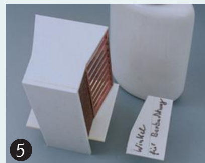
5 Seitenwände und Boden fertigt man aus 1,5 mm starken Polystyrolplatten.
