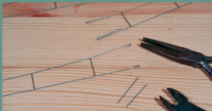
Mit einer gewöhnlichen Flachzange lassen sich die Drahten auch biegen. Die zu langen Enden schneidet man ab.
