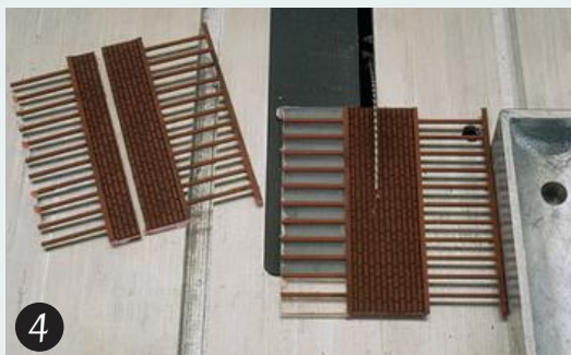
4 Aus Restteilen sägt man die Teile für den Kohleverlade-Kommandostand unterhalb der Lesebandhalle.
