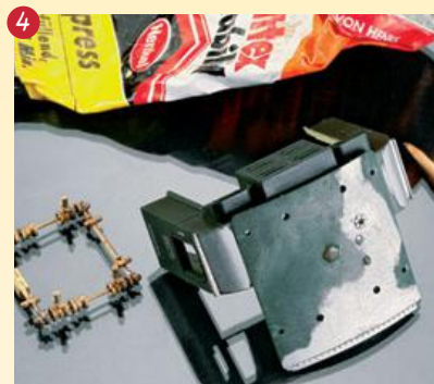
Die überflüssigen Löcher werden mit dem Zwei-Komponenten-Kleber Stabil-Express verschlossen.
