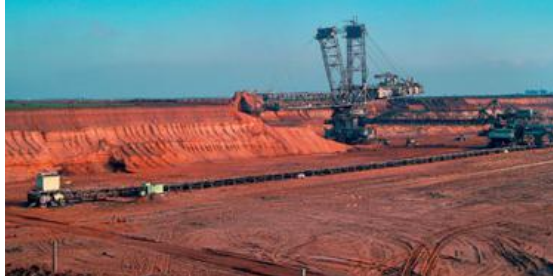
Gewaltige Schaufelradbagger werden heute im offenen Braunkohle-Tagebau eingesetzt.
