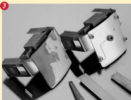
Für die Montage der neuen Stromabnehmer ändert sich die Befestigung. Die am Dachteil angeformten Sockel sind hierfür zu entfernen.
