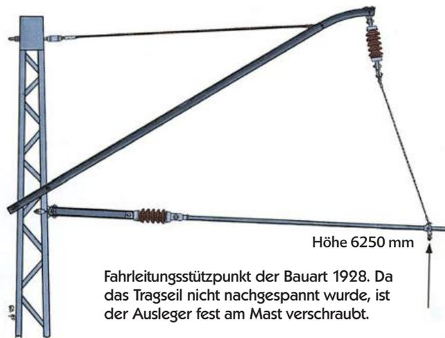
Fahrleitungsstützpunkt der Bauart 1928. Da das Trageil nicht nachgespannt wurde, ist der Ausleger fest am Mast verschraubt.
