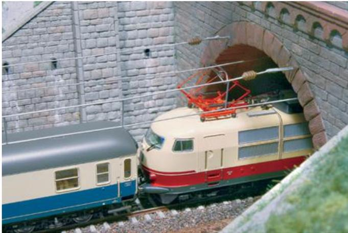
Bei Tunneln ist es üblich, die Beiseile an der Tunnelmauer als Endpunkt zu befestigen. Im Tunnel hängt der Fahrdrabt von der Decke.
