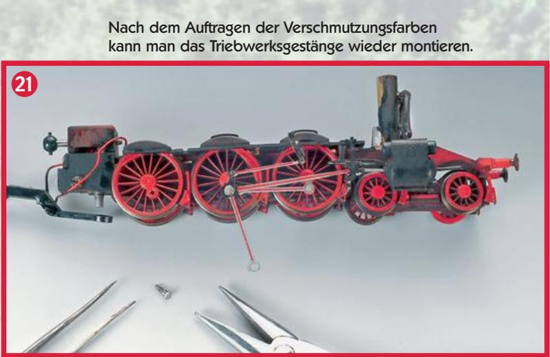
Nach dem Auftragen der Verschmutzungsfarben kann man das Triebwerksgestänge wieder montieren.
