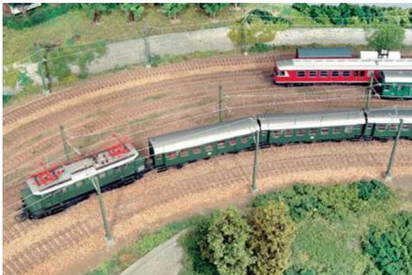
Um in Bögen nicht das vorgeschriebene Zick-Zack zu verlasen, müssen die Masten, hier Bauart 1950, dichter stehen.
