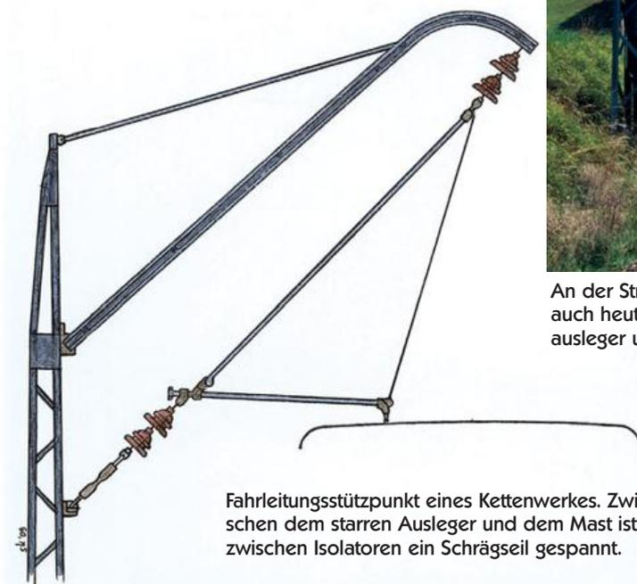
Fahrleitungsstützpunkt eines Kettenwerkes. Zwischen dem starren Ausleger und dem Mast ist zwischen Isolatoren ein Schrägeil gespannt.
