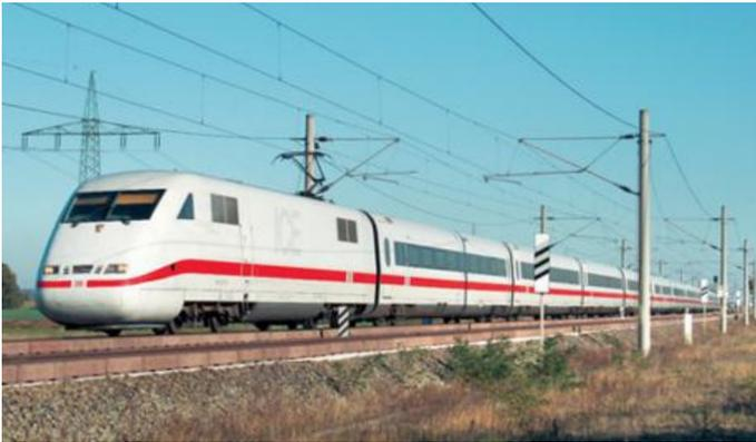
Die Re 330 mit größerem Drahtdurchmesser stellt die momentan komplexeste Fahrleitung für den Hochgeschwindigkeitsverkehr dar.
