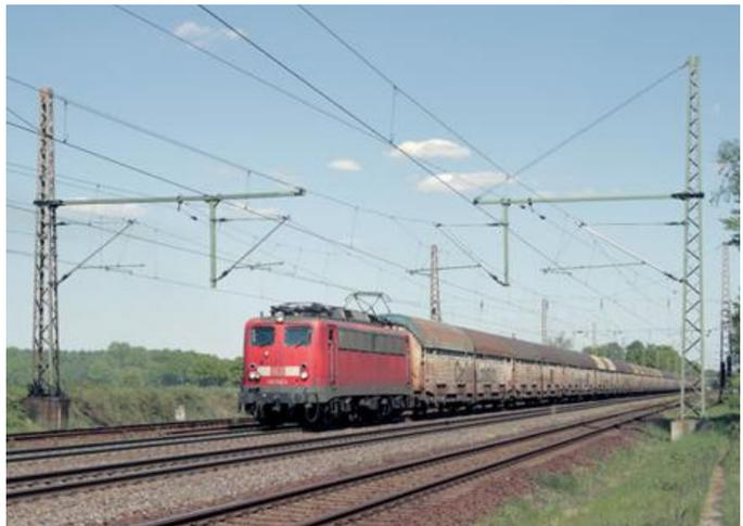
In Eschede sind die durchgehenden Gleise mit einer Re 200 überspannt, während die Nebengleise mit einer Re 75 ausgestattet sind.
