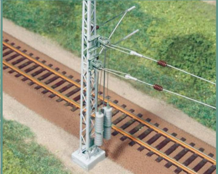
Fahrdrabt und Tragseil werden in Hülzen am Gummiseil befestigt. Hierbei sollte man Knicke an den Hülzen vermeiden.
