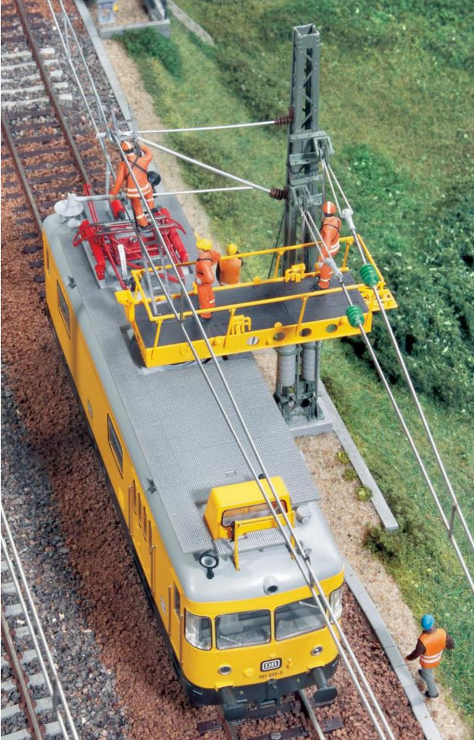
Das Märklin-Modell des Oberleitungsrevisionstriebwagens besitzt eine schwenkbare Arbeitsbühne.
