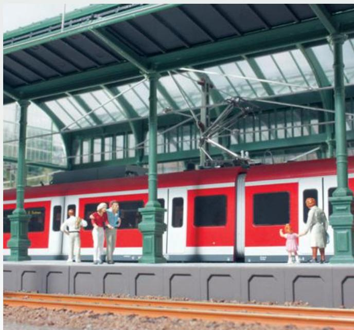
Unterhalb des Bahnsteighallendachs hängen einfache Fahrleitungen, gehalten von beidseitigen Auslegern und von Beiseilen getragen.
