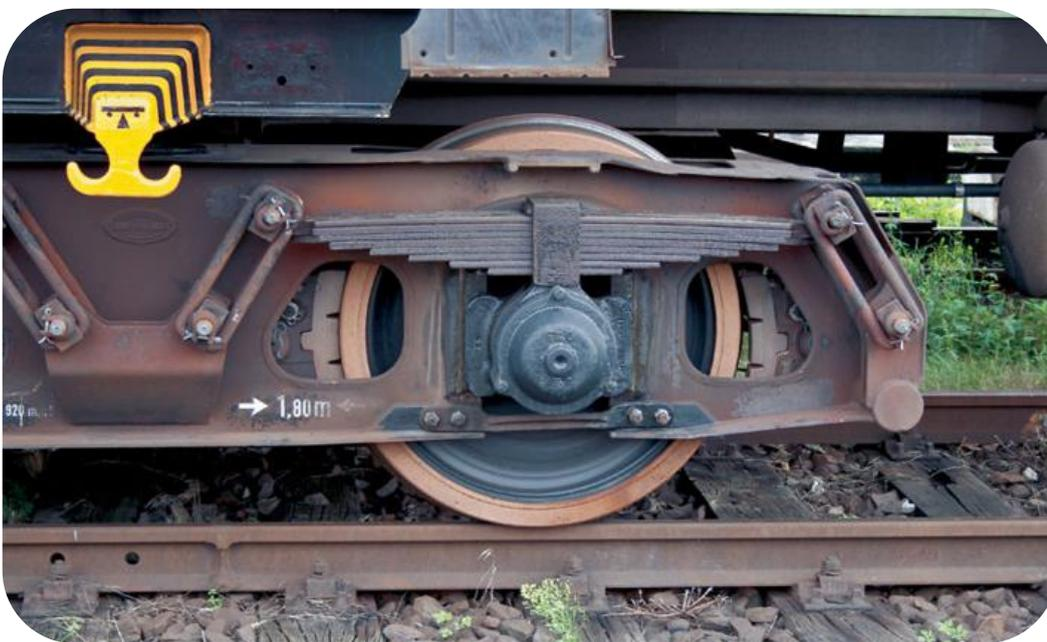
Ein gerade revidiertes Drehgestell mit neuen dicken Radreifen und frischen Bremssohlen.
