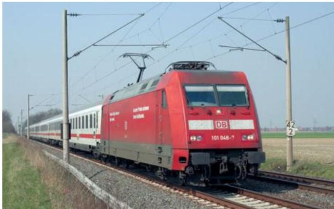
An diesen Stützen der Re 200 der Bauart 1950 erkennt man das 18 m weite am langen und das 14 m weite Beiseil am kurzen Ausleger.
