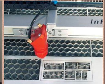
Rasend schnell schneidet der Laser die Bauteile aus dem Zeichenkarton.
