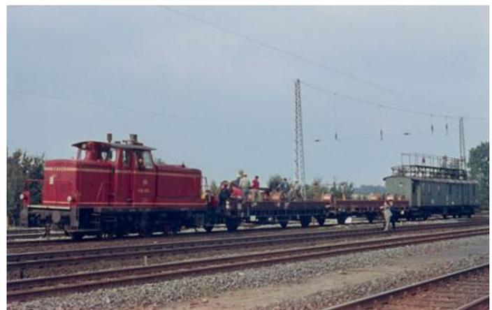
Ein Fahrleitungsmontagezug der 1960er-Jahre: V 60, Materialwagen mit Kabeltrommeln und umgebauter Packwagen mit Arbeitsbühne.
