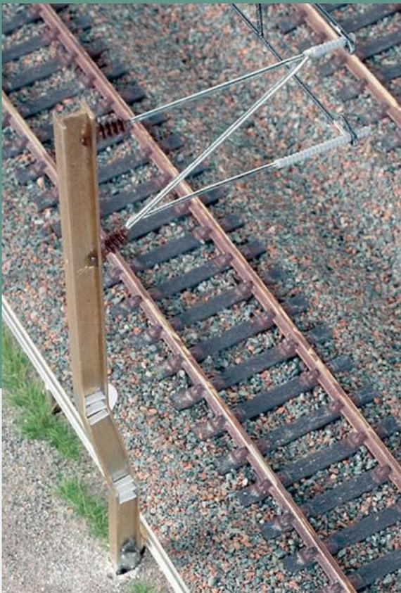
zur Gleismitte vorhanden, die zur Markierung der Maststandorte je nach gewünschten Abständen dienen. Dabei wird eine der beiden Lehren fixiert und die zweite mit dem Messdraht (Fahrdraht) so bewegt, dass sich die Abweichung des Fahrdrahtes von der Gleismitte innerhalb der Toleranzen befindet. An den Positionslehren sind dazu kleine Stifte vorhanden, an
