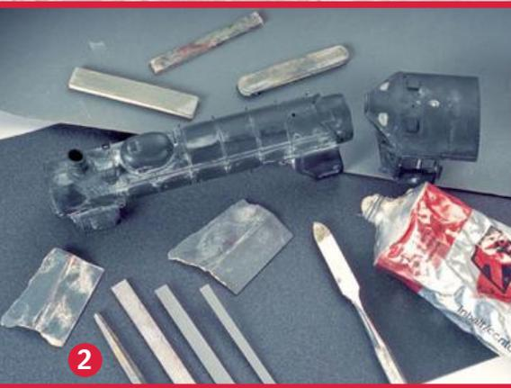
Diverse Einfallstellen auf dem Führerhausdach und am Kessel werden verspachtelt und verschliffen.
