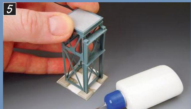
5 Das Montieren auf eine Platte sorgt für einen ebenmäßigen und vor allem senkrechten Stand des späteren Brückenbauwerkes.
