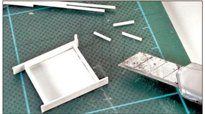
Die Fundamentverschalung bildet man mit dünnen Polystyrolstreifen und -platten nach.
