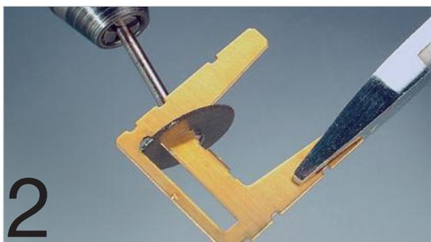
Zuerst wird mittels Trennschleifers der Quersteg entfernt. Achtung, dabei entsteht reichlich Wärme!
