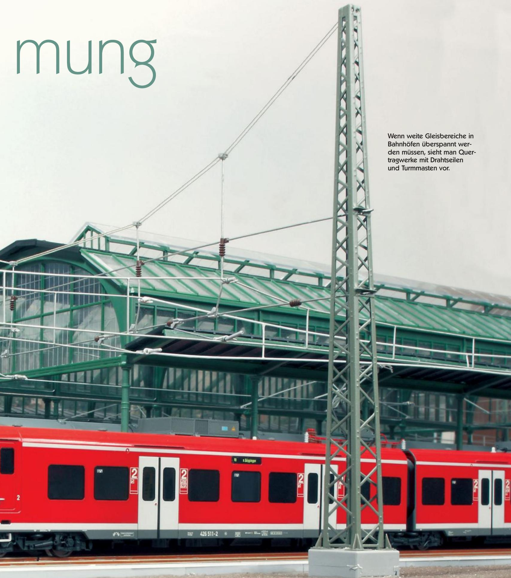
An die Geometrie der Fahrdrähtlage werden beim Vorbild teilweise größere Anforderungen gestellt als an die Gleislage. Der Stromabnehmer muss stets über den Fahrdraht eine sichere Stromaufnahme haben und kleinste Unebenheiten können dabei zu Kontaktunterbrechungen führen. Der enorme Aufwand, den man beim Vorbild betreiben muss, um alle Anforderungen zu erfüllen, macht sich in der Ausführung und der Gestaltung der Fahrleitungsanlagen bemerkbar.
