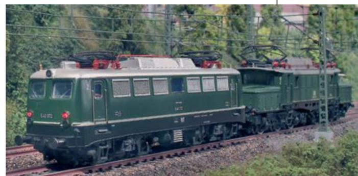
Bei Schleppfahrten bleiben die Pantographen unten.
