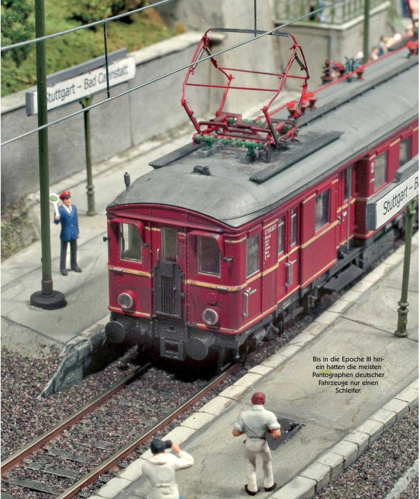
Bis in die Epoche III hinein hatten die meisten Pantographen deutscher Fahrzeuge nur einen Schleifer.
