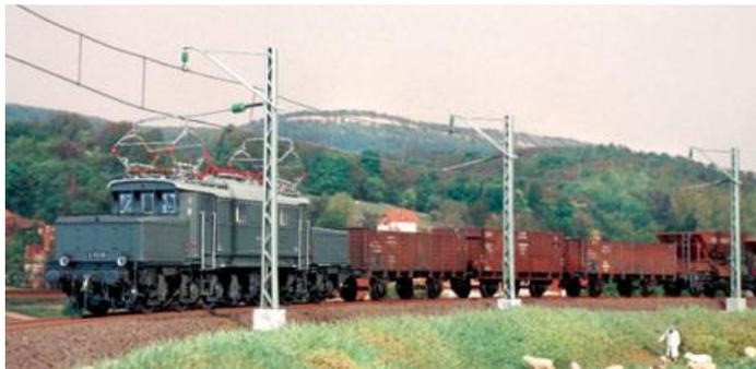
Die Bauart 1928 mit starren Auslegern im Maßstab 1:87. Der Fahrdrabt wurde wie anfangs noch üblich direkt am Seitenhalter befestigt.
