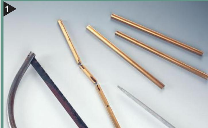
Aus stabilem Messing-H-Profil wird der gekrümmte Oberleitungsmast angefertigt. Eine Feile markiert die Schnittstellen.
