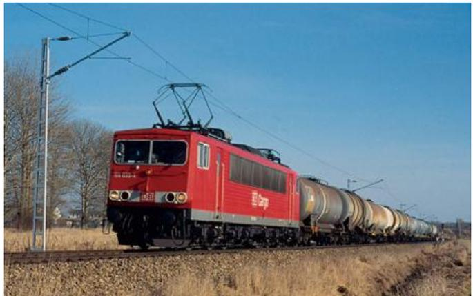
Bei der DR sah man bis zu Geschwindigkeiten von 80 km/h Einfachfahrleitungen vor. Die Bauart Ef 2 hat am Stützpunkt Beiseile.
