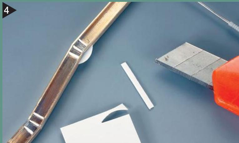
Die beim Vorbild angeschweißten Versteifungsbleche bildet man mit 0,3 mm dickem Polystyrol nach.
