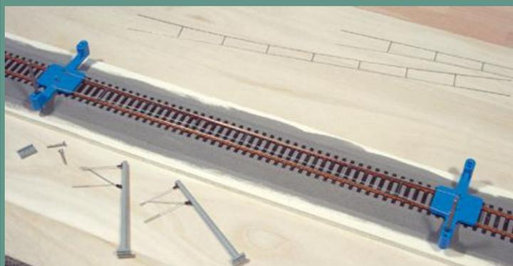
Mit Hilfe von Viessmanns Mastpositionierungslehre werden mittels der Fahrdrähte die Masten richtig positioniert.
