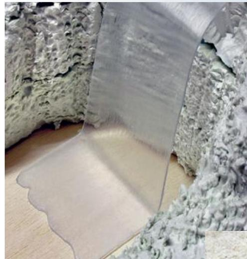
Der Wasserfall-Rohling aus einer Kunststoffolie wird genau an die landschaftliche Situation angepasst und gebogen.
