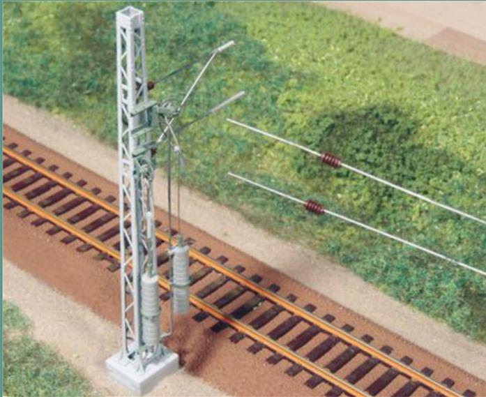
Bevor man Fahrdrabt und Tragseil an die Nachspanneinrichtung (Viessmann) montiert, müssen Isolatoren aufgeschoben werden.
