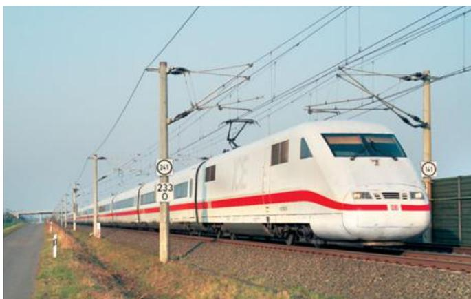
Die Komplexität der Re 250 für den Hochgeschwindigkeitsverkehr zeigt, dass hier höhere Kräfte aufgenommen werden müssen.
