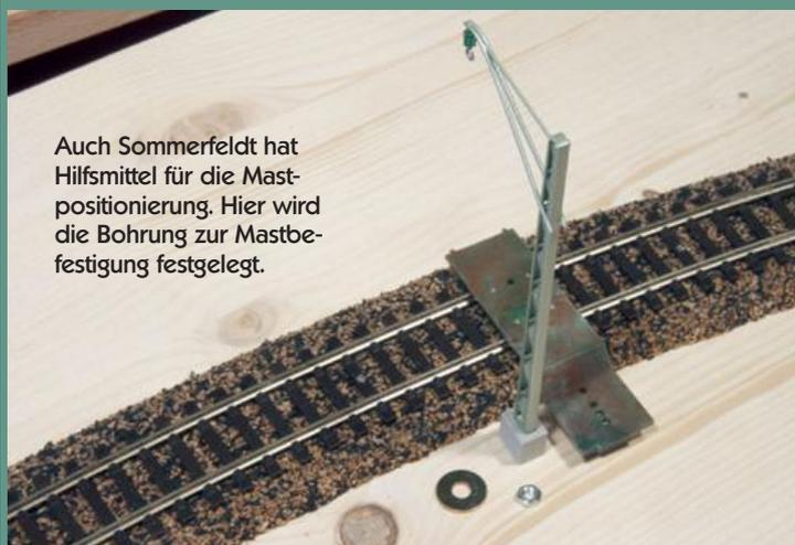
Auch Sommerfeldt hat Hilfsmittel für die Mastpositionierung. Hier wird die Bohrung zur Mastbefestigung festgelegt.
