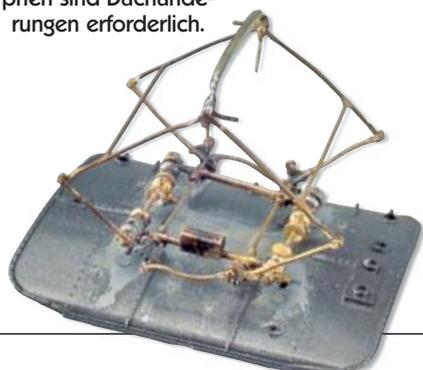
Der fertig montierte und lackierte Stromabnehmer optimiert den Gesamteindruck.
