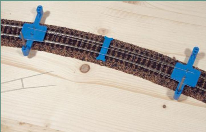
In Bögen kann man mit den einfachen Hilfsmitteln die maximale Seitenverschiebung des Fahrdrachtes überprüfen.
