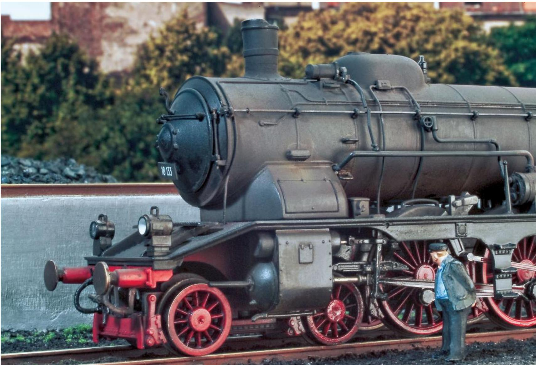
Rund um das erste Treibrad setzt sich bei Dampflok während des Fahrbetriebs ein Feuchtigkeitsfilm ab, im Modell mit Glanzlack imitiert.
