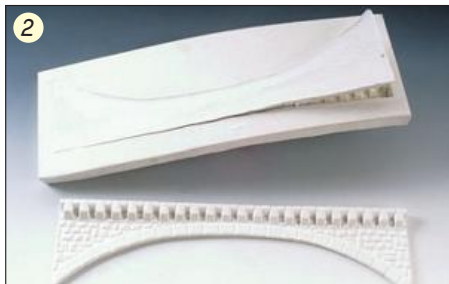
Durch eine Silikonform können beliebig viele Brückenteile erstellt werden.
