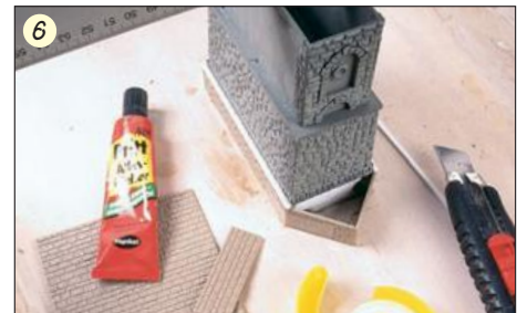
Der Flusspfeiler erhält einen selbstgebauten Vorfluter aus Polystyrolplatten.
