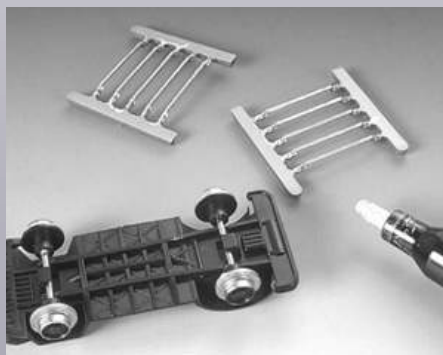
Laufflächen von Eisenbahnrädern und separate Griffstangen erhalten einen silbernen Anstrich.
