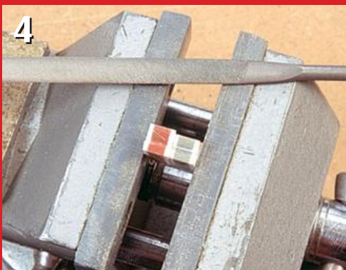
Um gleichmäßige seitliche Verjüngungen zu erreichen, werden beide Teile gleichzeitig befeilt.
