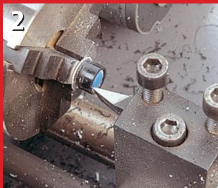
Das Überdrehen der Reifen auf einer Drehbank beseitigt die Spuren der Herkunft.
