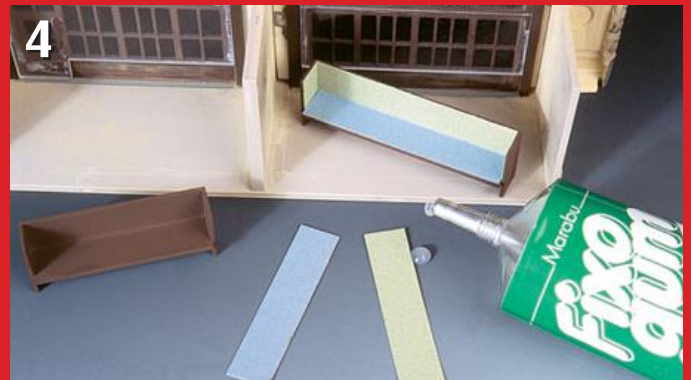
4 Aus Polystyrolstreifen entstehen Podeste und Schaukästen für die großen Schaufenster. Sie werden mit buntem Karton ausgelegt.
