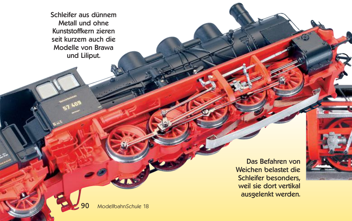
Märklins Flüsterschleifer (unten) streift auf M-Gleisen, daher der Tausch.
