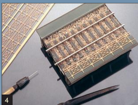
4 Die Aufnahmelöcher für Weinerts filigranes Brückengeländer bohrt man am einfachsten mit einem 0,5-mm-Handbohrer.
