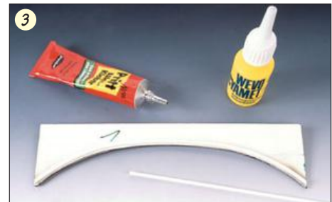
Auf den Innenbogen der neuen Wand setzt man eine Klebekante aus Polystyrol.
