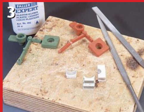
Geeignete Reste aus der Bastelkiste werden mit Polystyrol verkleidet und auf Radius befeilt.
