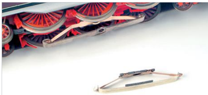
Märklins Flüsterschleifer (unten) streift auf M-Gleisen, daher der Tausch.
