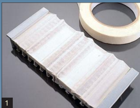
1 Mit selbstklebendem Kreppband werden die Gleise vorm Airbrush-Lackieren der Brücken sauber abgedeckt.
