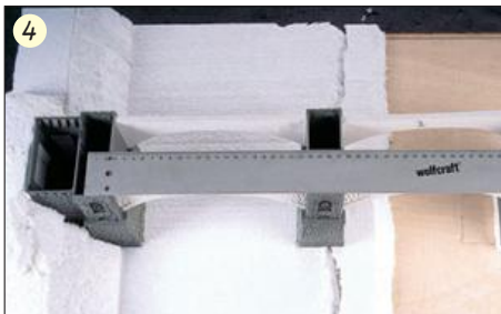
Die zu setzenden Brückenpfeiler und -köpfe richtet man mit einem Lineal aus.
