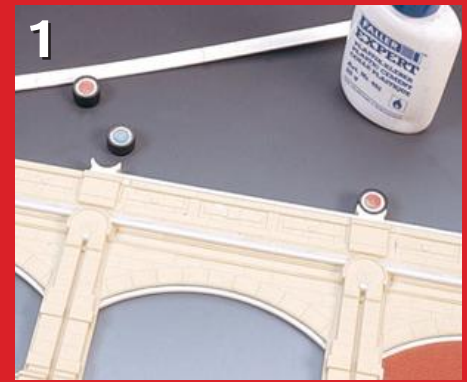
Die oberen Abdeckplatten der Brüstungsmauer entstehen aus geritzten Streifen.
