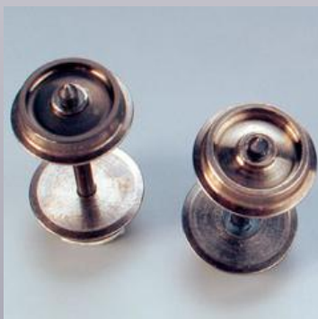
Mit speziellen, matt auf trocknenden Filzstiften lassen sich die Metallradsätze schwärzen.
