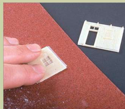
Bei Resinteilen werden Gusshäute durch rückseitiges Abschmirgeln entfernt.
