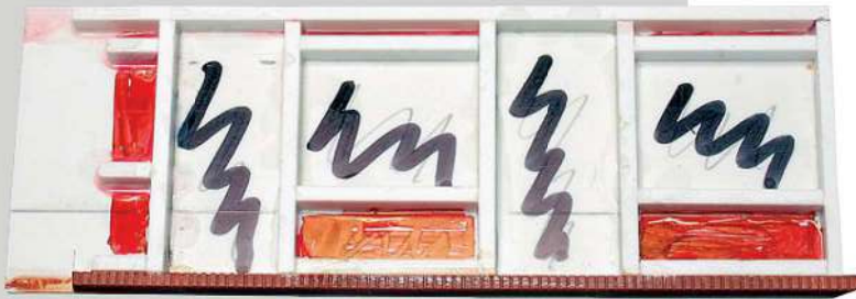
Die Basisplatte mit dem fertigen Fachwerk. Die schwarz markierten Stellen werden ausgeschnitten, die roten Felder ausgemauert.
