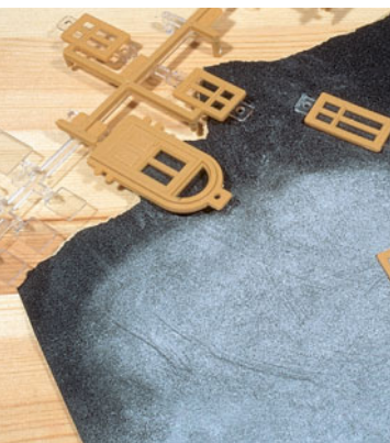
Die Scheiben der Kibri-Teile werden plangeschliffen.
