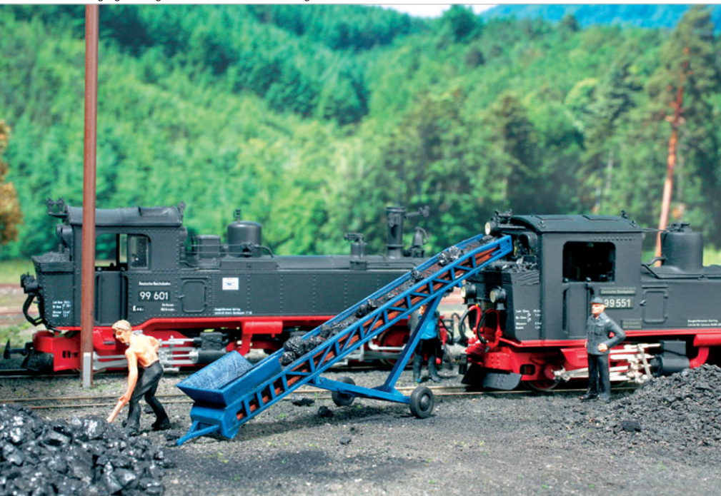
Bei der DR lässt ein Förderband die Kohle zielgerecht in den Kohlekasten fallen.
