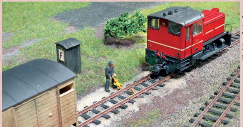
Die Gleissperre verhindert, dass der abgestellte Wagen auf die Strecke rollen kann. Sie wird von Hand geöffnet.
