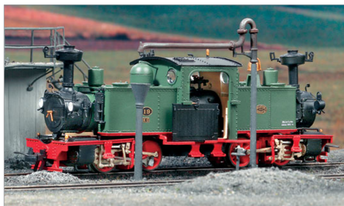
Zwei Kessel, eine Feuerbüchse und zwei Triebdrehgestelle wies die II K (alt) der Bauart Fairlie (BEMO-Modell) auf. Sie war extrem kurvengängig.
