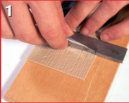
1 Mit einem Messer ritzt man die Kunststoffplatte an und trennt sie dann durch Brechen.
