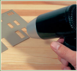
Geringe Wärme hilft beim Richten verzogener Teile.
