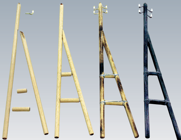
Die Schrittfolge vom Rohling zum fertigen Mast ist hier gut zu erkennen. Erst Feuer und später Einfärben sorgen fürs perfekte Äußere.
