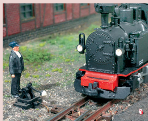
Das Umstellgewicht sächsischer Bauart presst die Zungen an und lässt die Weichenstellung erkennen.
