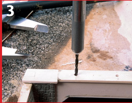
3 Die Bohrungen nehmen an dieser Stelle die Pfosten des obligatorischen Geländers auf.
