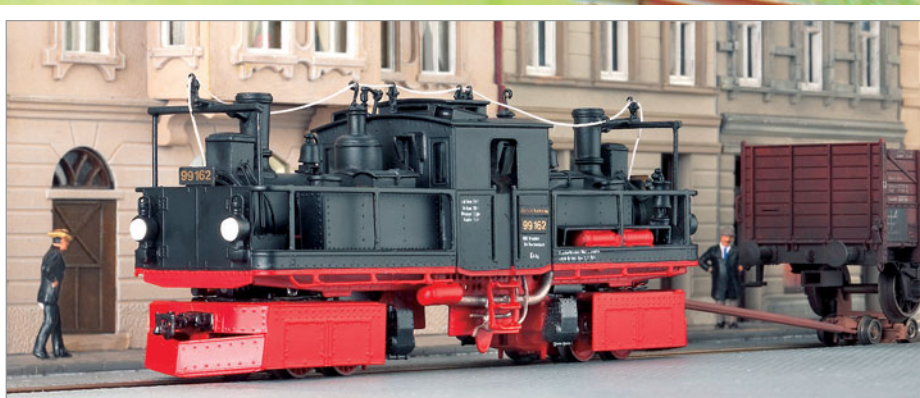
1902 wurden meterspurige englische Fairlie-Loks mit Triebwerkverkleidung nachgebaut (Westmodel-Modell).
