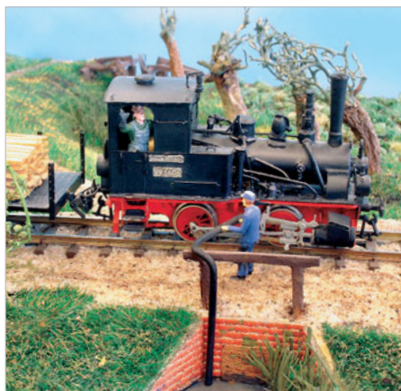
Der an der Lok befestigte Pulsometer pumpt Wasser aus einem Bach in die Lok.
