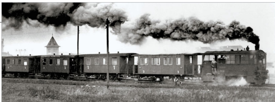
Die Bahn Neustadt – Speyer lag teilweise im Straßenplanum. 99087 zeigt die typische Trambahnlokbauart.
