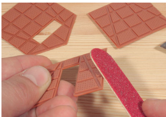
Trennkanten der Einzelteile glättet man am besten mit einer Bastelfeile. Dabei ist auf Fasen zu achten.
