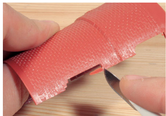
Sogenannte Schwimmhäute an Bausatzteilen entfernt man am schnellsten mit dem Skalpell.
