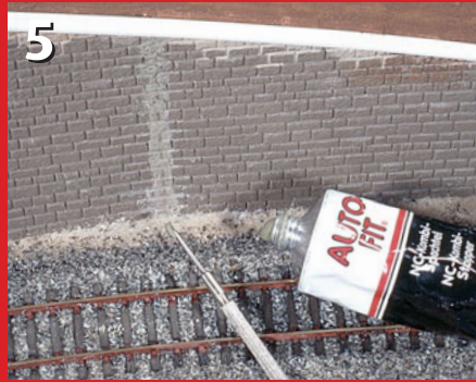
5 Die gespachtelten Trennkanten werden nach dem Trocknen nachgraviert.
