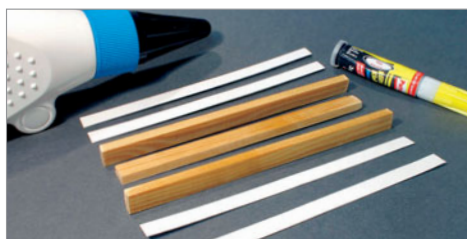
Stabile Holzleisten und aufgeklebte Pappstreifen ergeben die H-Träger der kleinen Brücke.
