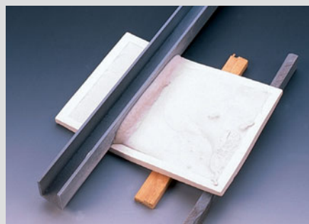
Den überschüssigen Gips entfernt man mit einer Leiste, die auch gleichzeitig glättet.
