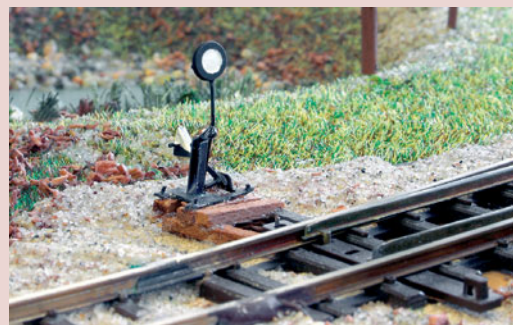
Weichensignal und Stellhebel nach Lenz-Normalien hatte unter anderen die Franzburger Kreisbahn.
