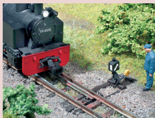
Das Weichensignal verdeutlicht, dass auch die Stellung des Umstellgewichts die Richtung anzeigt.
