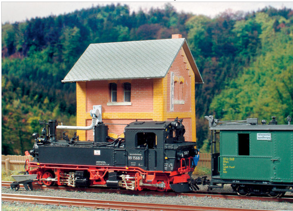
Dicht am Gleis stehende Wasserhäuser erhielten im 19. Jahrhundert oft einen Wandwasserkran.
