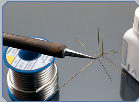
Hier entsteht die Krone einer Weißtanne aus verlötetem, gerichtetem 0,3-mm-Messingdraht.
