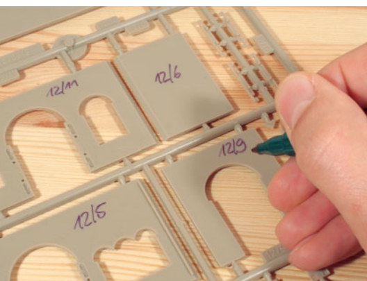
Nummerieren der Bauteile schützt bei großen Bausätzen vor Verwechslung.
