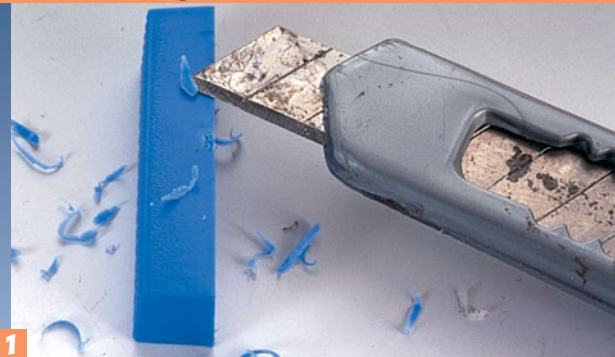
1 Vorhandene Spritzgrate werden mit einem Cuttermesser durch Abziehen mit aufgestellter Klinge beseitigt.
