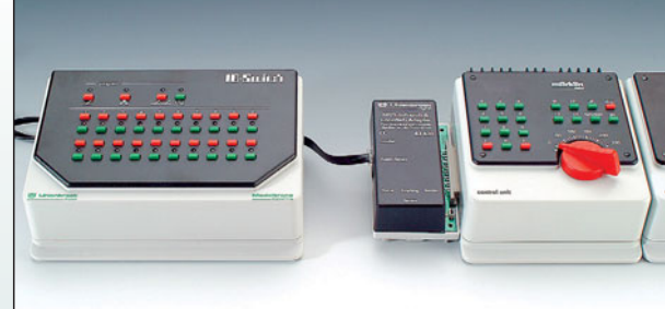
Der LocoNet-Adapter von Uhlenbrock eröffnet viele neue Möglichkeiten für Märklins 6021.
