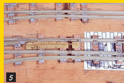
Der dünner gefeilte Zungenkasten wird unter die Zunge geschoben.
