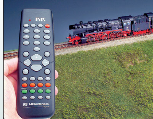
Iris nennt sich der drahtlose, mobile Infrarot-Fahrregler zur Intellibox und zu Märklins 6021.
