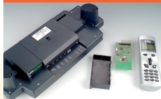
Das Empfängermodul für den Funkhandregler findet seinen Platz in einem separaten Fach.
