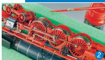
Die Innenseiten der Roco-Räder erhalten Rot.
