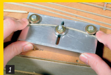
1 Das verstellbare Mittelteil der Biegelehre ermöglicht verschiedene Radien.
