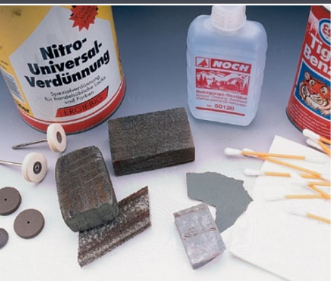
Zur Gleisreinigung empfehlen sich neben chemischen auch mechanische Mittel wie Schleifgummis oder -klötze.
