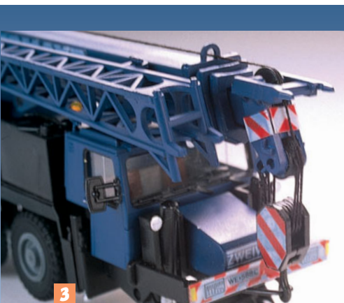
3 Im Fahrbetrieb sollte der Kranhaken stets eingehängt befestigt sein.
