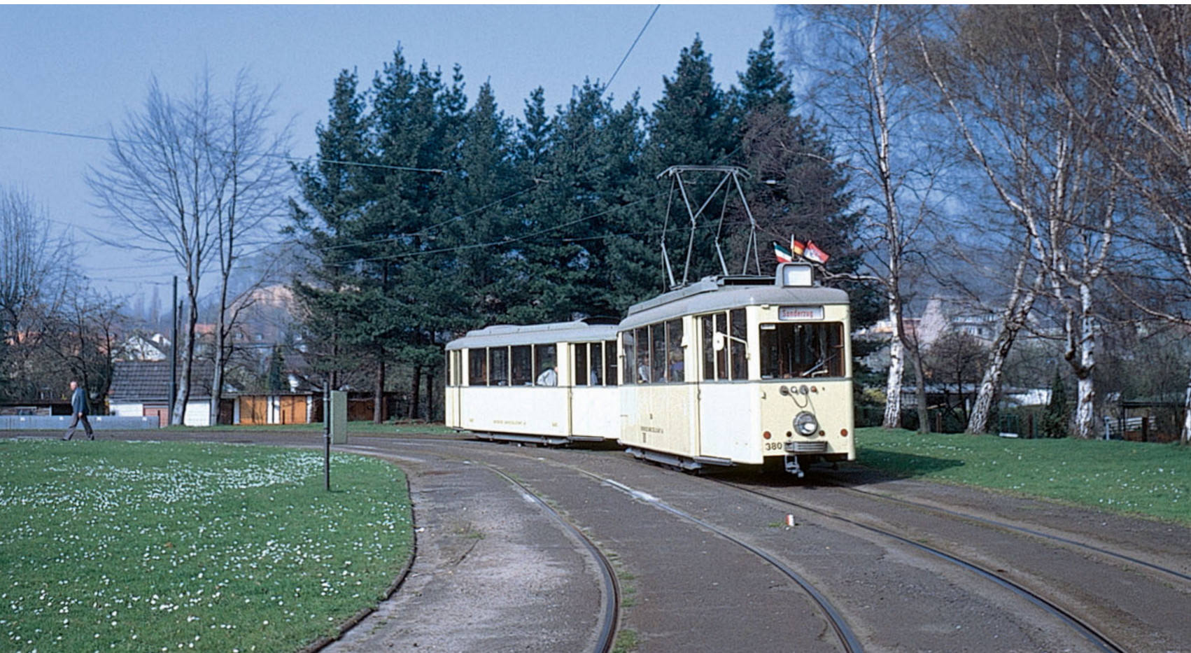
Straßenbahnschienen können, wie hier bei einem Düsseldorfer Endhaltepunkt, auch ohne Pflasterung in einer Teerschicht eingebettet sein.
