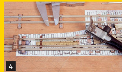
Der gerade Zungenkasten wird eingesägt und dem Gleisradius angepasst.
