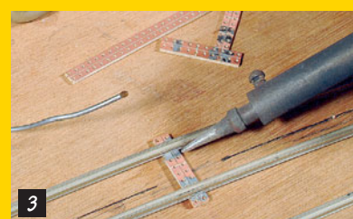
3 Pertinaxstreifen ermöglichen einen spurtreuen Abstand der Schienen.
