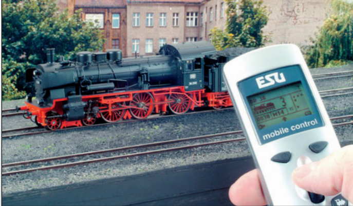
ESUs Funkhandregler steht firmenübergreifend für verschiedene Digitalsysteme zur Verfügung. Das Display erleichtert das Steuern.
