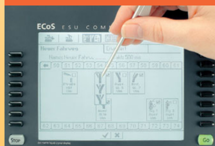
Bei mehrbegriffigen Verbrauchern wird ein Untermenü geöffnet.
