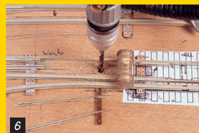
3 mm breit ist das Langloch für den Stelldraht des Unterflurantriebs.
