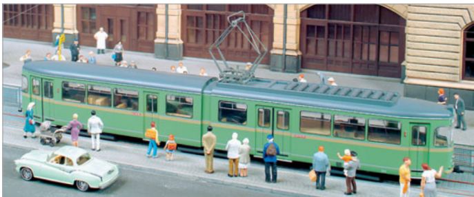
Der 6xGTW von DÜWAG ist eine komplette Neukonstruktion eines Zwei-Richtungs-Gelenktriebwagens mit drei Drehgestellen (Lima-Modell).
