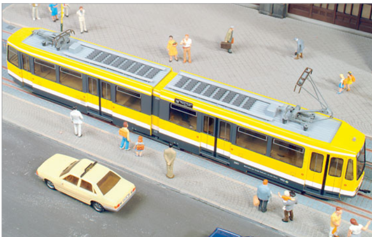
Auch Meterspurbetriebe beschafften Stadtbahnwagen (Lima-Modell). Er wird auch als Straßenbahn eingesetzt, die Trittstufen sind abklappbar.
