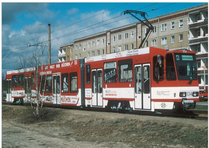
Der Straußberger KT8D5 entstand aus zwei gebrauchten Tatra-Großraumwagen und erhielt ein schwebendes Niederflurmittelteil.
