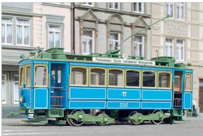
Diese Münchner Tram (Adler-Modell) erhielt als Vierachser der Kurven wegen ein Maximum-Drehgestell mit unterschiedlichen Rädern.
