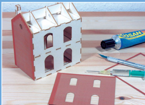
4 Den Grundkörper verkleidet gelaserte Mauerdekor. Den mit Aceton verdünnten Alleskleber dosiert man mit einer Spritze.
