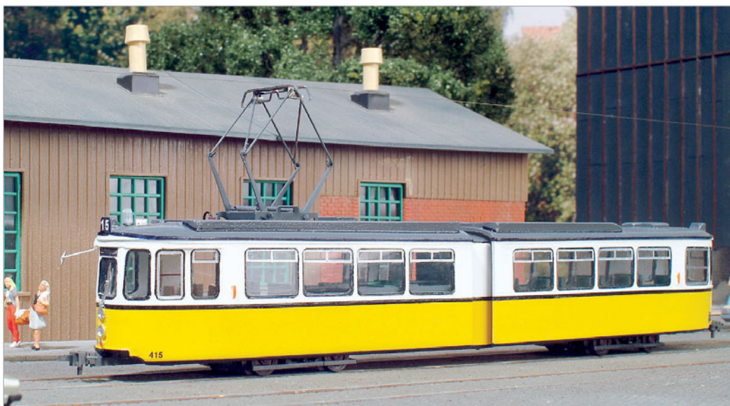
Der Aufbau des Gelenktriebwagens GT4 von 1961 (MALU-Tram-Modell) ruht auf zwei Drehgestellen.
