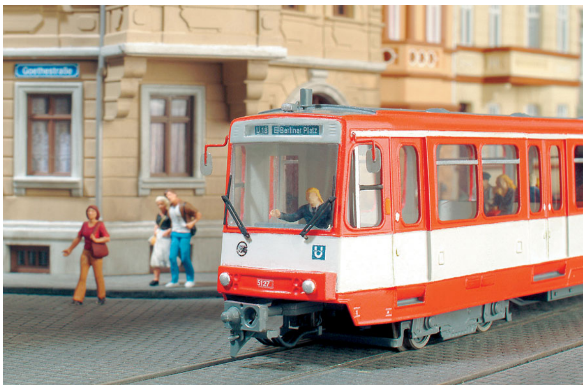
Charakteristisch für den B 80 C sind die großzügige Frontscheibe sowie die vorstehende Profileinheit.
