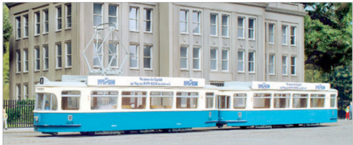
Der Münchner M4.65 (Tramalan-Modell) hat keine Drehgestelle, jeder Wagen läuft auf drei Achsen. Die mittleren sind Lenkachsen.
