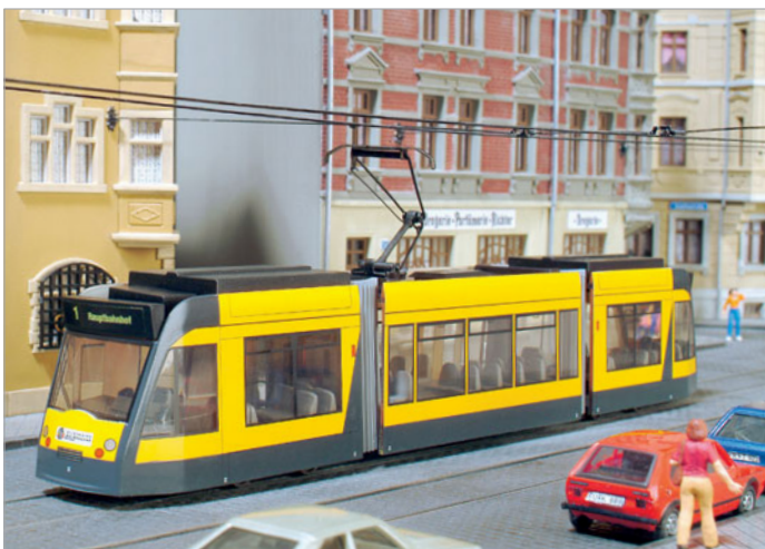
In Nordhausen verkehrt der Combino (Hödl) nur dreiteilig. Das Baukastensystem des Fahrzeugs lässt verschiedene Kombinationen zu.
