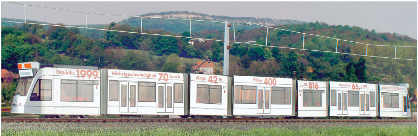
Beim Freiburger Combino (Hödl) sind die Einstiegsbereiche schwebend und somit sehr niedrig gehalten. Er wird als Straßenbahn eingesetzt
