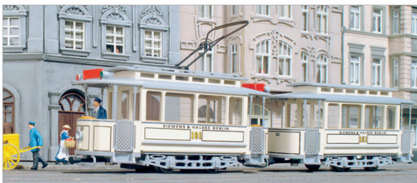
Ab 1900 beginnt der Betrieb mit Beiwagen (Hamann-Modell). Der Motorwagen von Siemens ist mit einem Lyra-Bügel ausgestattet.
