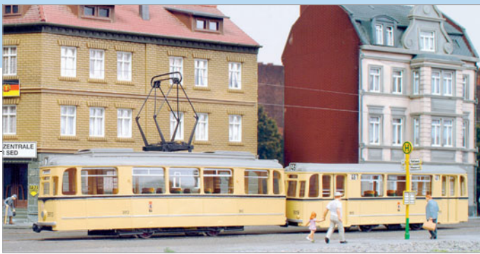
Der ab 1957 im Gotha gebaute Einheitswagen ET 57 mit Beiwagen (Fröwis-Modell) war eine modifizierte Verbandswagen-Konstruktion.
