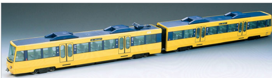
Der Stuttgarter Stadtbahnwagen besteht aus zwei kurzgekuppelten Triebwagen mit Faltenbalgübergang (Halling-Modell).
