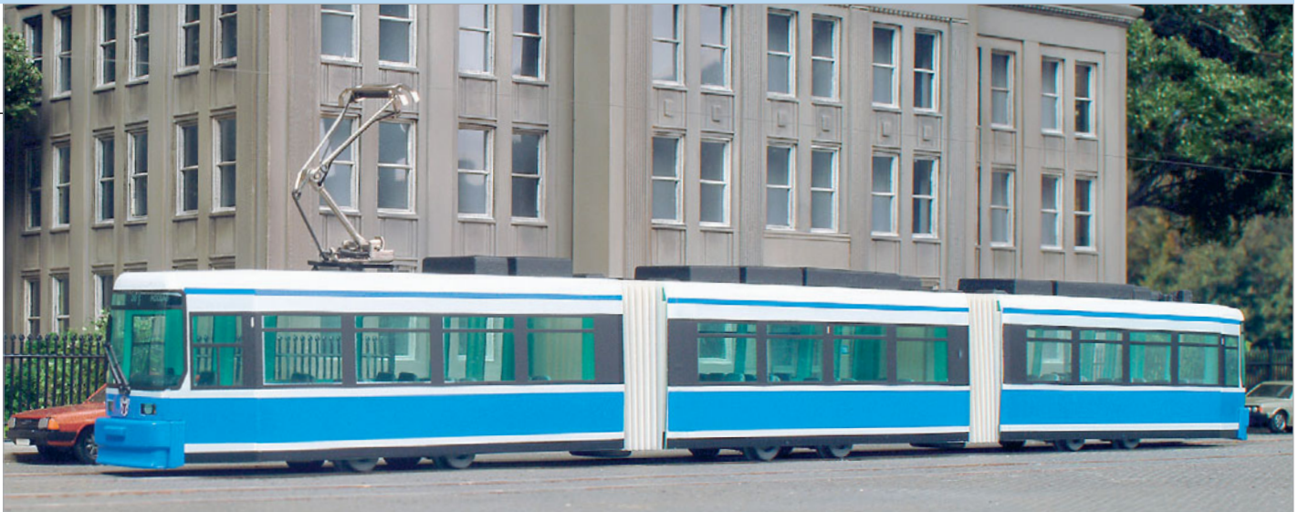
In München hat man sich Ende der 1980er-Jahre für Niederflurwagen (Hödl-Modell) mit möglichst ebenerdigen Einstiegen entschieden.
