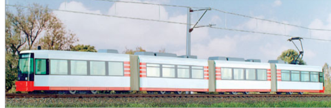
In Bremen läuft jeder Wagen der vierteiligen Ein-Richtungs-Straßenbahn (Hödl) auf zwei Achsen.
