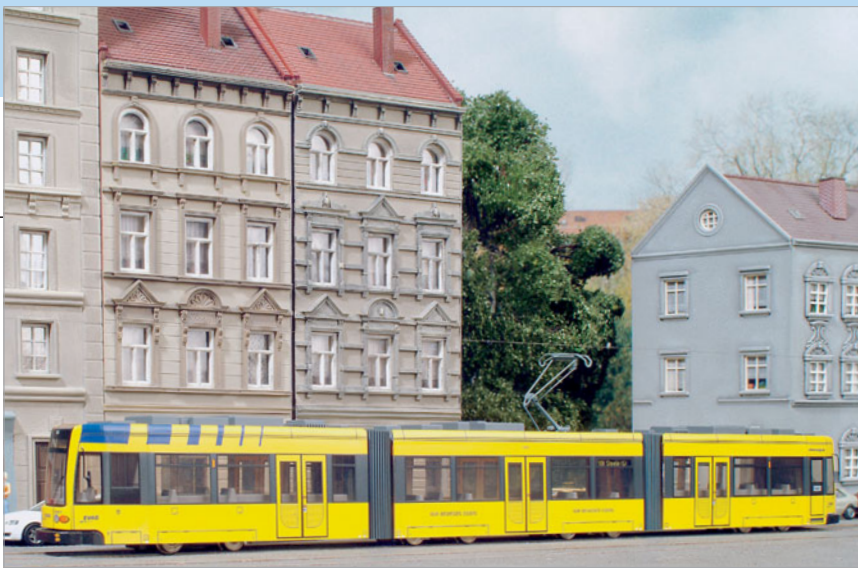
Der Essener Zwei-Richtungs-Gelenkniederflurwagen MGT8 (Halling, Modell ist für Normalspur ausgelegt) hat beidseitig Türen für schnelleres Aus- und Einsteigen.
