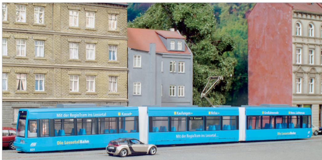
Der 8NGTW (KVG Kassel) fährt als Ein-Richtungs-Niederflurstraßenbahn auch auf früheren Eisenbahnstrecken.
