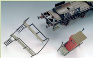
Holzlaufstege erhalten eine Maserung und das Kunststoffgelenk der kann man dünner schaben.
