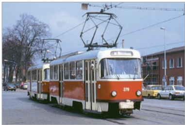
Ab 1968 baute ČKD den Tatra-Großraumwagen mit Merkmalen der in den USA ab 1929 konstruierten PCC-Fahrzeuge in Lizenz.
