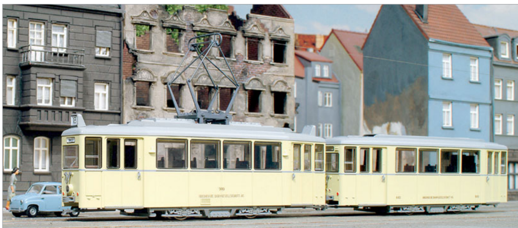
DÜWAG setzte ab 1950 auf alte Vorkriegs-Fahrgestelle neue Aufbauten mit zeitgemäßer Innenausstattung.
