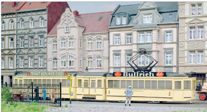
Ab 1926 gab es erste praktische Versuche mit Motor- und Beiwagen verbindenden Gelenkwagen, hier 1928 in Berlin (Fröwis-Modell).
