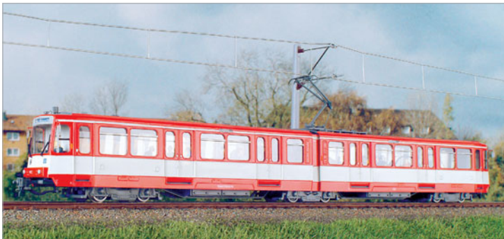
Die Stadtbahnwagen (Swedtram-Modell) wurden für den Tunnelbetrieb im Rhein-Ruhrgebiet ab 1976 entwickelt. Sie haben auch eigene Gleiskörper.
