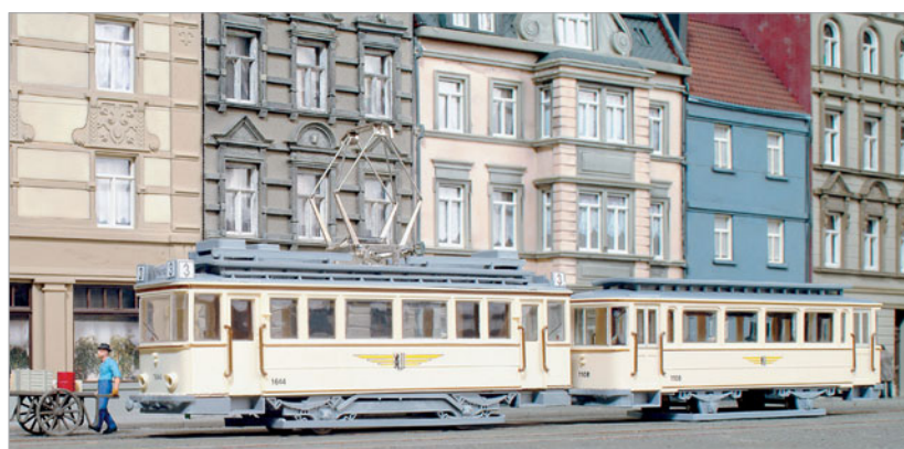
Stahl ersetzt die Aufbauten aus Holz. Der 1926 gebaute Zug (Beka-Modelle) hat Scherenstromabnehmer und beidseitig Einstiege.
