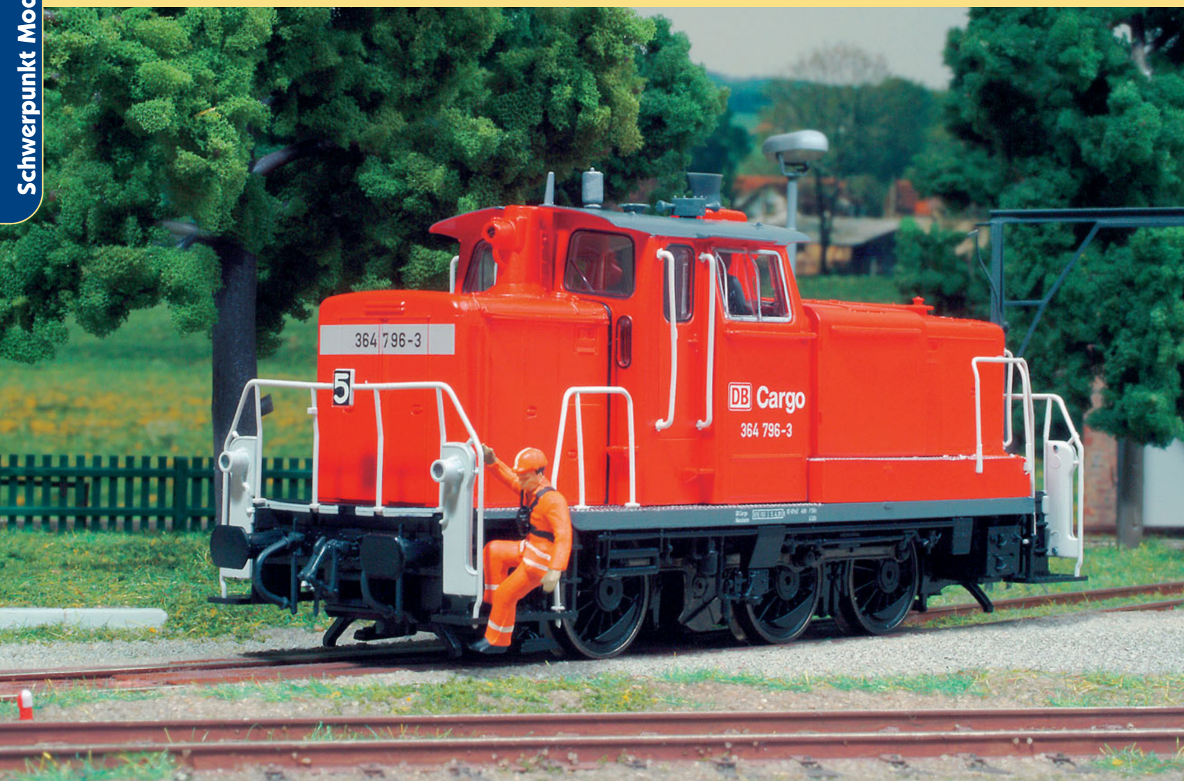
Moderne Bahn: Statt je eines Lokführers und Rangierers ist heute der Rangierlokführer mit Fernsteuerung im Einsatz.
