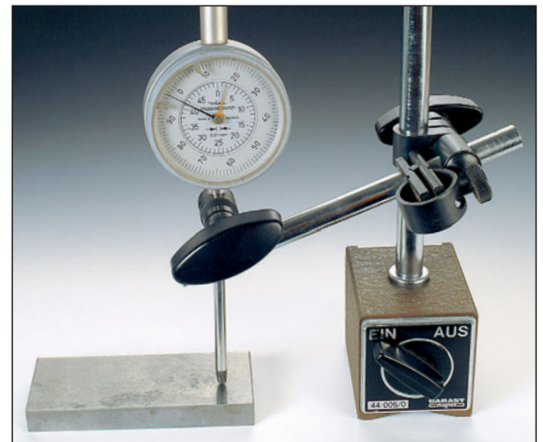
Durch Messuhren mit Federtaster kann man Werkstücke auf Maßhaltigkeit direkt an der Fräsmaschine überprüfen.
