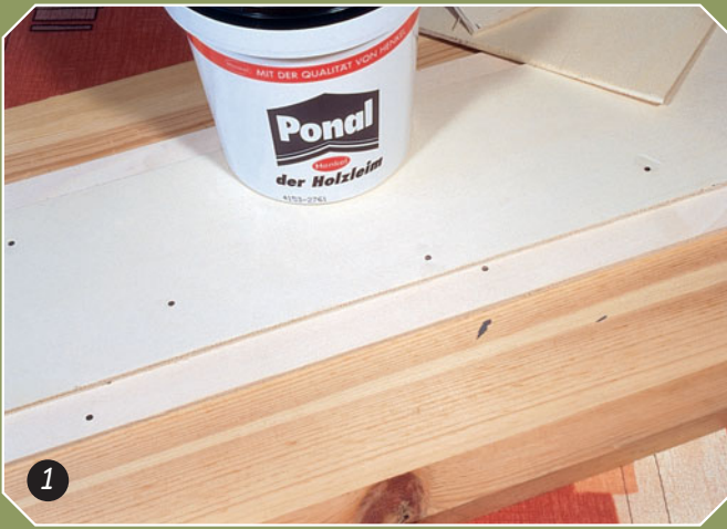
1 Holz Bretter dienen als Unterbau für die feste Fahrbahn. Sie werden auf die Anlagengrundplatte aufgebracht.
