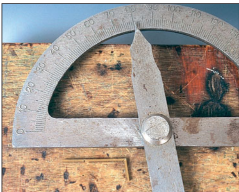
An der Anschlagkante des Winkelmessers lässt sich das abgekantete Messingprofil vor dem Verlöten im richtigen Winkel ausrichten.
