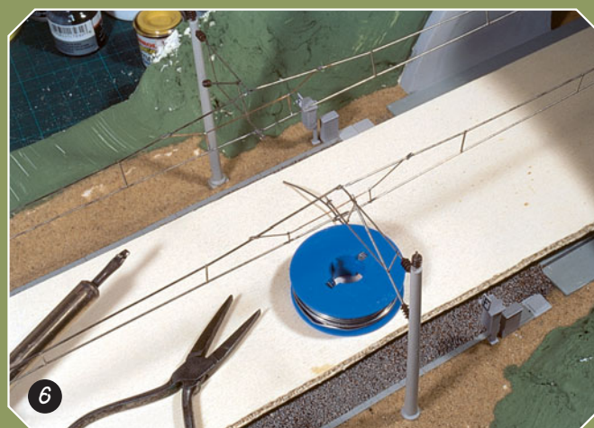
6 Während des Lötens der Fahrleitung sollte man die Fahrbahn mit einem Holzbrett abdecken und so unschöne Flecken durch heruntertropfendes Lötzinn vermeiden.
