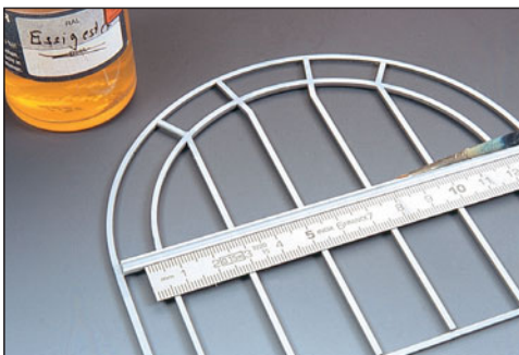
Bei der exakten Verklebung dünner Polystyrolstreifen hilft ein Stahllineal.
