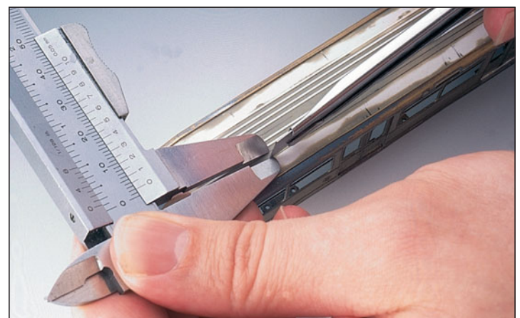
Mit einem am Messschenkel entlang geführten Bastelmesser lassen sich sehr genau parallele Maße auf das Modell übertragen.
