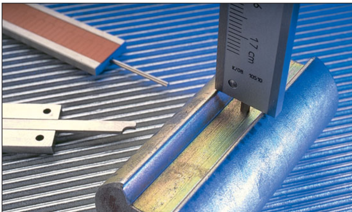
Mit dem Stab für Tiefenmessungen lassen sich die Maße von Sacklöchern, Nuten oder Absätzen direkt am Werkstück ermitteln.
