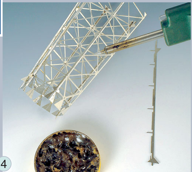
4 An den Außenkanten wird ein Profil aufgesetzt. Zuerst fixiert man es an einzelnen Punkten, dann zieht man eine Lötnaht.
