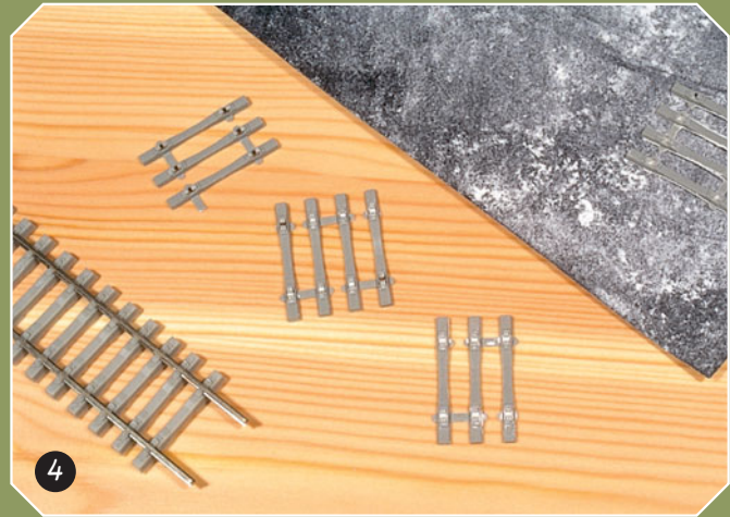
4 Auf Schleifpapier werden herkömmliche Roco-Betonschwellen auf etwa einen Millimeter Schwellenhöhe heruntergeschliffen.
