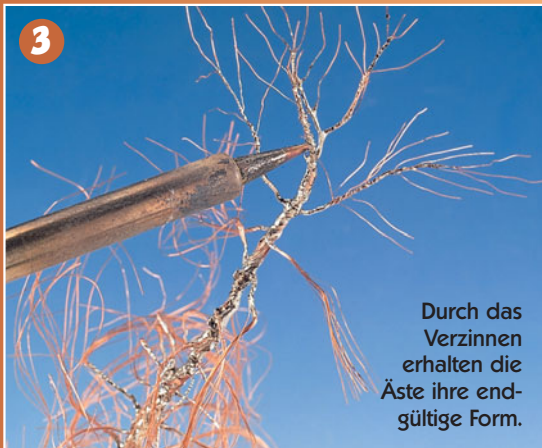
4 Der Überzug aus Weißbleim sorgt dafür, dass das Modell seinem Vorbild immer ähnlicher wird.
