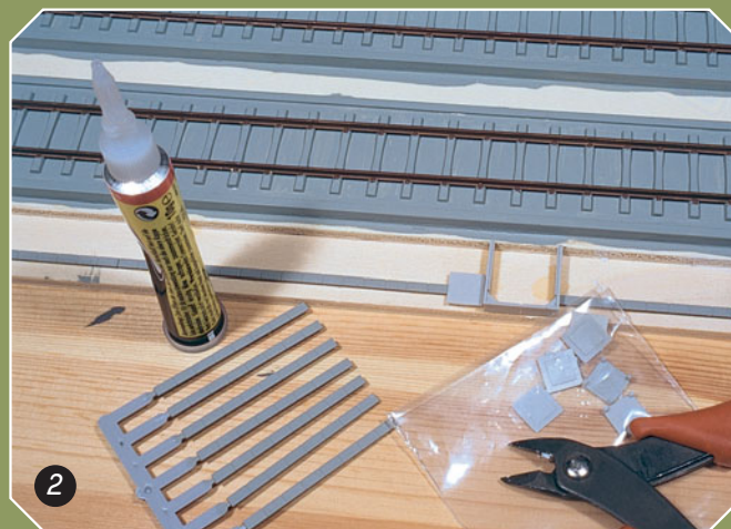
2 Auch Kabelschächte und andere Zubehörteile, die später in die Landschaftsgestaltung integriert werden müssen, werden zuvor eingebaut.
