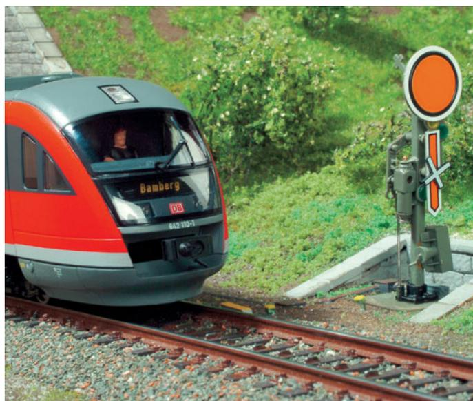
Mit Hilfe von weißen Kreuzen werden Signale ungültig gemacht. Sie sind entweder noch nicht in Betrieb oder überflüssig geworden.
