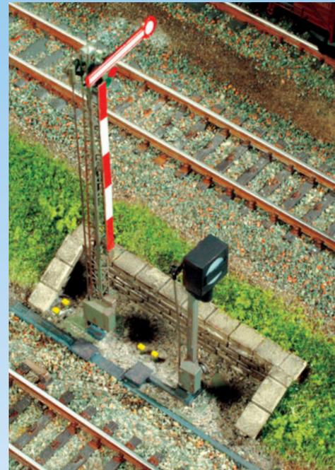
Der Signalanschluss an durchgehende Leitungen erfordert oft mehrere Umlenk-kästen.
