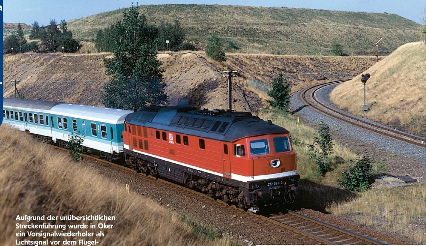
Aufgrund der unübersichtlichen Streckenführung wurde in Oker ein Vorsignalwiederholer als Lichtsignal vor dem Flügel-Hauptsignal aufgestellt.
